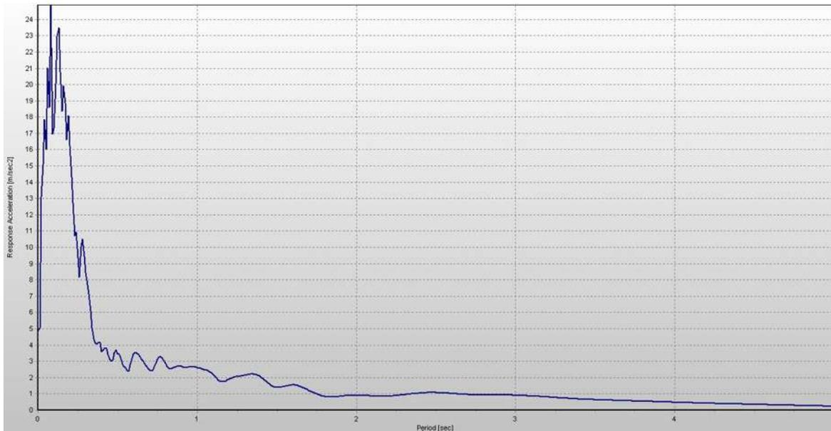
Figura 33 Espectro de respuesta de pseudo- aceleración obtenido con el programa SeismoSignal, 2018.
