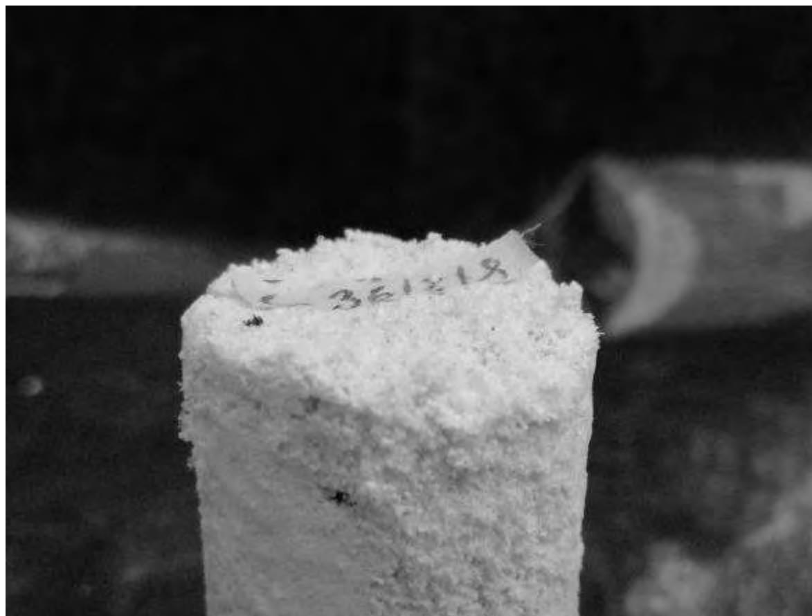
Figura. 4. 668. Imágenes de la corrida C-361218, con presencia de eflorescencias en su parte externa. (autoría propia).
