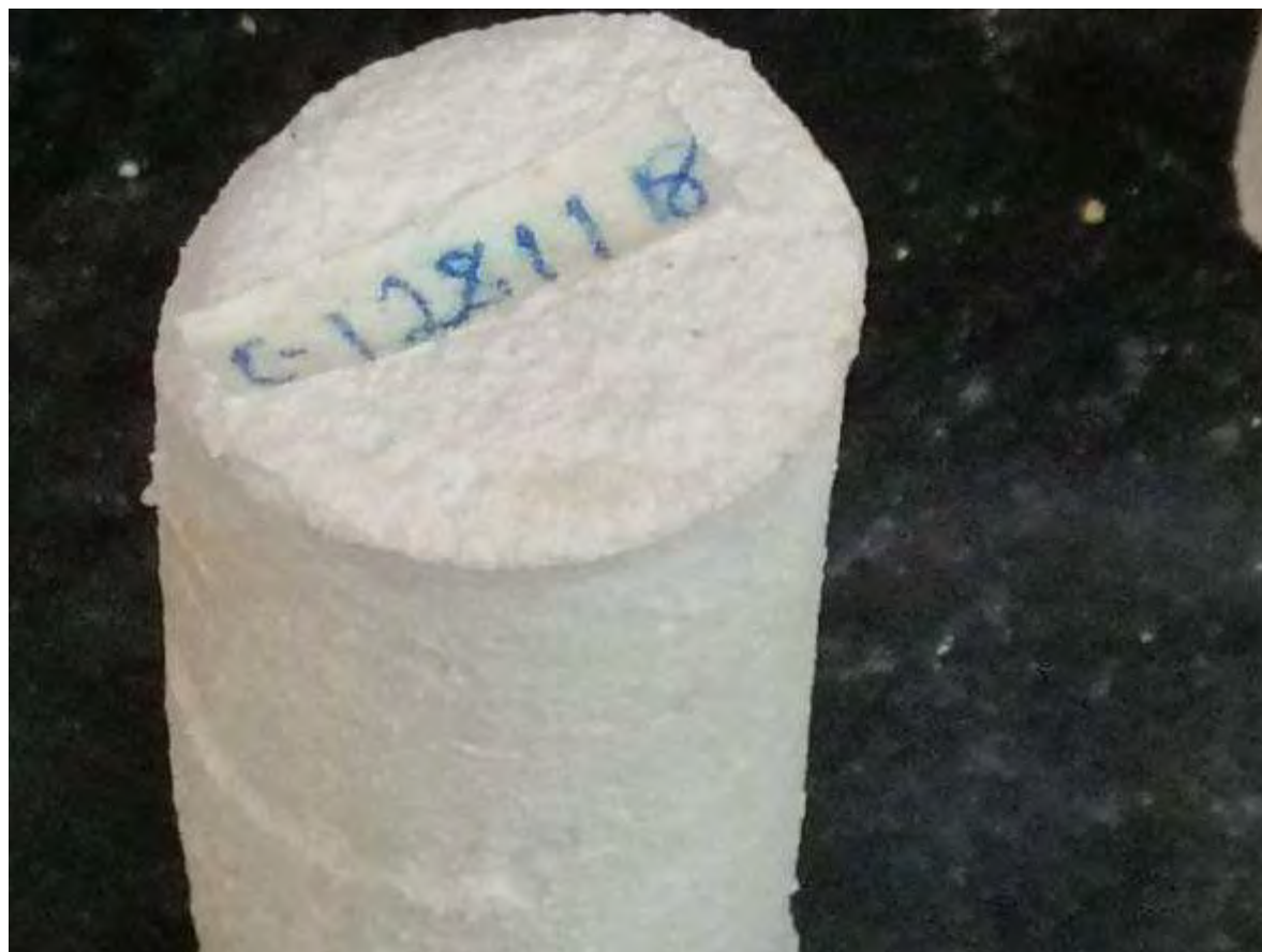
Figura. 4. 529. Imágenes de la corrida C-1281118, con presencia de eflorescencias en su parte externa. (autoría propia).
