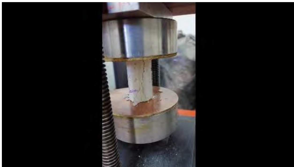
Figura. 4. 840. Fotografía, mostrando la falla en la probeta representativa de la C-130119. Fuente: (autoría propia).
