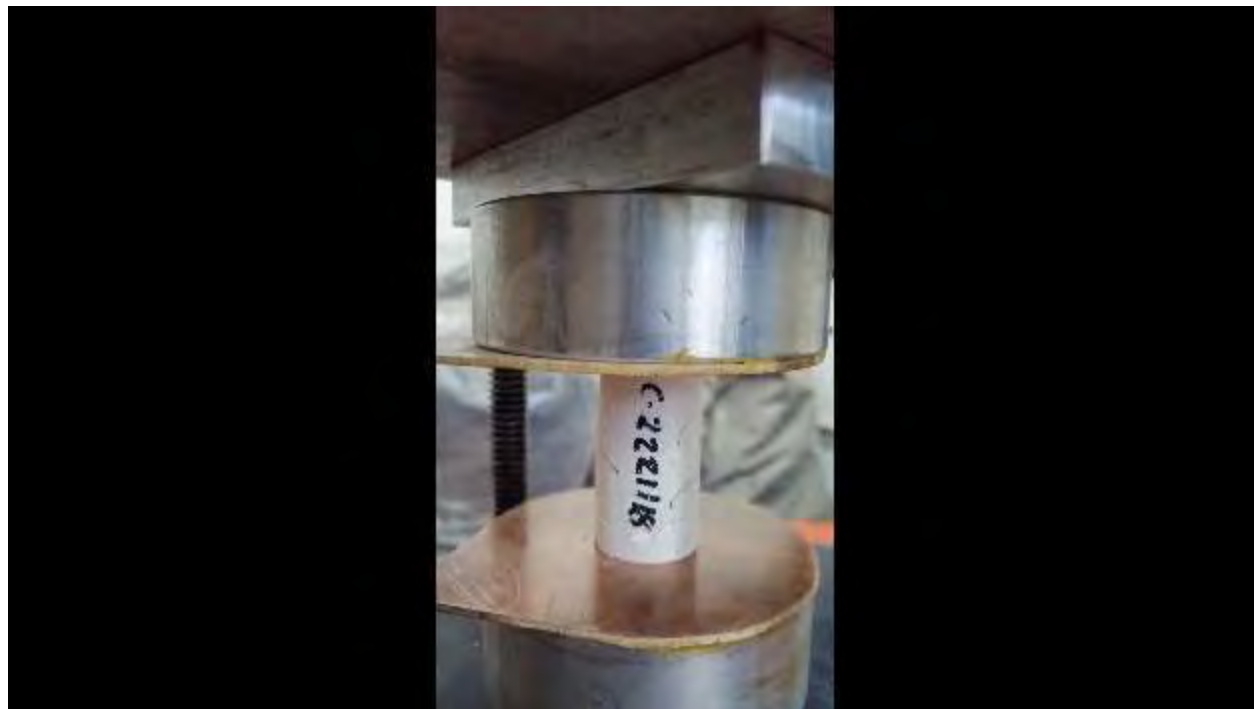
Figura. 4. 459. Fotografía de la C-222118, en la prensa. Fuente: (autoría propia).
