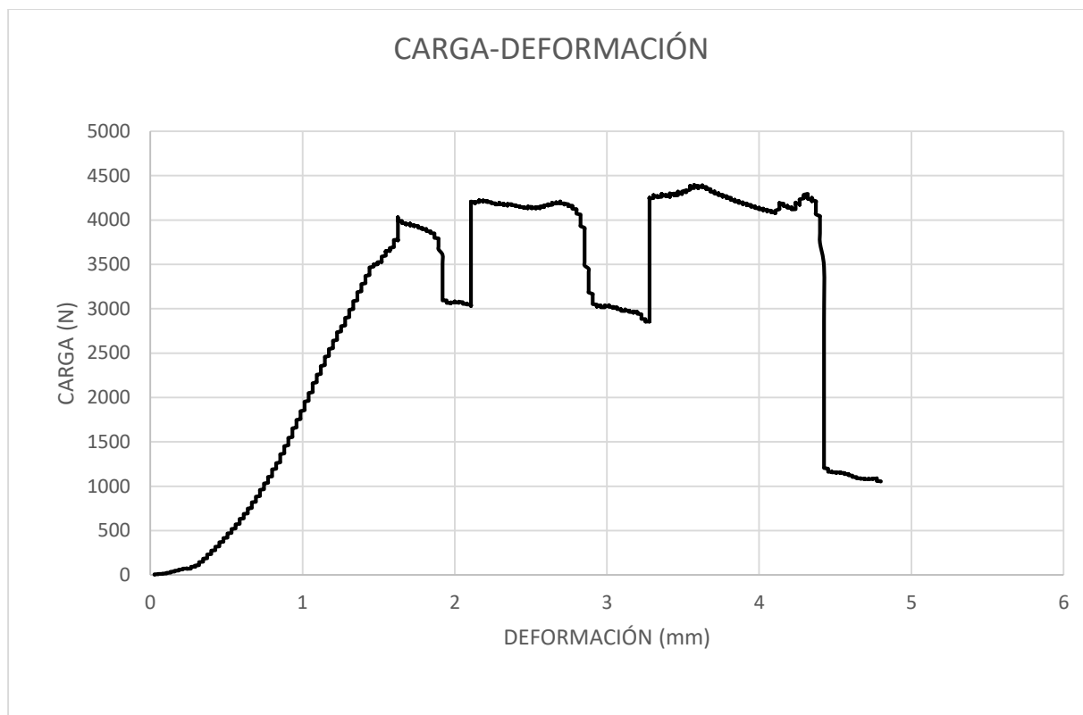
Gráficas 4. 42. Curva Carga-Deformación de la C-1281118, en N-mm. Fuente: (autoría propia).
