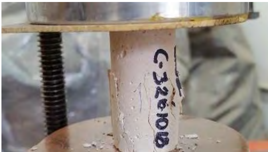
Figura. 4. 80. Fotografía, mostrando la falla en la probeta representativa de la C-326101818. Fuente: (autoría propia).
