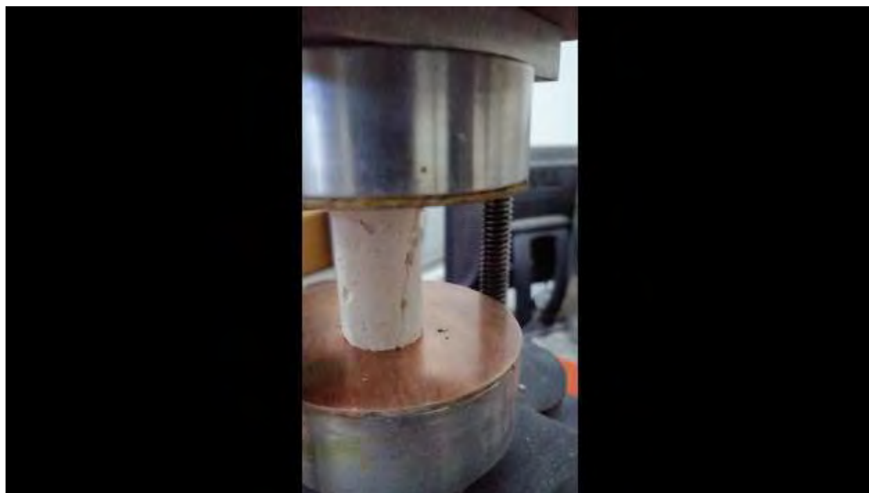
Figura. 4. 886. Fotografía, mostrando la falla en la probeta representativa de la C-150119. Fuente: (autoría propia).
