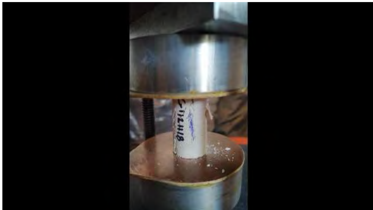
Figura. 4. 305. Fotografía, mostrando la falla en la probeta representativa de la C-1121118. Fuente: (autoría propia).
