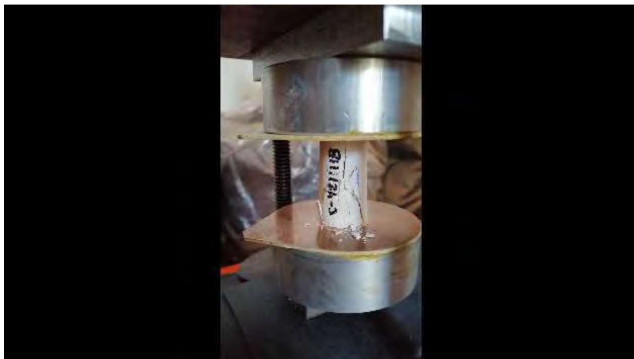
Figura. 4. 434. Fotografía, mostrando la falla en la probeta representativa de la C-4211118. Fuente: (autoría propia).
