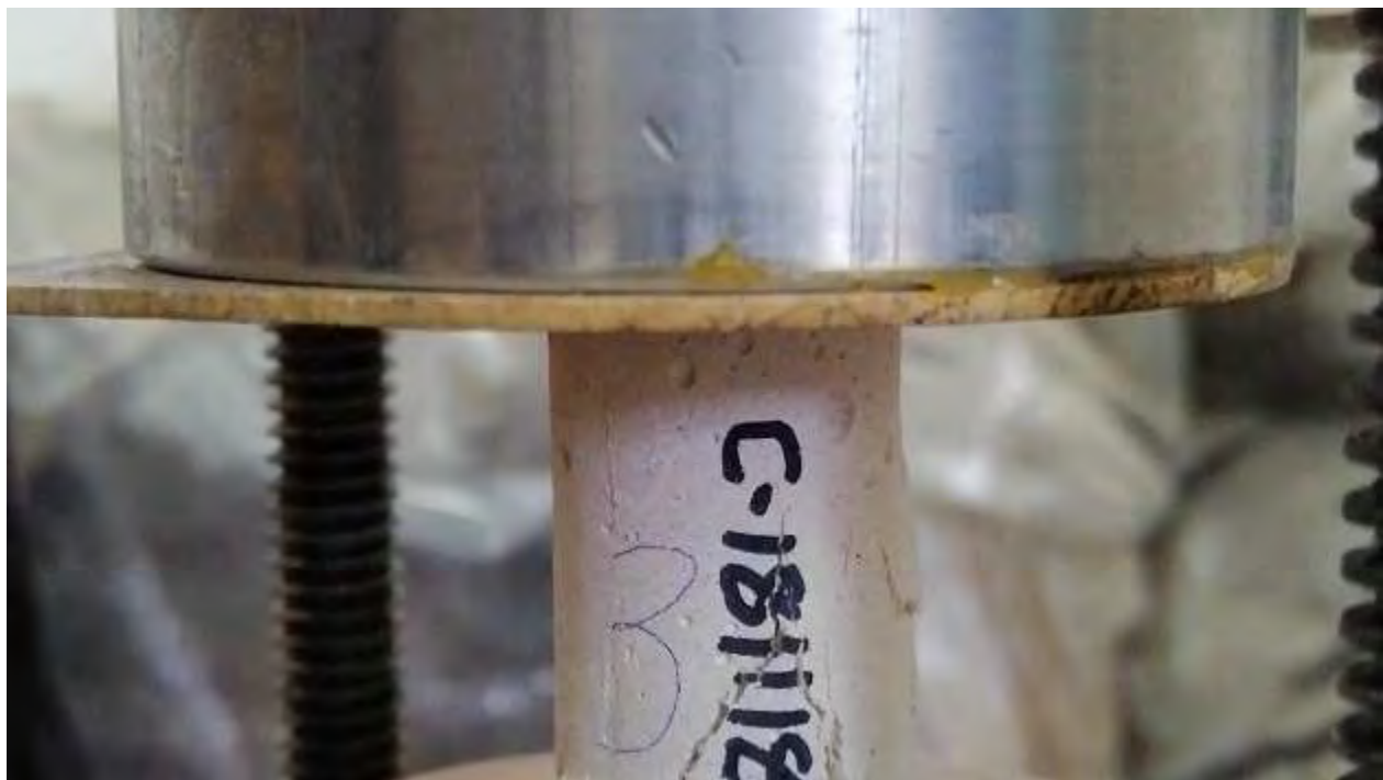
Figura. 4. 175. Fotografía, mostrando la falla en la probeta representativa de la C-181118. Fuente: (autoría propia).
