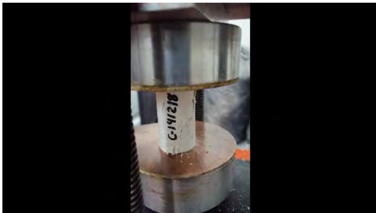
Figura. 4. 625. Fotografía, mostrando la falla en la probeta representativa de la C-141218. Fuente: (autoría propia).
