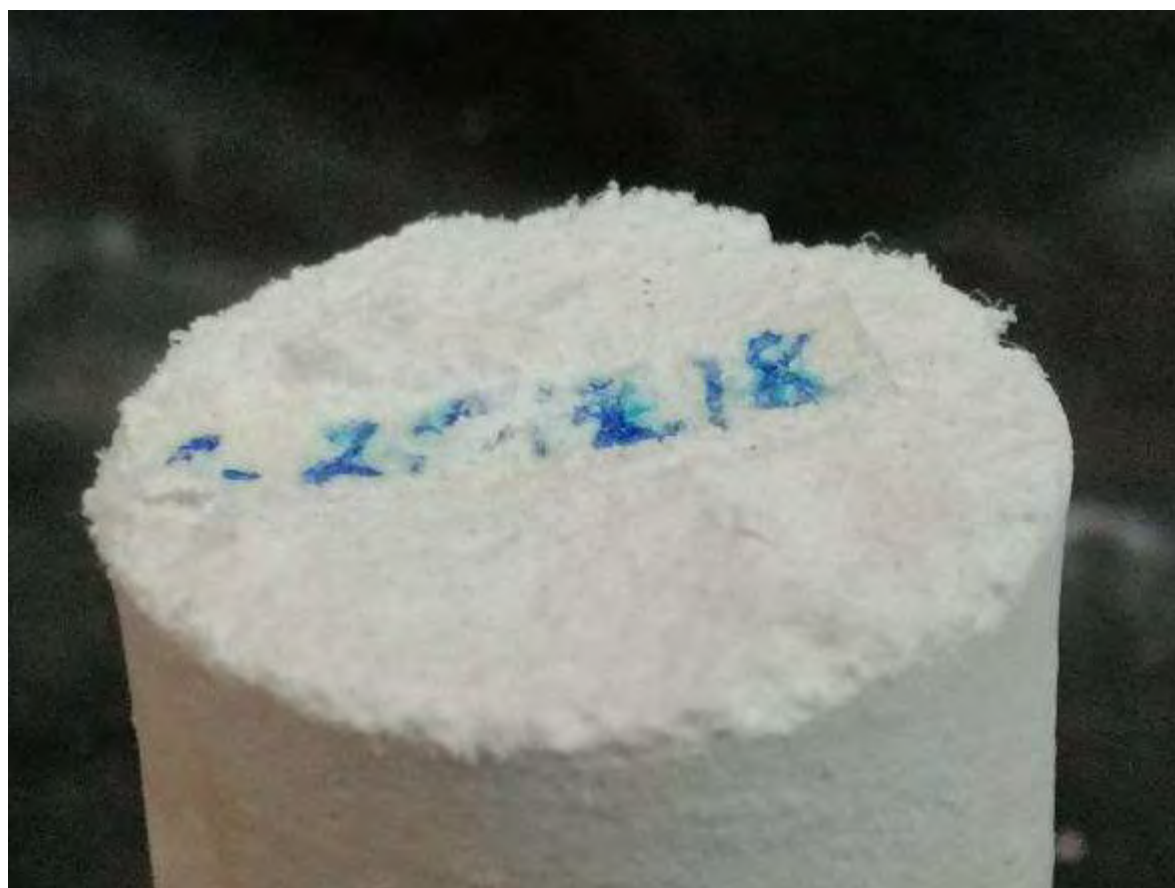
Figura. 4. 694. Imágenes de la corrida C-2101218, con presencia de eflorescencias en su parte externa. (autoría propia).
