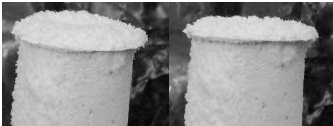
Figura. 4. 732. Imágenes de la corrida C-5101218, con presencia de eflorescencias en su parte externa. (autoría propia).
