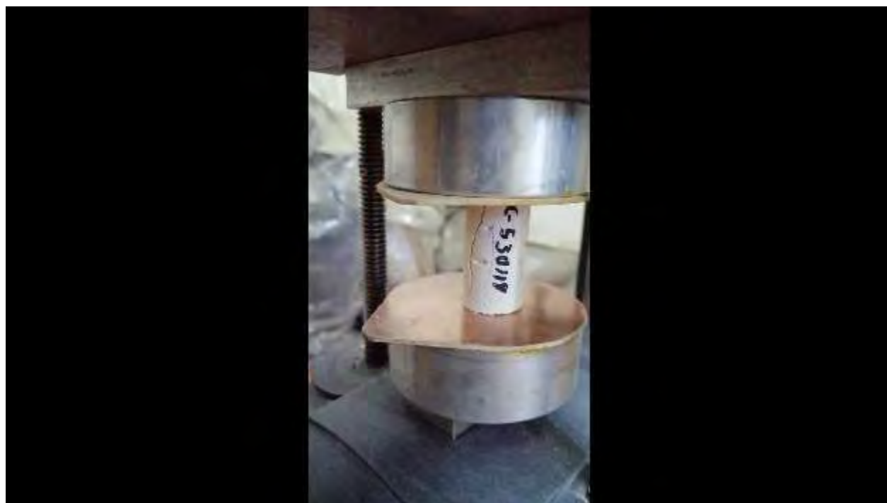
Figura. 4. 877. Fotografía, mostrando la falla en la probeta representativa de la C-530119. Fuente: (autoría propia).
