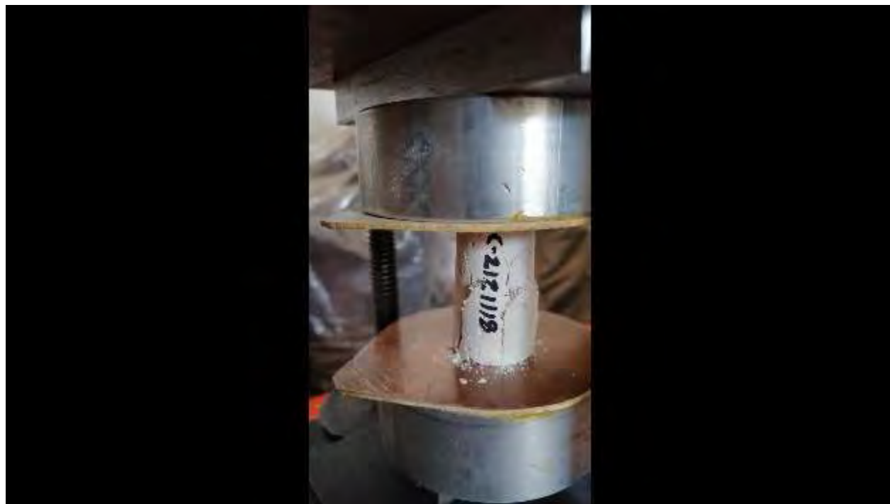
Figura. 4. 315. Fotografía, mostrando la falla en la probeta representativa de la C-2121118. Fuente: (autoría propia).
