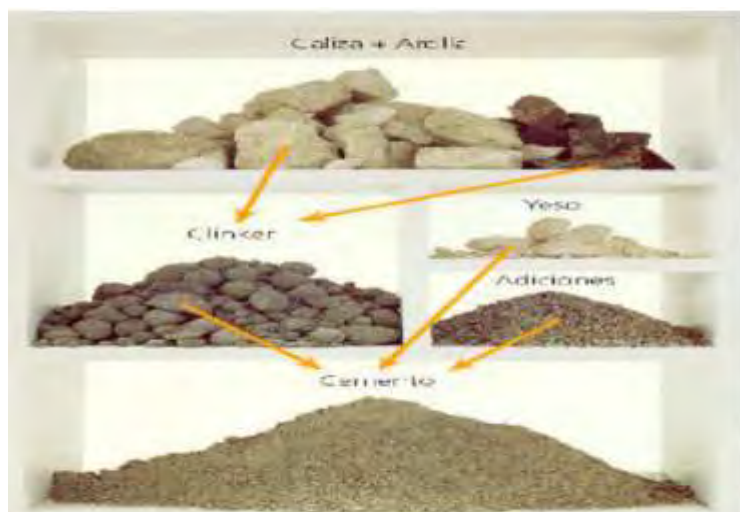
FIGURA. 2. 19. Mezcla para obtener el cemento portland.
