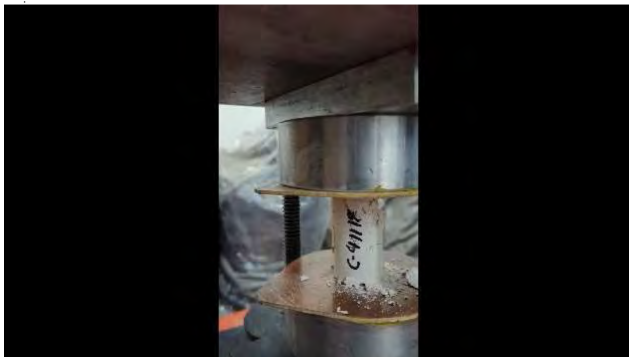
Figura. 4. 216. Fotografía, mostrando la falla en la probeta representativa de la C-481118. Fuente: (autoría propia).
