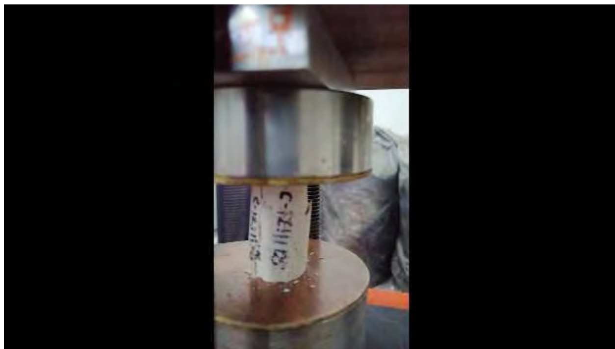
Figura. 4. 395. Fotografía, mostrando la falla en la probeta representativa de la C-1211118. Fuente: (autoría propia).
