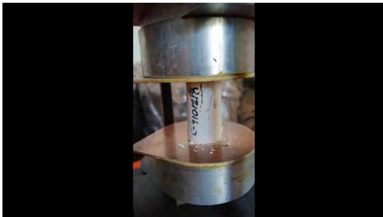
Figura. 4. 730. Fotografía, mostrando la falla en la probeta representativa de la C-4101218. Fuente: (autoría propia).
