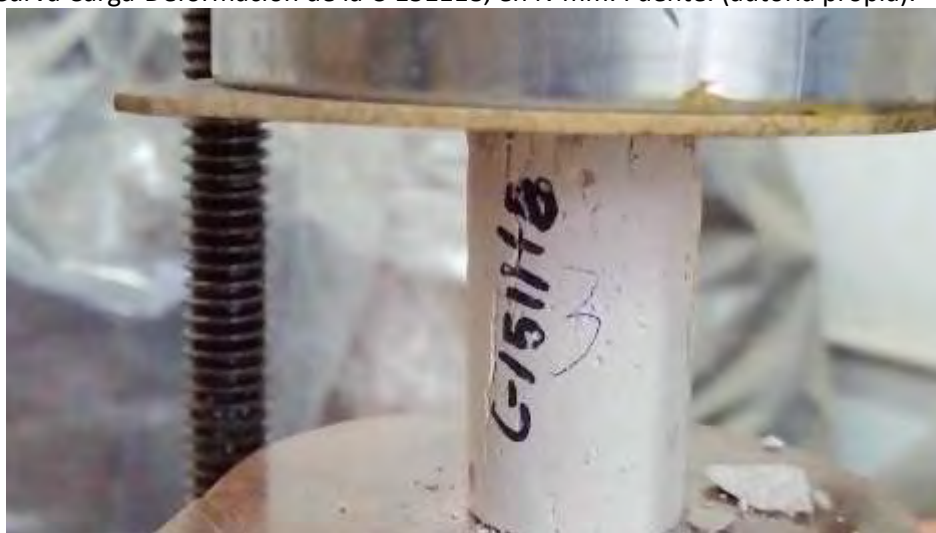
Figura. 4. 90. Fotografía, mostrando la falla en la probeta representativa de la C-151118. Fuente: (autoría propia).
