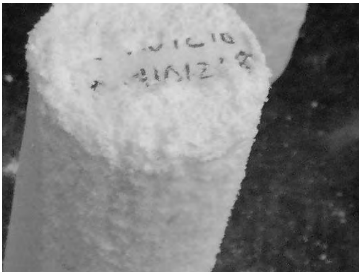
Figura. 4. 719. Imágenes de la corrida C-410128, con presencia de eflorescencias en su parte externa. (autoría propia).
