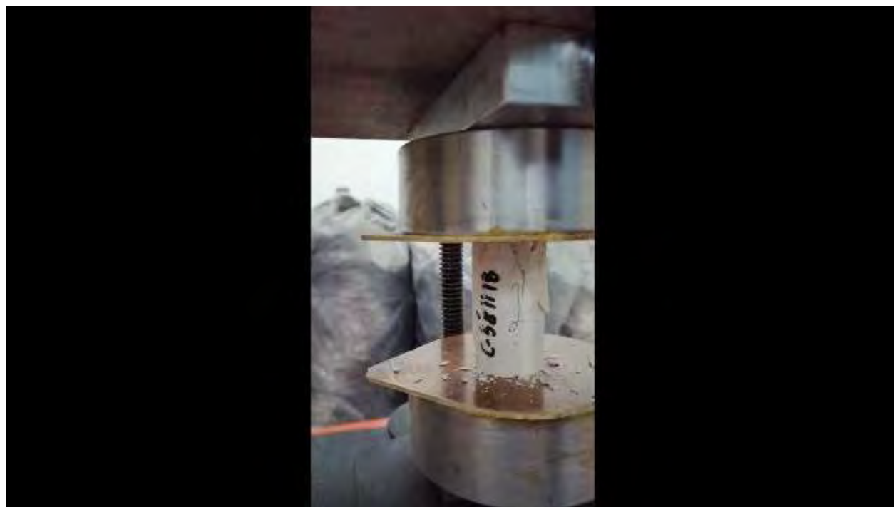
Figura. 4. 229. Fotografía, mostrando la falla en la probeta representativa de la C-581118. Fuente: (autoría propia).
