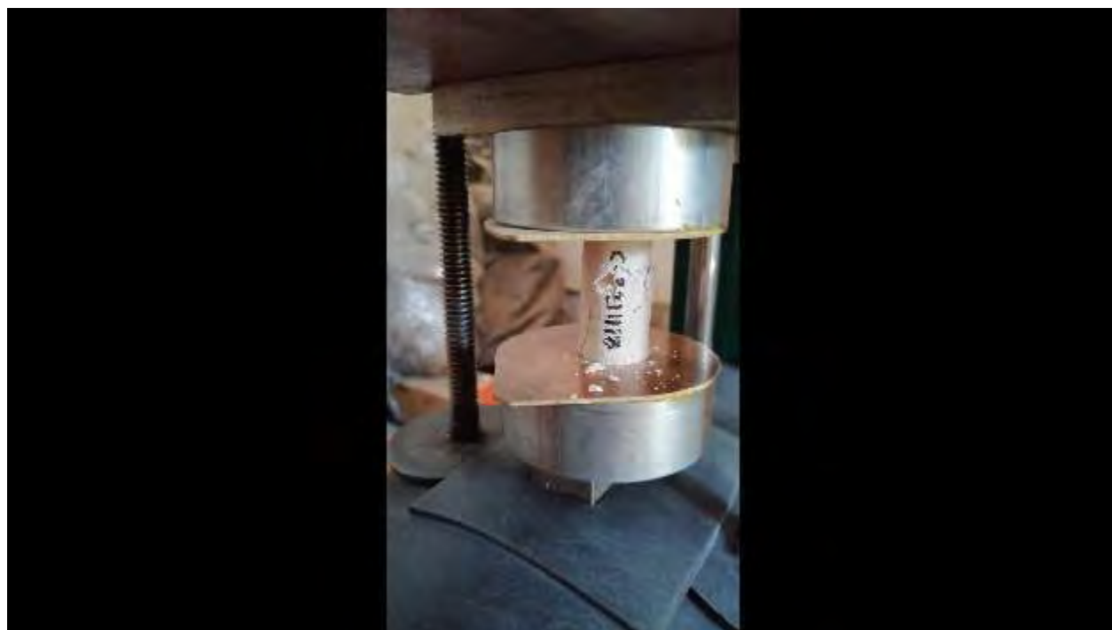
Figura. 4. 422. Fotografía, mostrando la falla en la probeta representativa de la C-321118. Fuente: (autoría propia)
