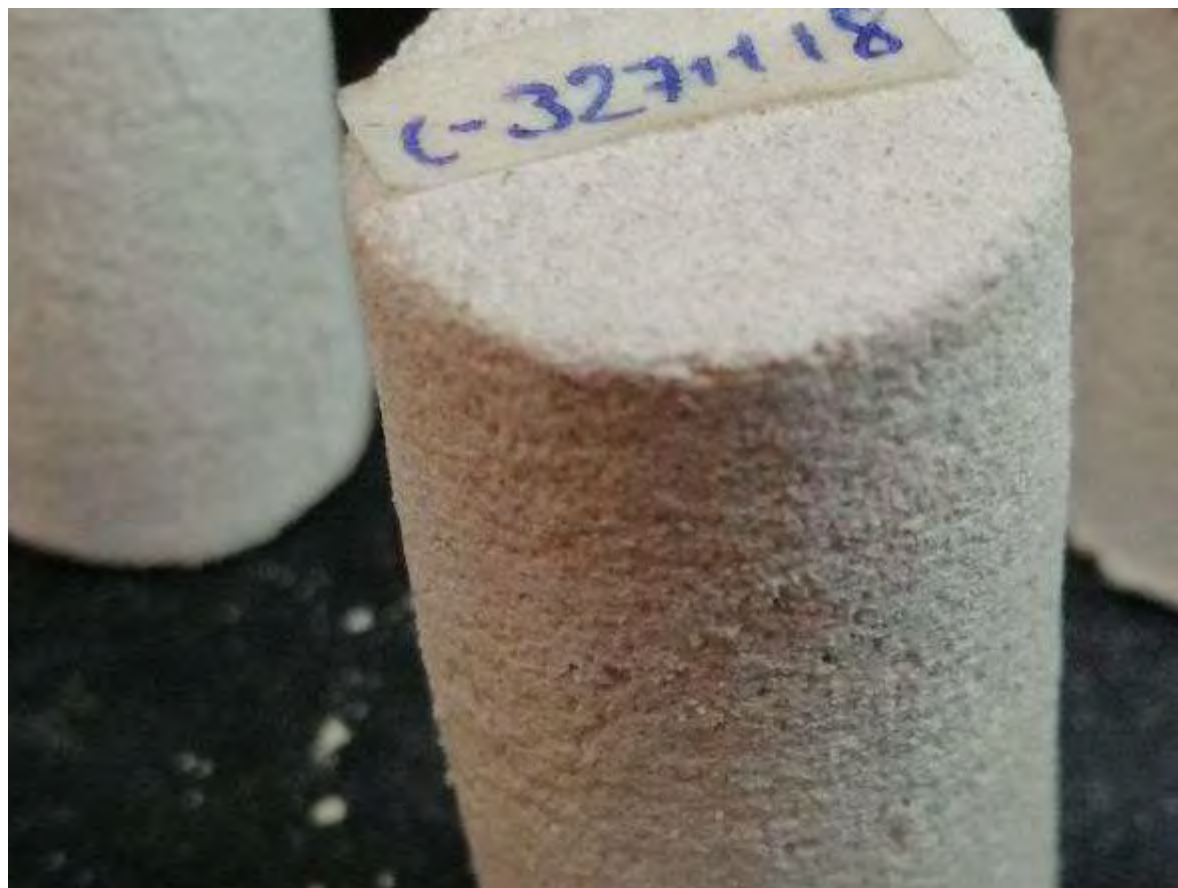
Figura. 4. 488. Imágenes de la corrida C-327118, con presencia de eflorescencias en su parte externa. (autoría propia).
