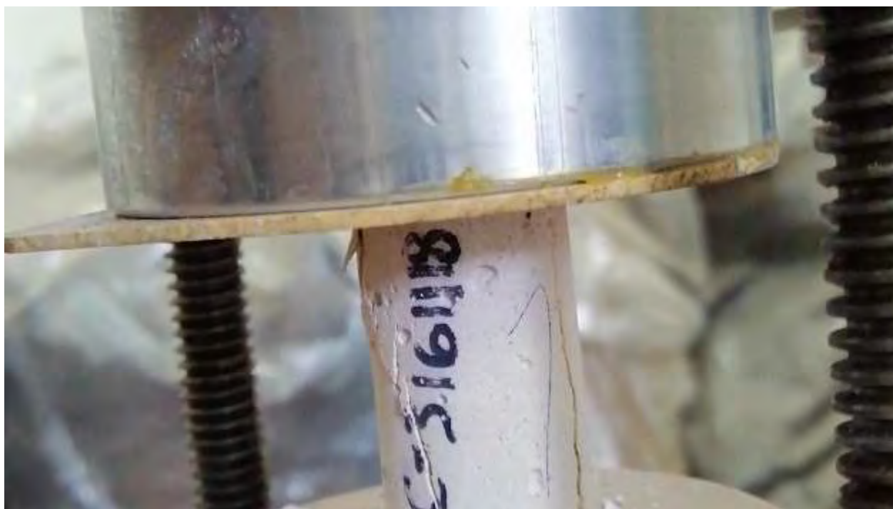
Figura. 4. 368. Fotografía, mostrando la falla en la probeta representativa de la C-3161118. Fuente: (autoría propia).
