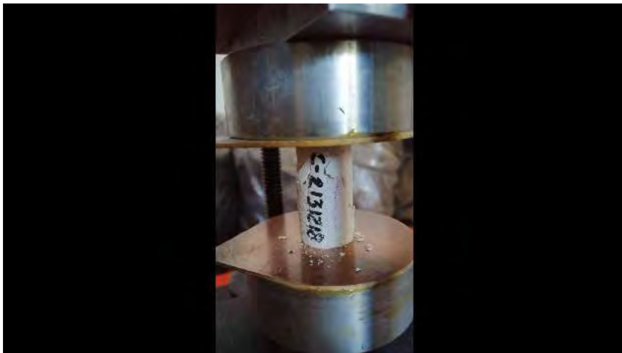
Figura. 4. 772. Fotografía, mostrando la falla en la probeta representativa de la C-2131218. Fuente: (autoría propia).
