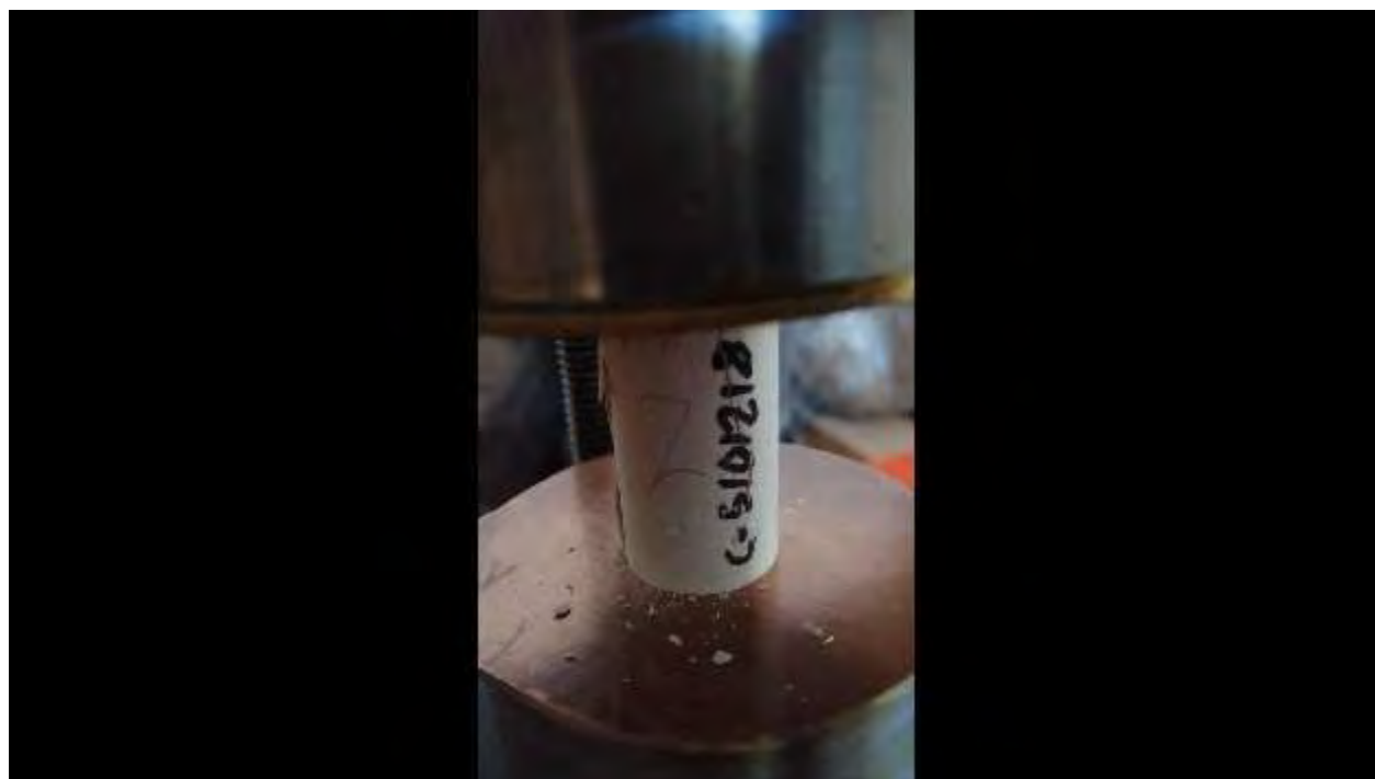
Figura. 4. 745. Fotografía, mostrando la falla en la probeta representativa de la C-5101218. Fuente: (autoría propia).
