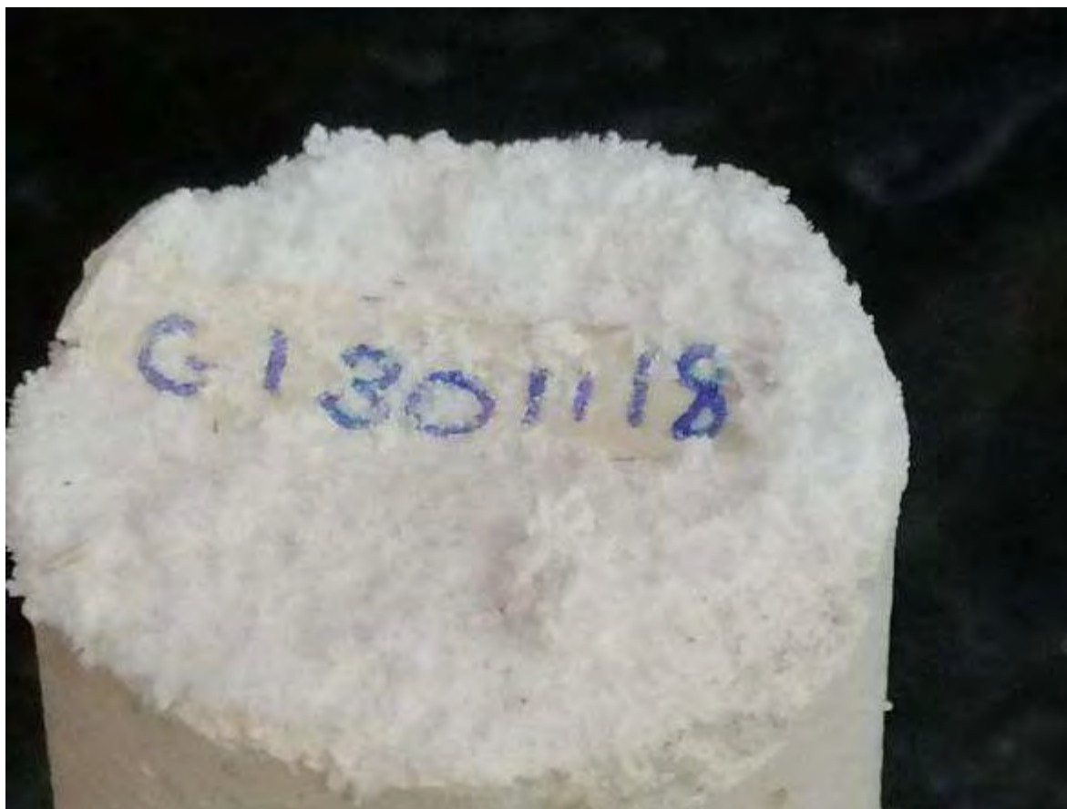
Figura. 4. 558. Imágenes de la corrida C-1301118, con presencia de eflorescencias en su parte externa. (autoría propia).
