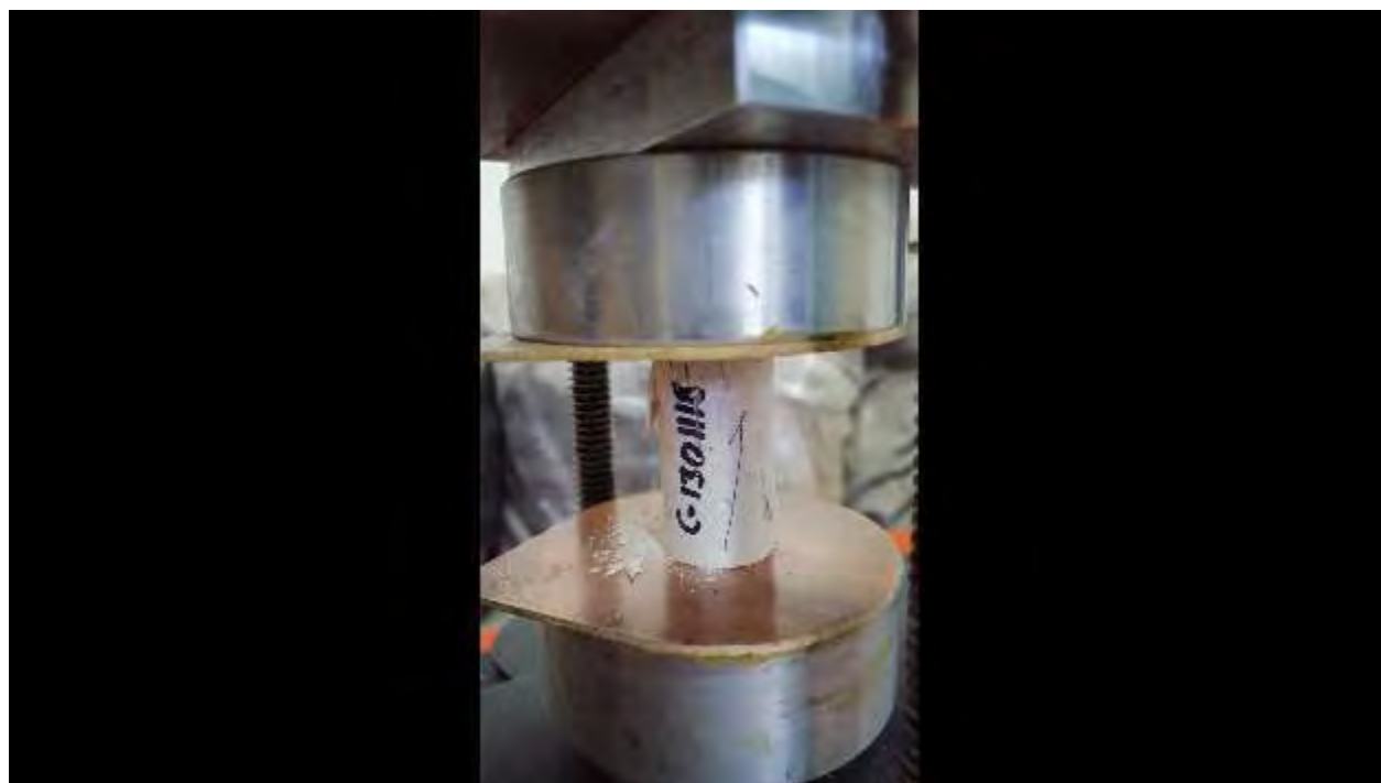
Figura. 4. 570. Fotografía, mostrando la falla en la probeta representativa de la C-1301118. Fuente: (autoría propia).
