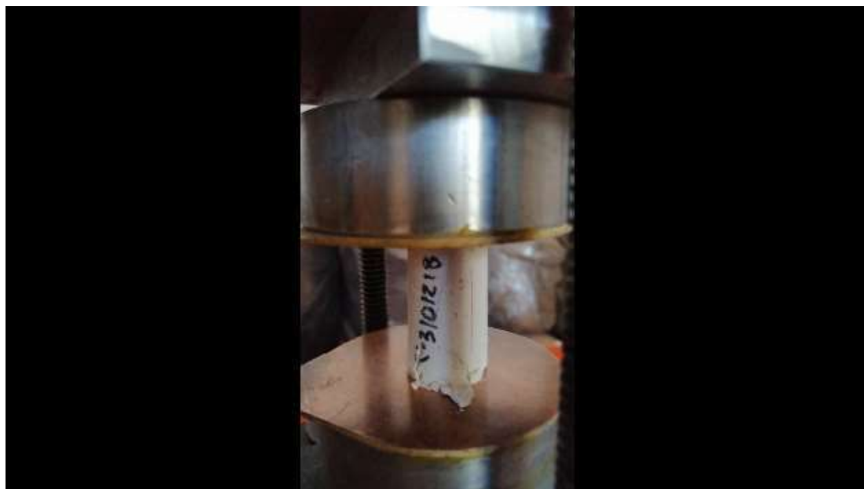
Figura. 4. 717. Fotografía, mostrando la falla en la probeta representativa de la C-3101218. Fuente: (autoría propia).
