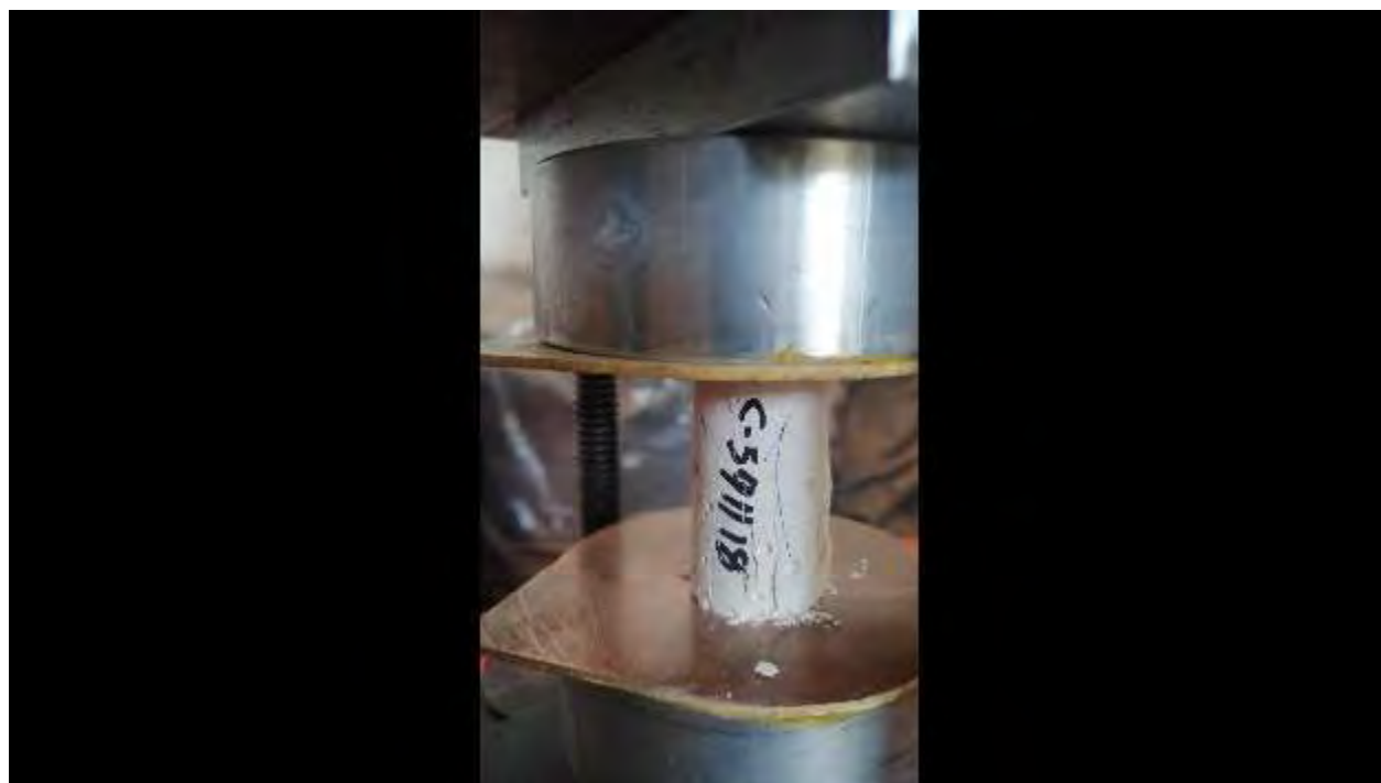
Figura. 4. 293. Fotografía, mostrando la falla en la probeta representativa de la C-591118. Fuente: (autoría propia).
