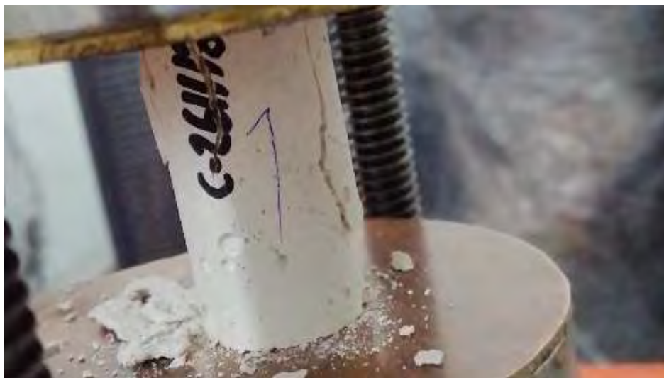
Figura. 4. 129. Fotografía, mostrando la falla en la probeta representativa de la C-261118. Fuente: (autoría propia).
