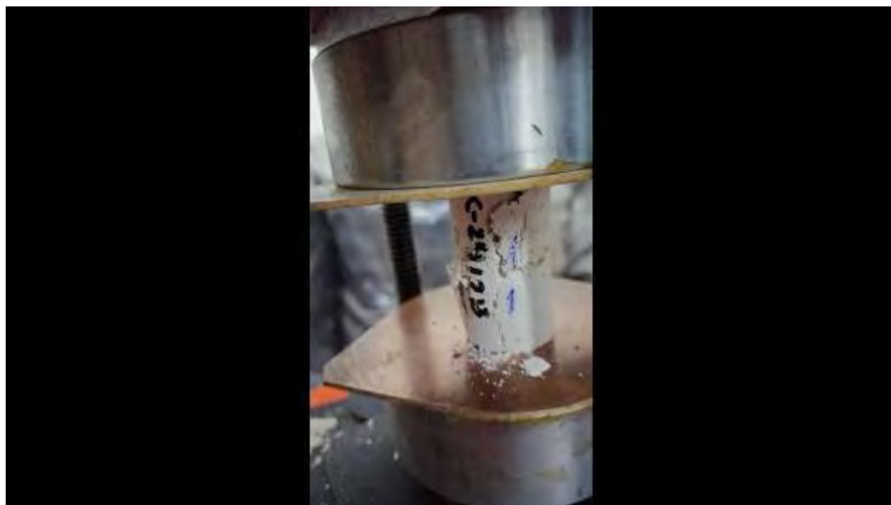
Figura. 4. 639. Fotografía, mostrando la falla en la probeta representativa de la C-241218. Fuente: (autoría propia).
