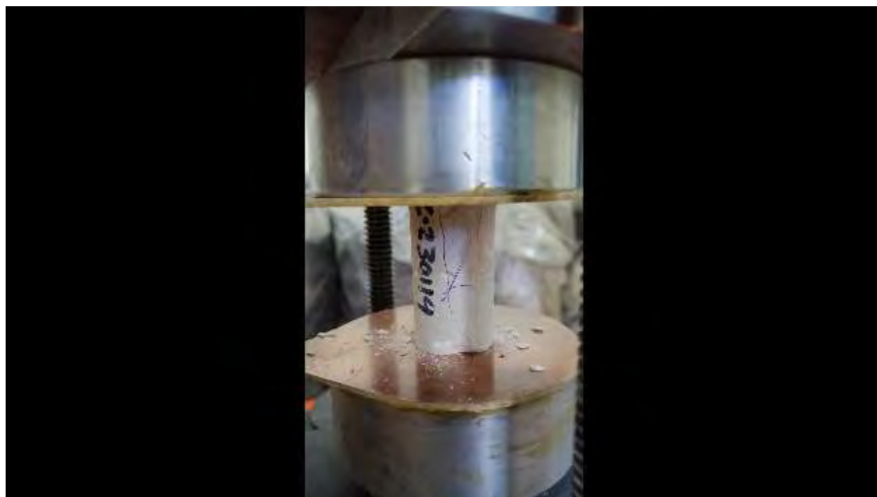
Figura. 4. 849. Fotografía, mostrando la falla en la probeta representativa de la C-230119. Fuente: (autoría propia).
