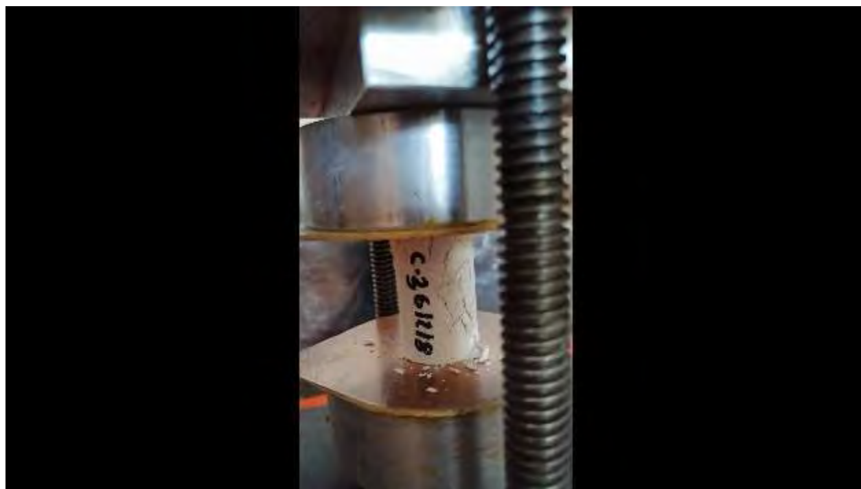
Figura. 4. 679. Fotografía, mostrando la falla en la probeta representativa de la C-361218. Fuente: (autoría propia).
