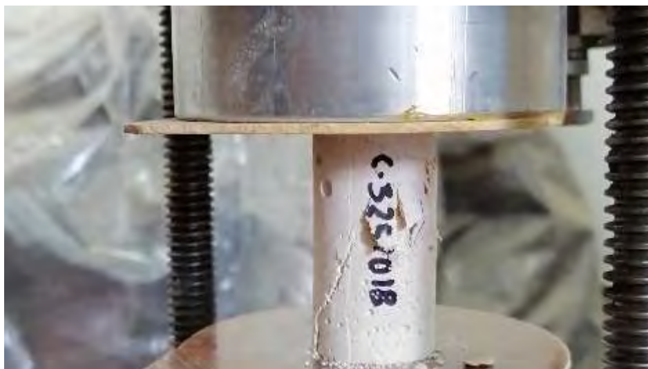
Figura. 4. 48. Fotografía, mostrando la falla en la probeta representativa de la C-3251018. Fuente: (autoría propia).
