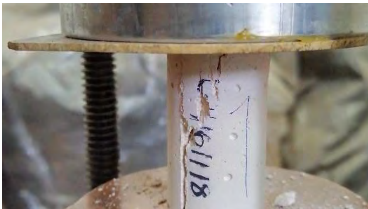
Figura. 4. 381. Fotografía, mostrando la falla en la probeta representativa de la C-4161118. Fuente: (autoría propia).
