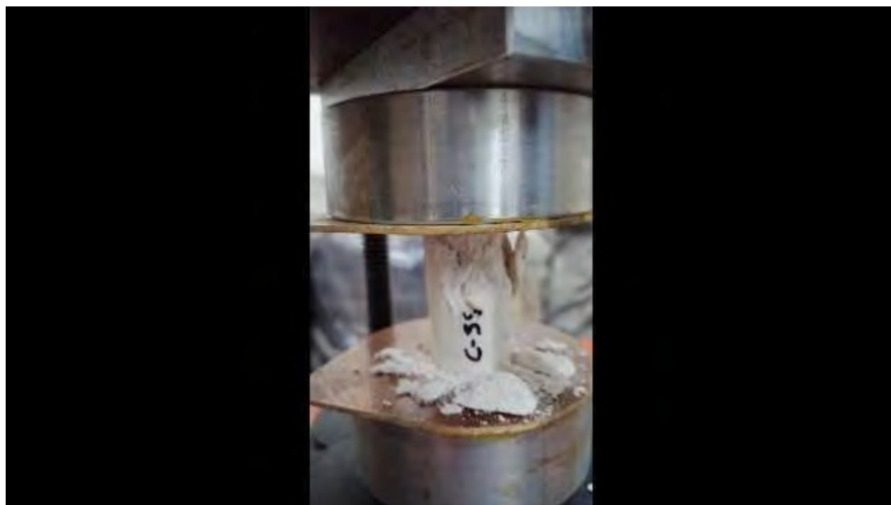
Figura. 4. 267. Fotografía, mostrando la falla en la probeta representativa de la C-391118. Fuente: (autoría propia).
