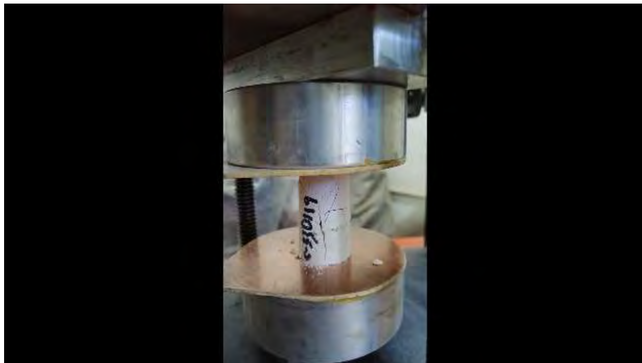
Figura. 4. 859. Fotografía, mostrando la falla en la probeta representativa de la C-330119. Fuente: (autoría propia).
