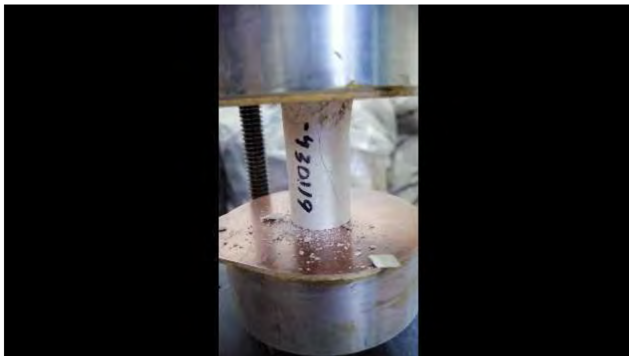
Figura. 4. 868. Fotografía, mostrando la falla en la probeta representativa de la C-430119. Fuente: (autoría propia).
