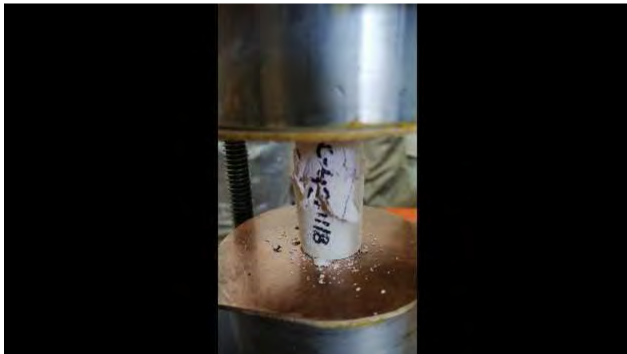
Figura. 4. 515. Fotografía, mostrando la falla en la probeta representativa de la C-4271118. Fuente: (autoría propia).
