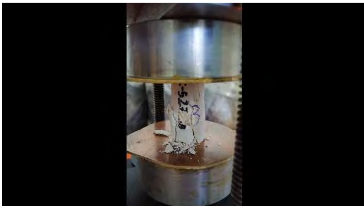
Figura. 4. 527. Fotografía, mostrando la falla en la probeta representativa de la C-5271118. Fuente: (autoría propia).
