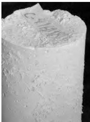
Figura. 4. 370. Imágenes de la corrida C-416118, con presencia de eflorescencias en su parte externa. (autoría propia).
