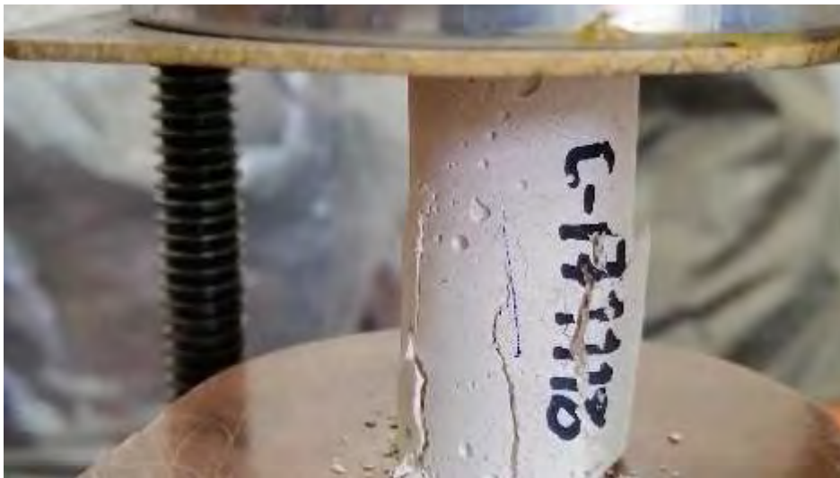
Figura. 4. 141. Fotografía, mostrando la falla en la probeta representativa de la C-17118. Fuente: (autoría propia).
