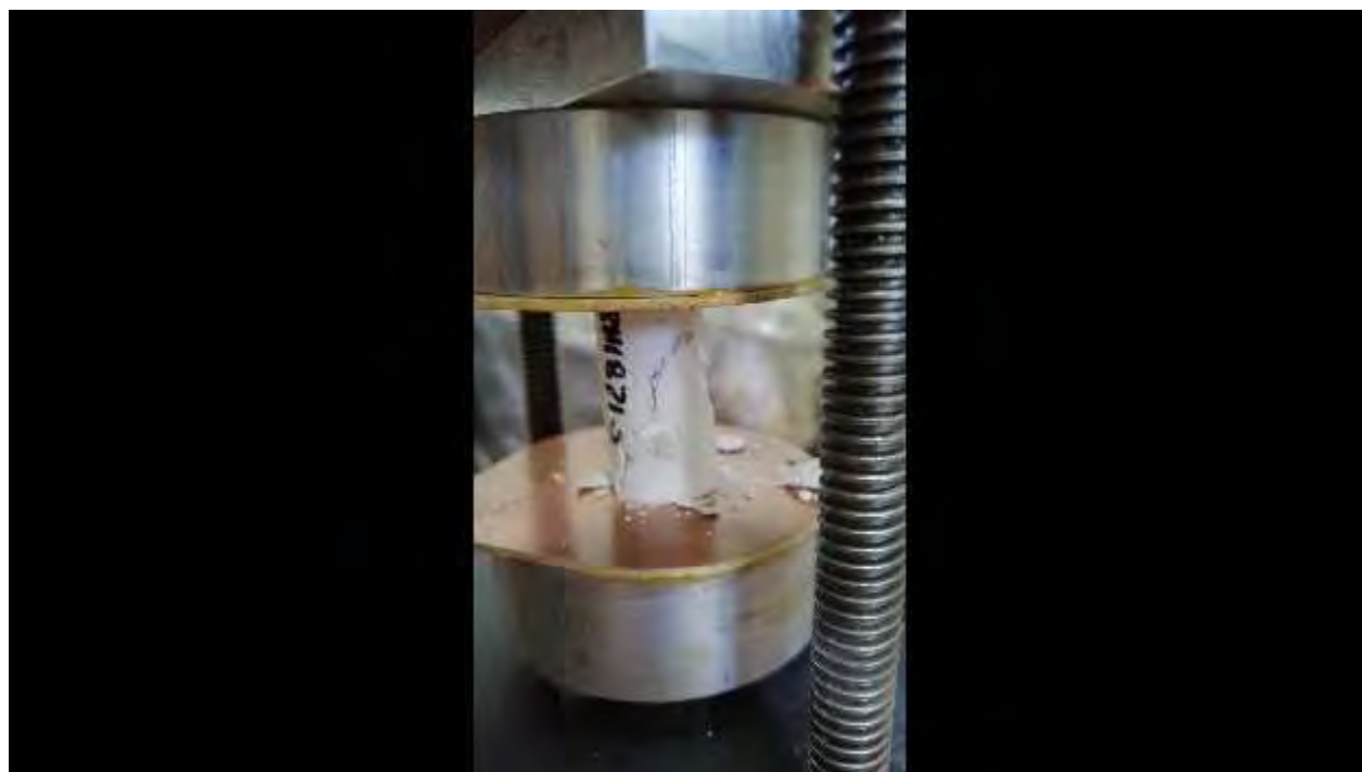
Figura. 4. 542. Fotografía, mostrando la falla en la probeta representativa de la C-1281118. Fuente: (autoría propia).
