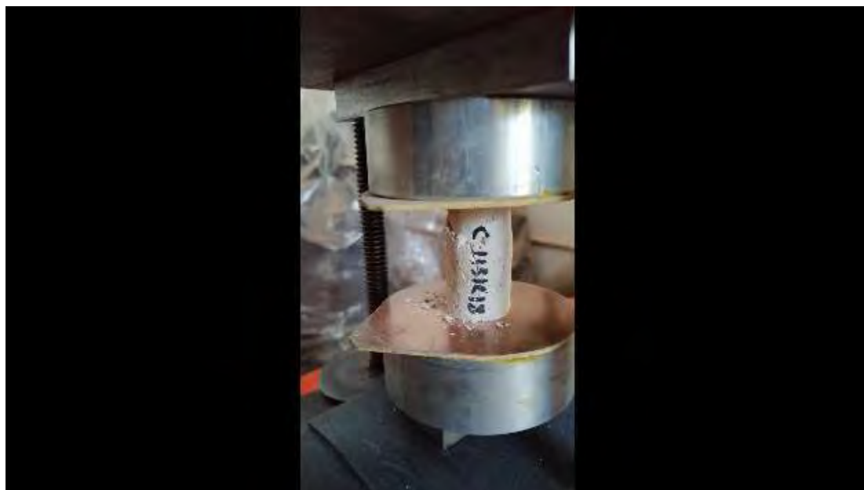
Figura. 4. 759. Fotografía, mostrando la falla en la probeta representativa de la C-1131218. Fuente: (autoría propia).
