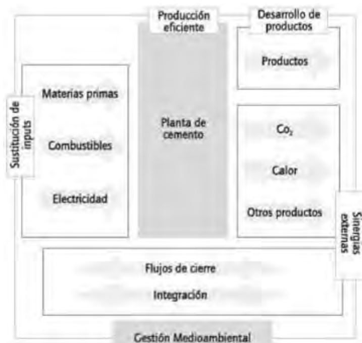
FIGURA. 2. 76. Integración de las medidas de reducción de las emisiones de dióxido carbono (CO 2 ) en la producción de cemento Portland.
