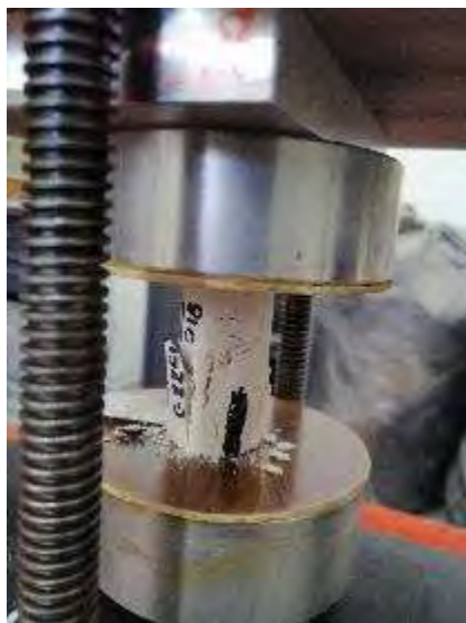
Figura. 4. 38. Fotografía de la C-2251018, mostrando la fractura, después de ser probada en la prensa. Fuente: (autoría propia).
