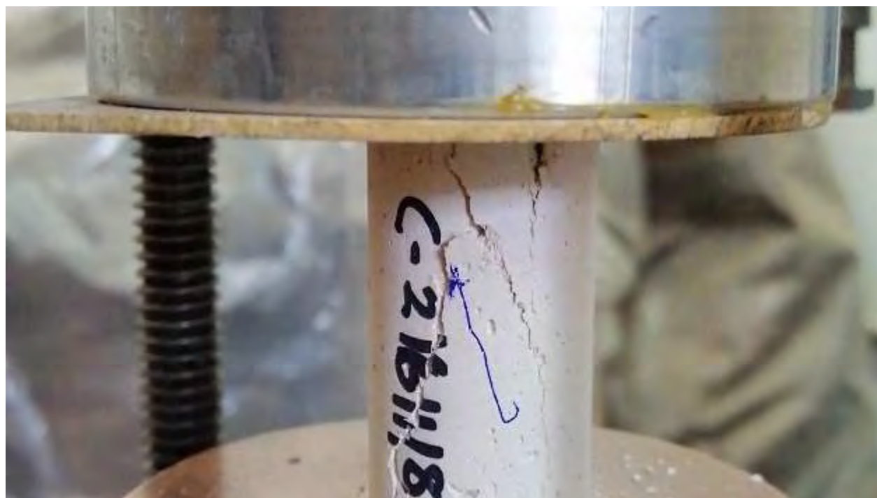
Figura. 4. 355. Fotografía, mostrando la falla en la probeta representativa de la C-2161118. Fuente: (autoría propia).
