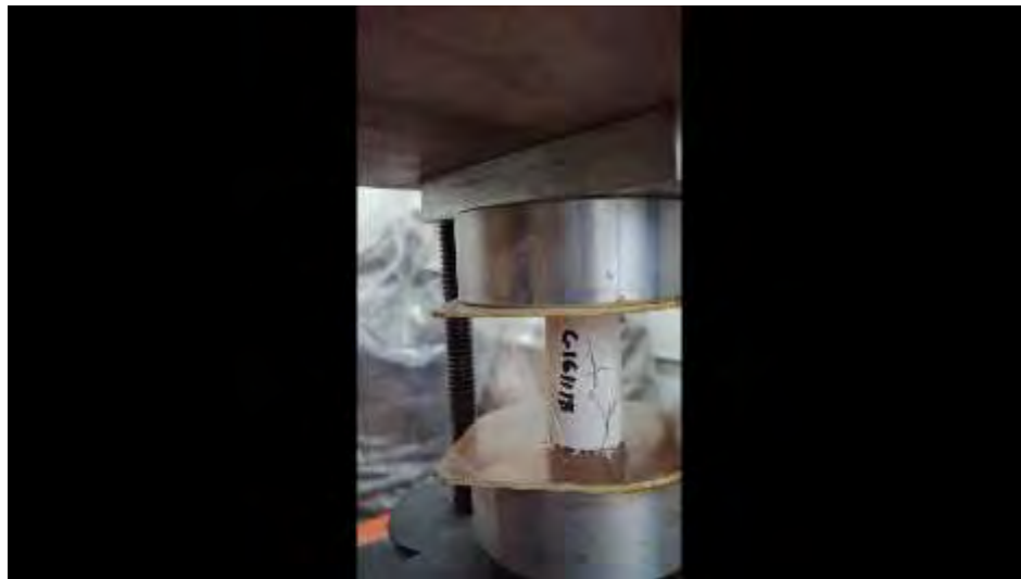
Figura. 4. 117. Fotografía, mostrando la falla en la probeta representativa de la C-161118. Fuente: (autoría propia)
