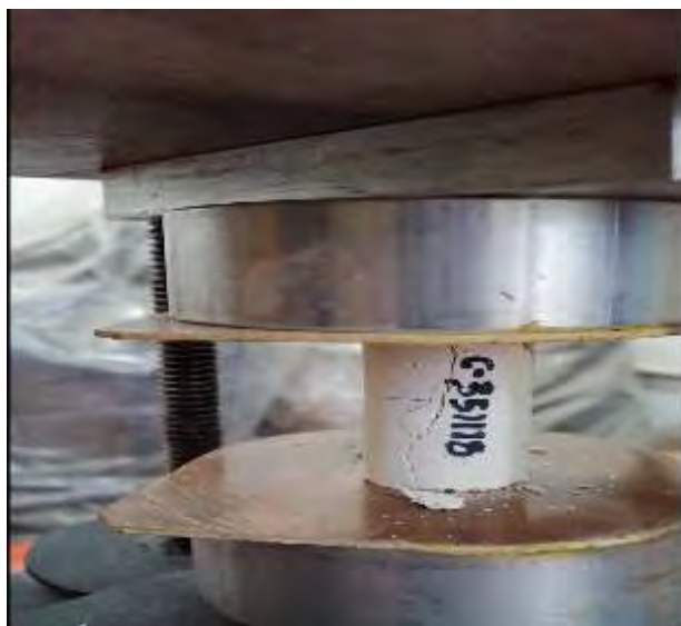
Figura. 4. 105. Fotografía, mostrando la falla en la probeta representativa de la C-351118. Fuente: (autoría propia).
