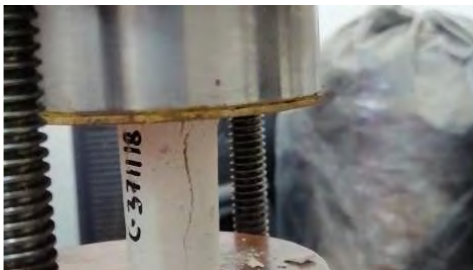
Figura. 4. 162. Fotografía, mostrando la falla en la probeta representativa de la C-3271118. Fuente: (autoría propia)
