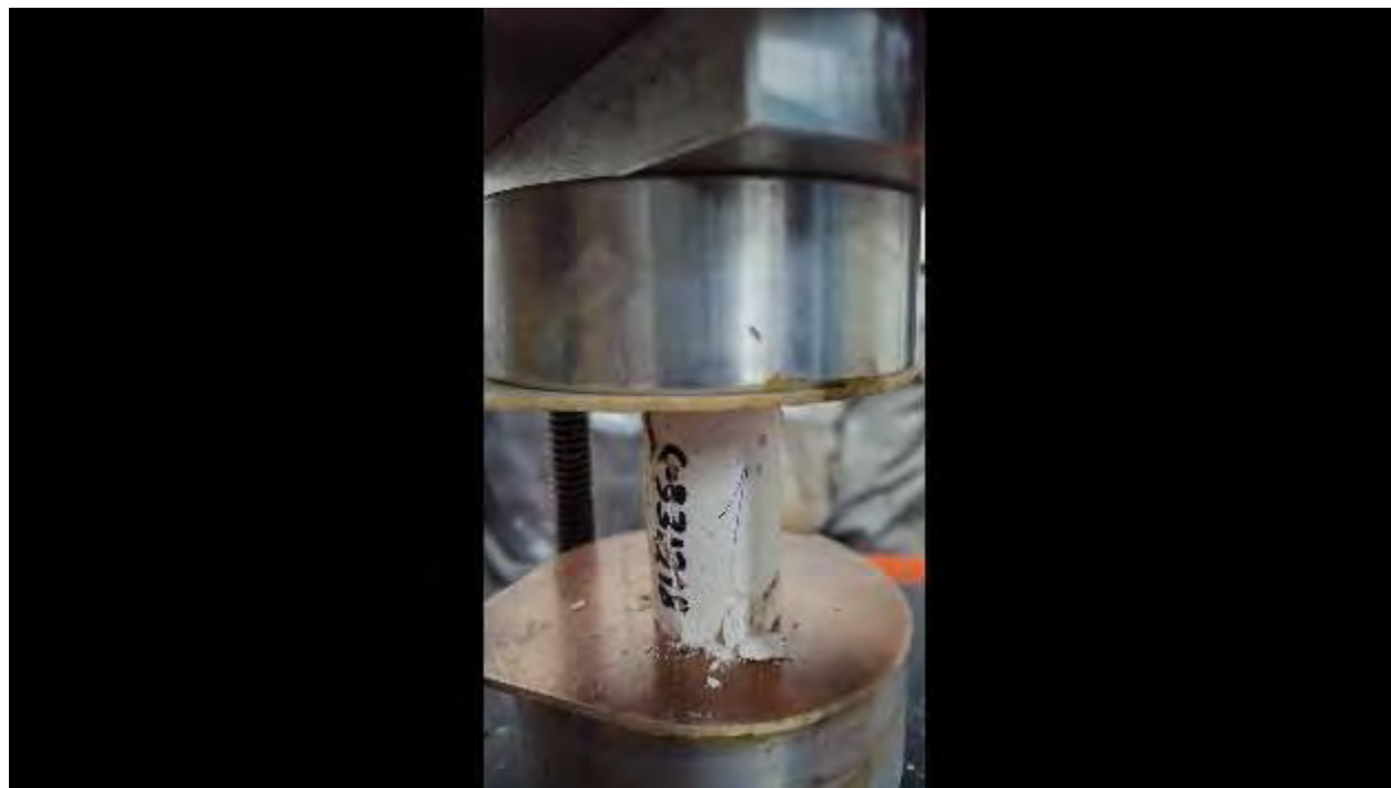
Figura. 4. 611. Fotografía, mostrando la falla en la probeta representativa de la C-331218. Fuente: (autoría propia).
