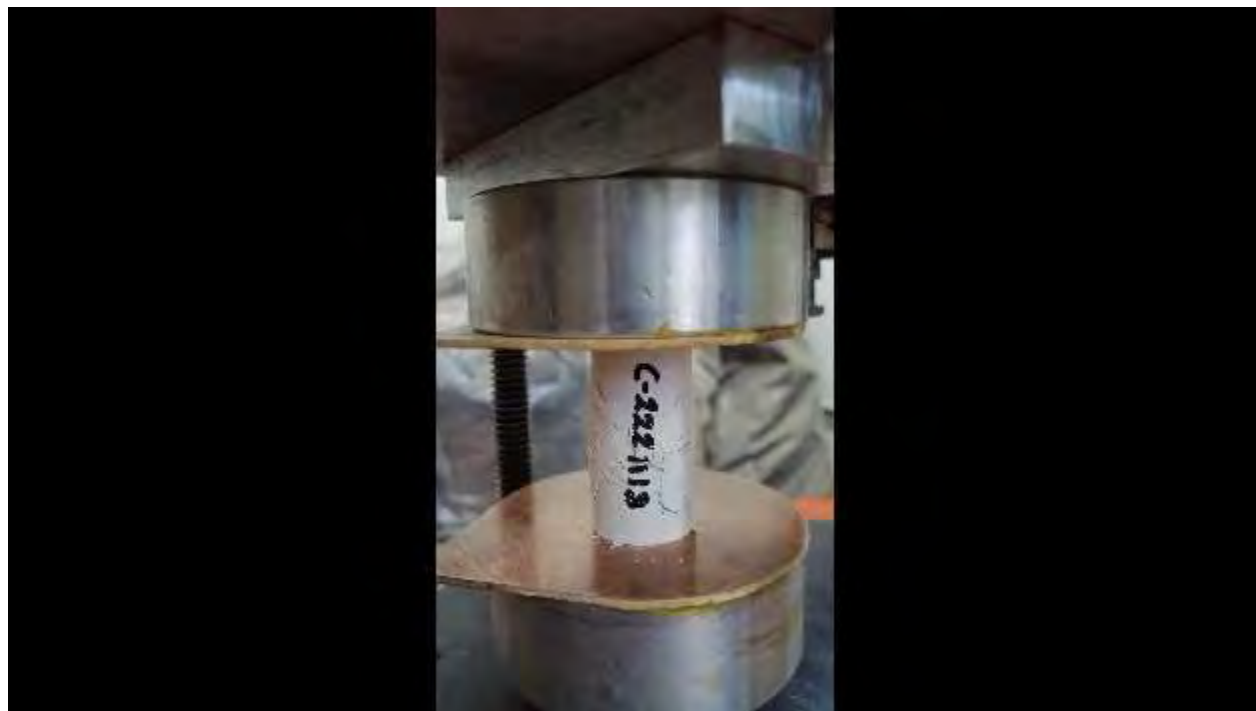
Figura. 4. 408. Fotografía, mostrando la falla en la probeta representativa de la C-221118. Fuente: (autoría propia).
