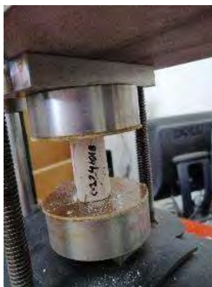
Figura. 4. 27. Fotografía, mostrando la falla en la probeta representativa de la C-2241018. Fuente: (autoría propia).
