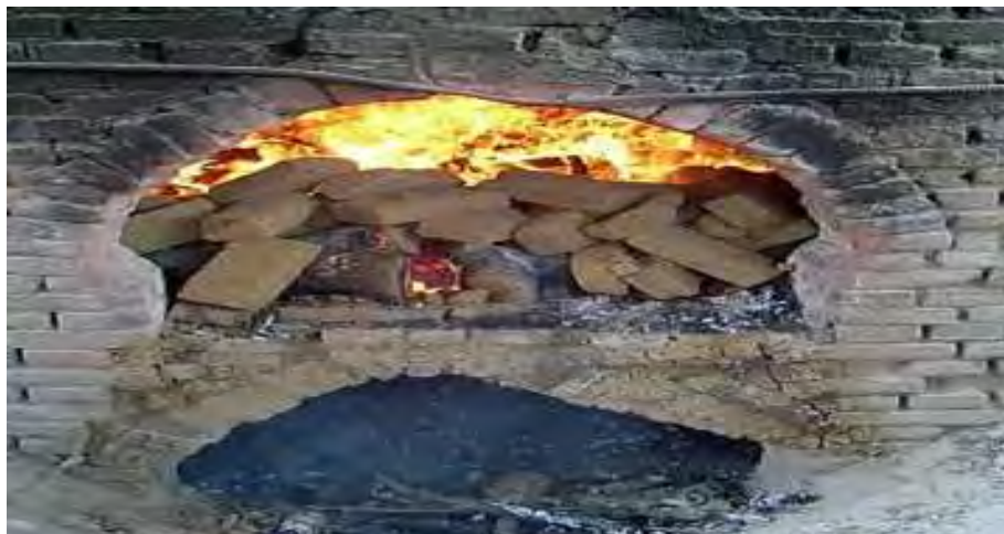
FIGURA. 2. 31 Ladrillos de bloque sólido combustible siendo incinerados para producir ceniza con características puzolánicas.
