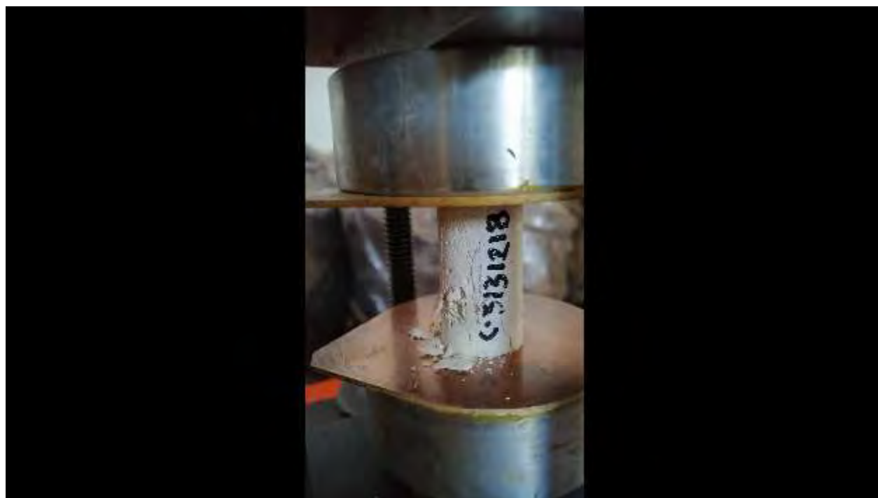
Figura. 4. 784. Fotografía, mostrando la falla en la probeta representativa de la C-3131218. Fuente: (autoría propia).
