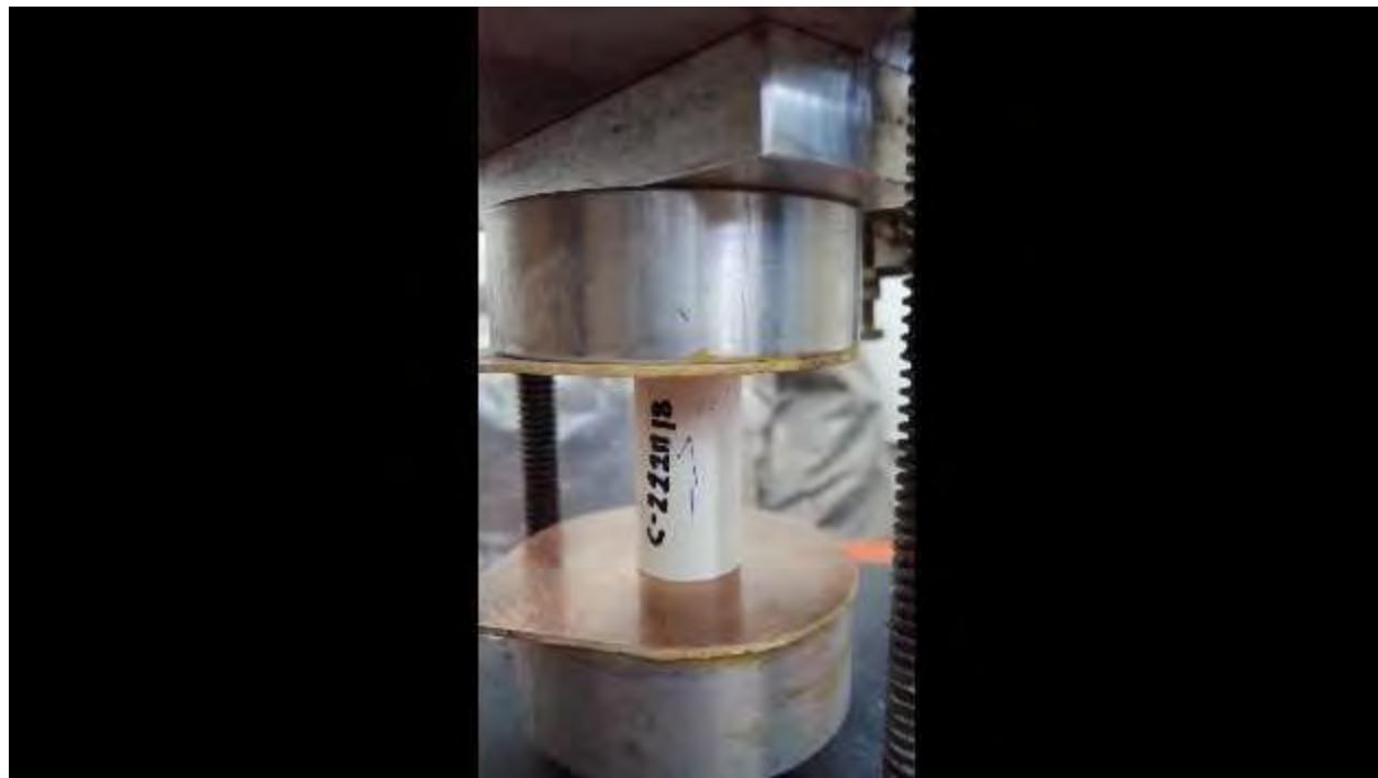
Figura. 4. 407. Fotografía de la C-221118, en la prensa. Fuente: (autoría propia).
