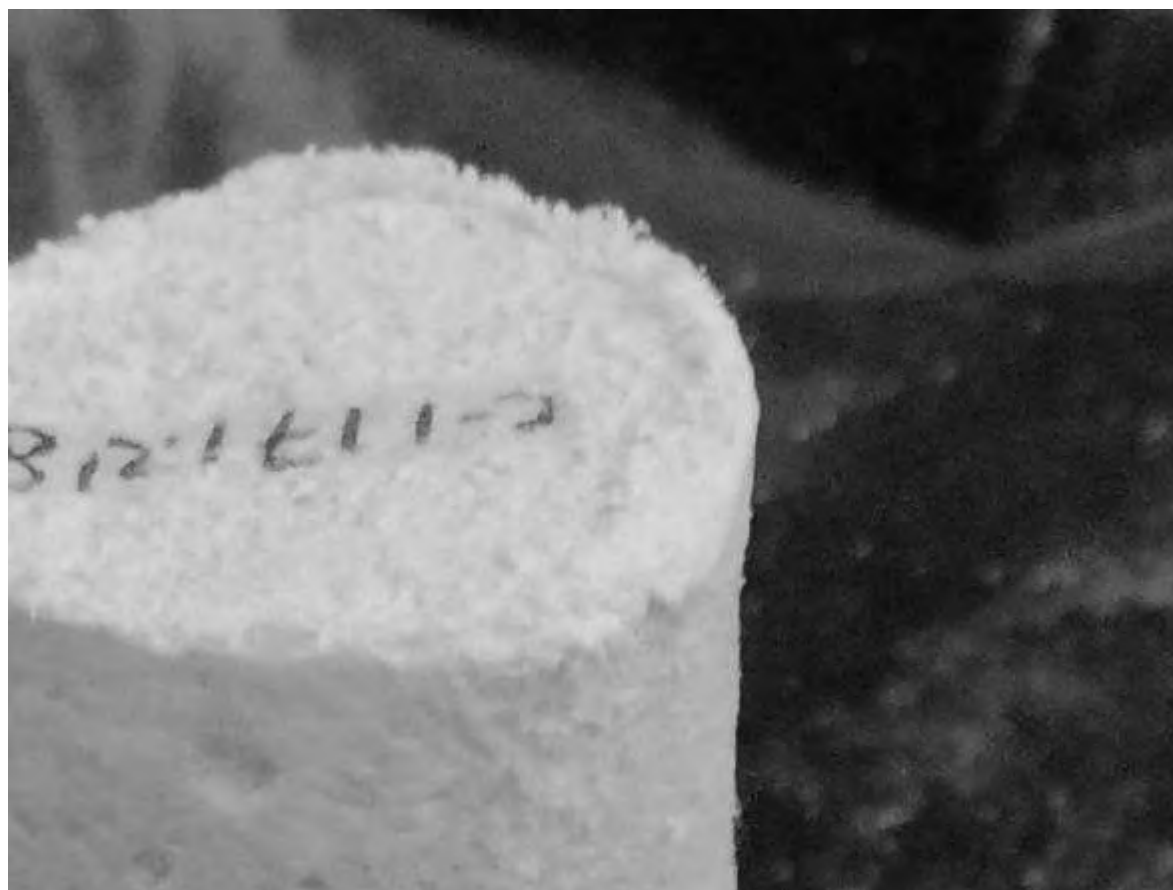
Figura. 4. 824. Imágenes de la corrida C-1171218, con presencia de eflorescencias en su parte externa. (autoría propia).
