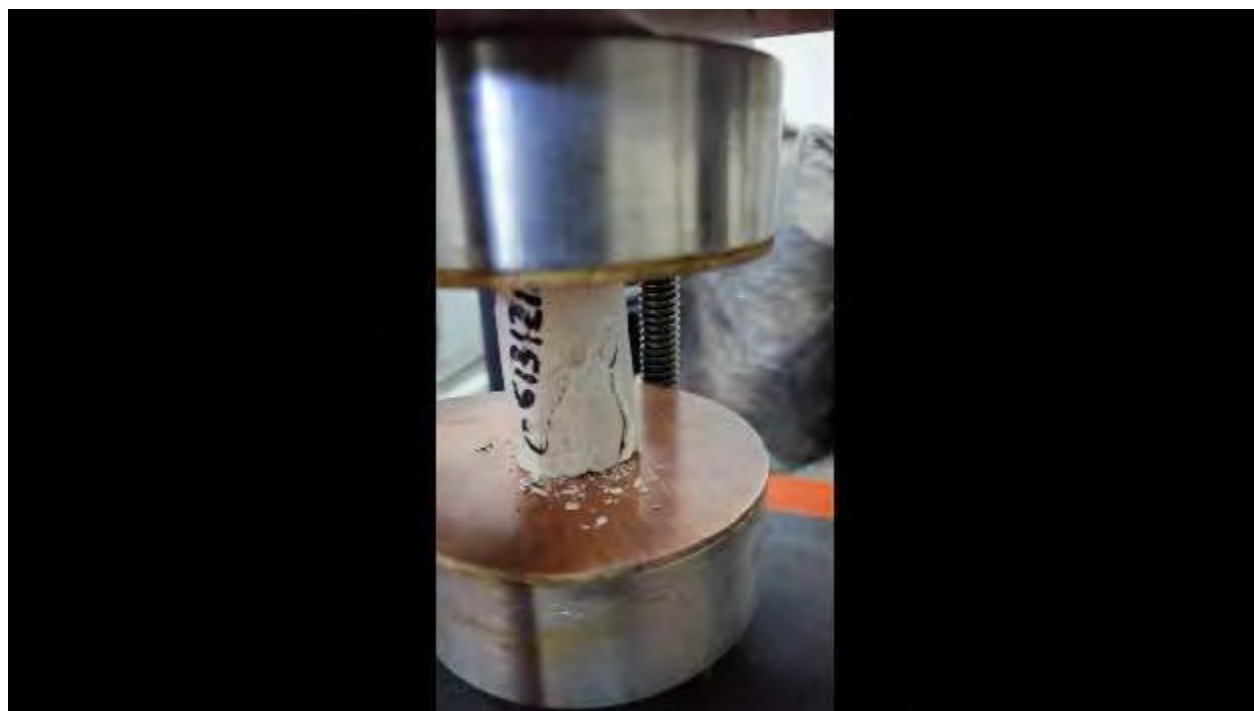
Figura. 4. 822. Fotografía, mostrando la falla en la probeta representativa de la C-6131218. Fuente: (autoría propia).
