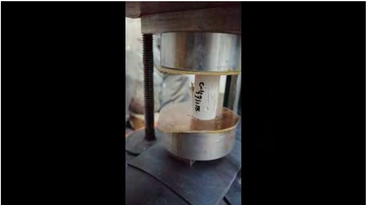
Figura. 4. 280. Fotografía, mostrando la falla en la probeta representativa de la C-491118. Fuente: (autoría propia).
