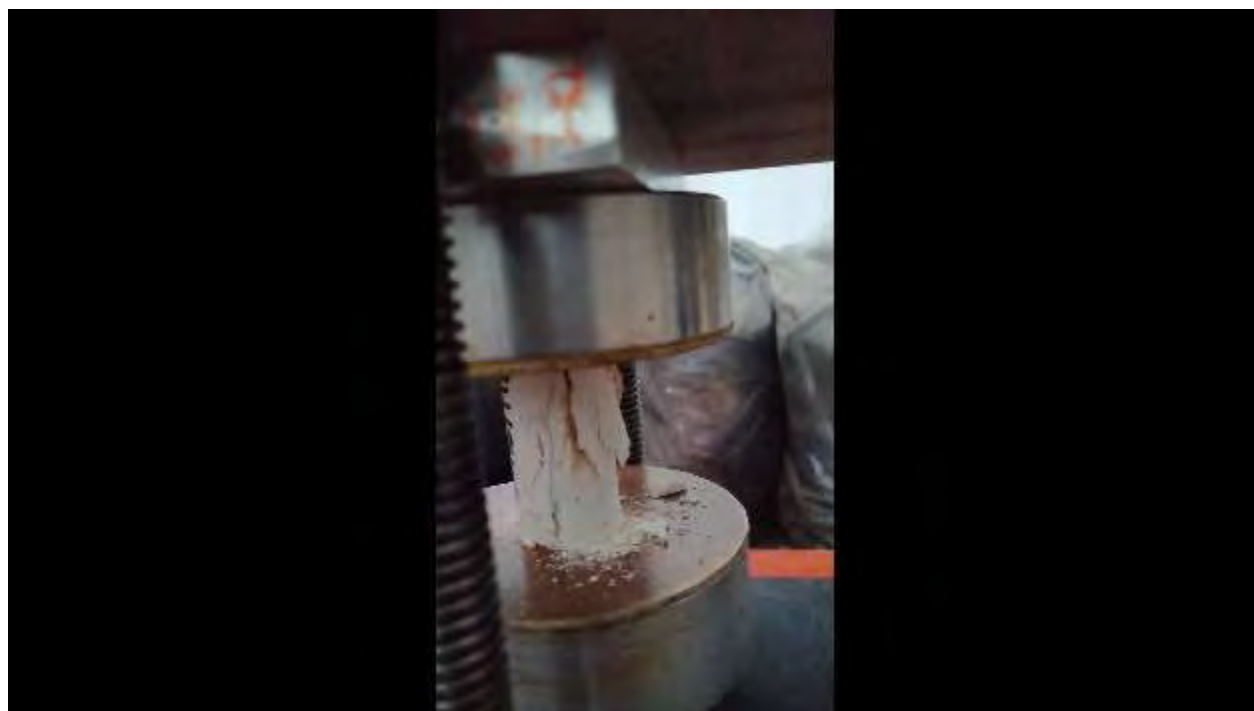
Figura. 4. 342. Fotografía, mostrando la falla en la probeta representativa de la C-1161118. Fuente: (autoría propia).
