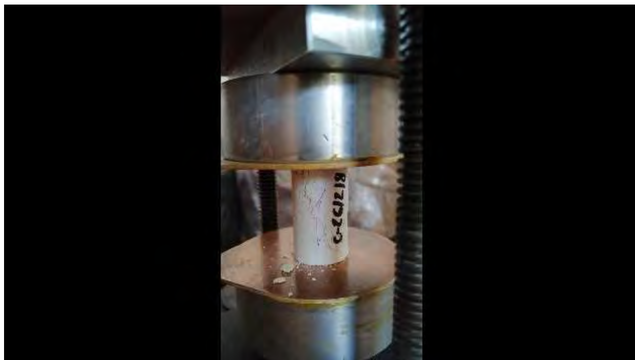
Figura. 4. 666. Fotografía, mostrando la falla en la probeta representativa de la C-261218. Fuente: (autoría propia).
