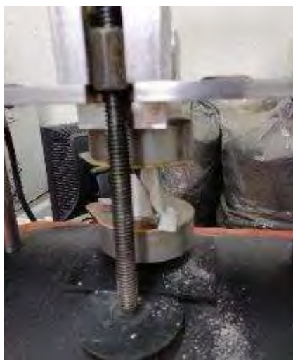
Figura. 4. 14. Fotografía, mostrando la falla en la probeta representativa de la C-1241018.
