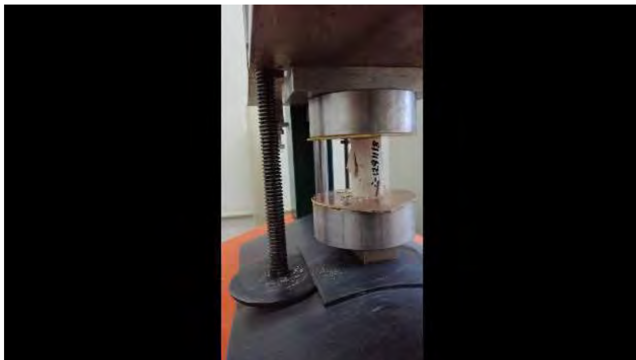
Figura. 4. 556. Fotografía, mostrando la falla en la probeta representativa de la C-1291118. Fuente: (autoría propia).
