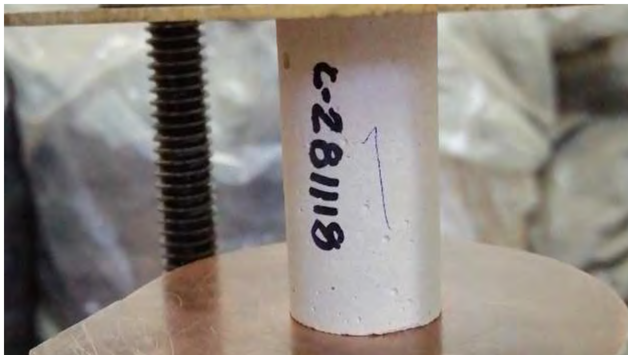
Figura. 4. 187. Fotografía de la C-281118, en la prensa. Fuente: (autoría propia).
