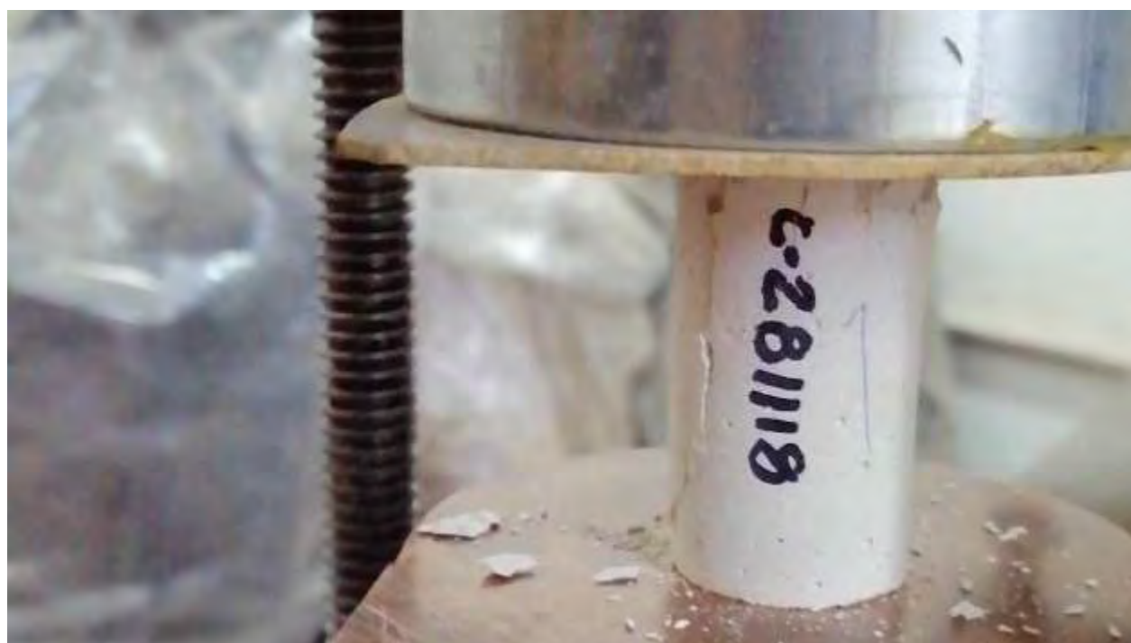
Figura. 4. 188. Fotografía, mostrando la falla en la probeta representativa de la C-281118. Fuente: (autoría propia).
