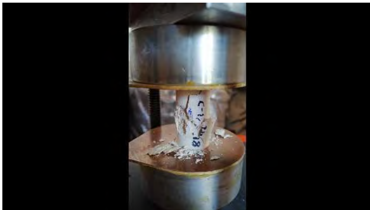
Figura. 4. 446. Fotografía, mostrando la falla en la probeta representativa de la C-122118. Fuente: (autoría propia).
