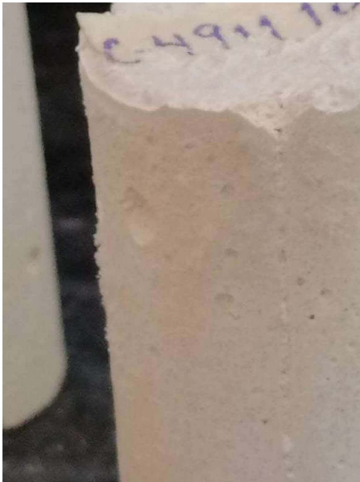
Figura. 4. 278. Imágenes de la corrida C-491118, con presencia de eflorescencias en su parte externa. (autoría propia).
