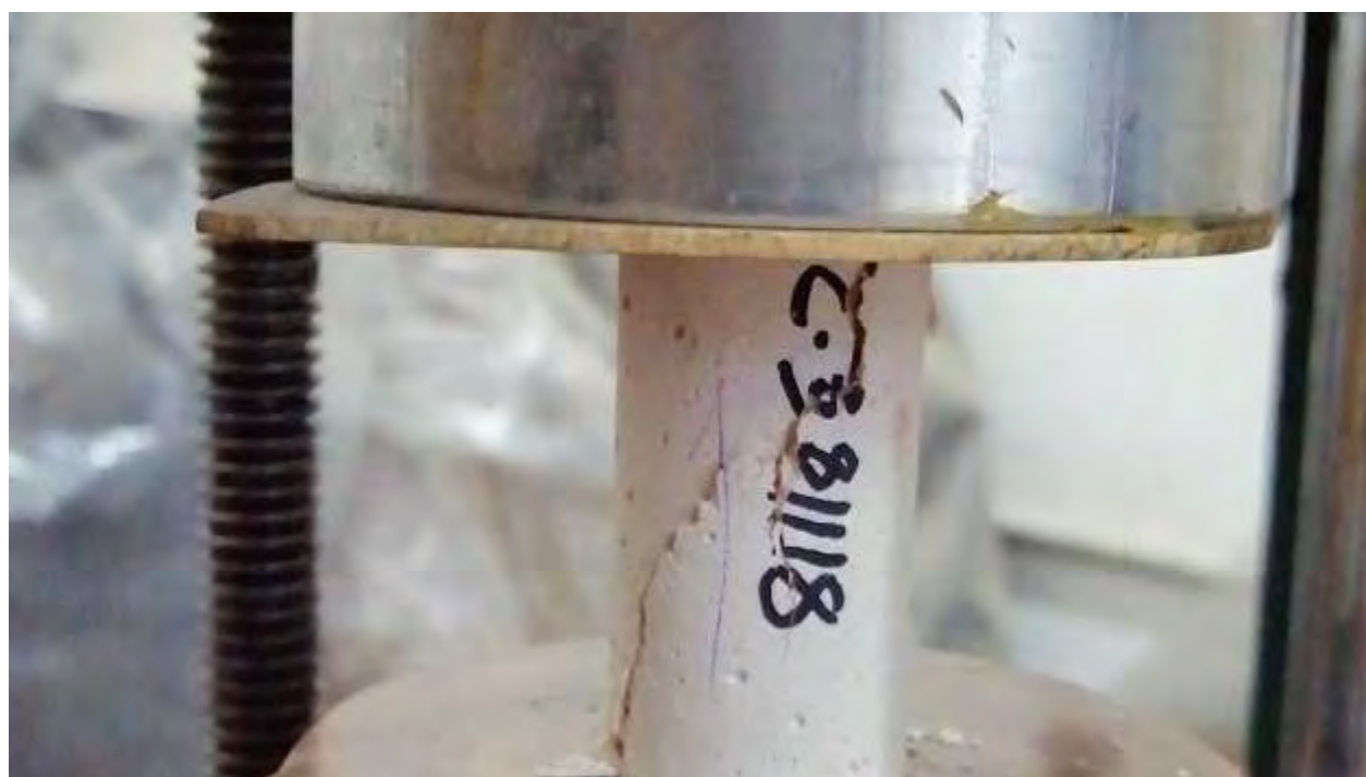
Figura. 4. 203. Fotografía, mostrando la falla en la probeta representativa de la C-381118. Fuente: (autoría propia).
