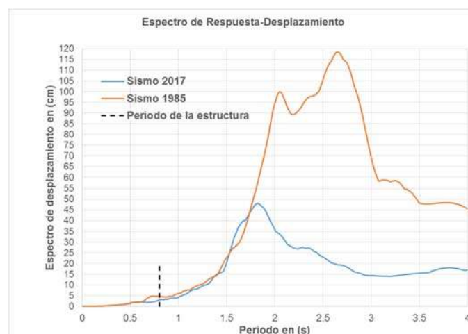
Figura 3.9– Espectros de respuesta de desplazamiento del sismo de 1985 y 2017 para los registros de la SCT
