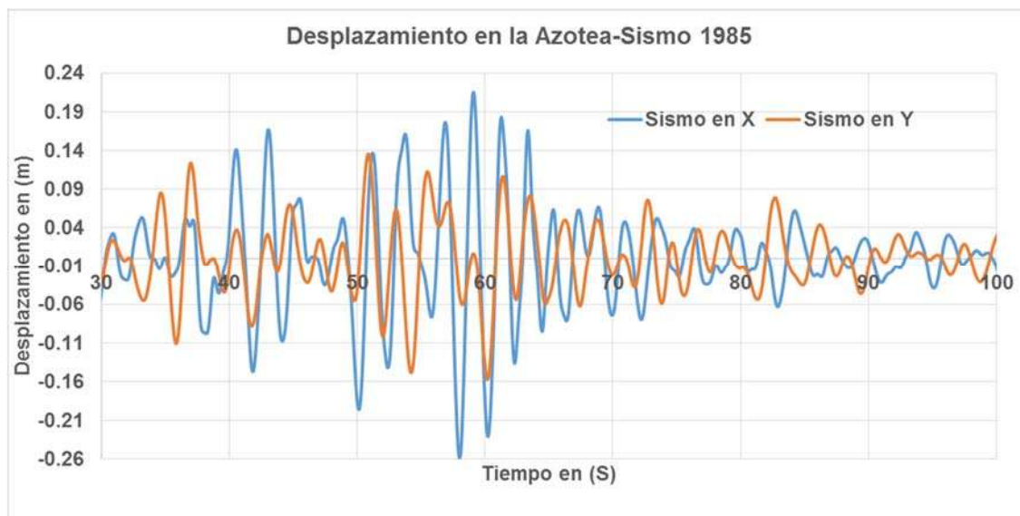
Figura 3.11- Desplazamientos en la azotea, direcciones E-W y N-S, sismo de 1985
