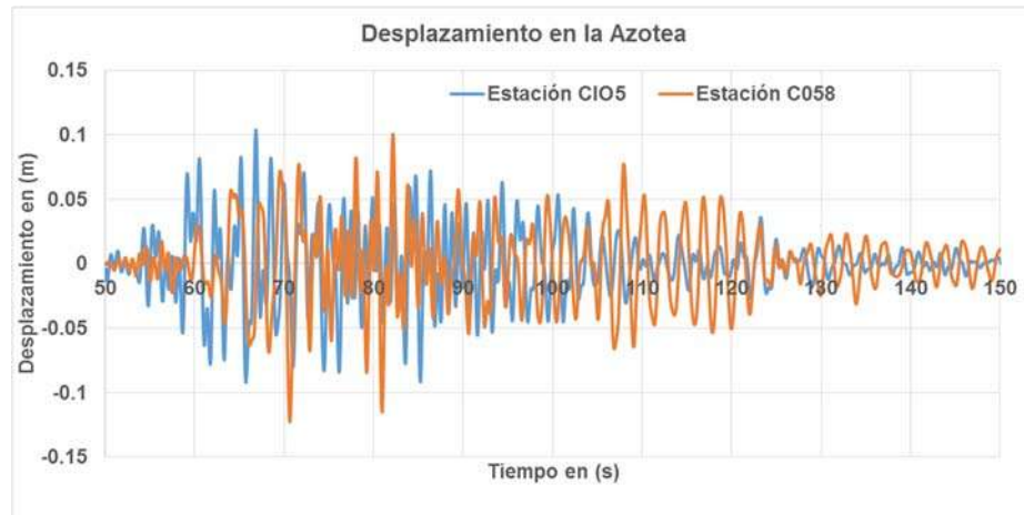
Figura 3.18–Desplazamiento total del edificio, sismo 2017
