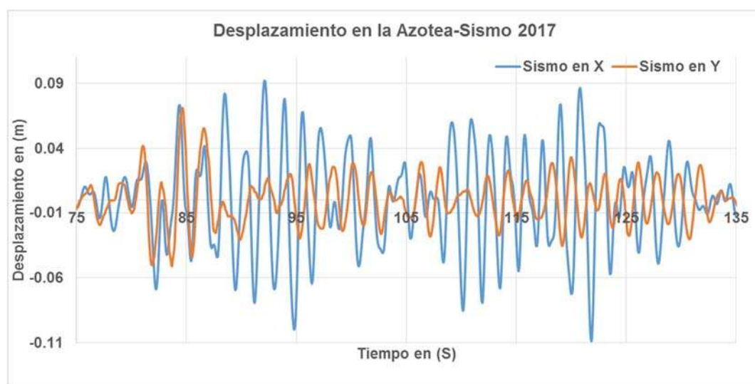
Figura 3.12- Desplazamientos en la azotea, direcciones E-W y N-S, sismo de 2017 registrado en la SCT
