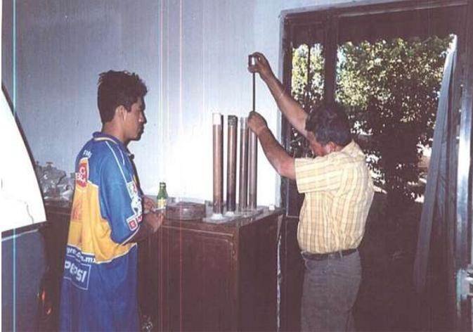
EN LA FOTOGRAFÍA SE OBSERVA LA PRUEBA DE EQUIVALENTE DE ARENA REALIZADA A LOS MATERIALES EXTRAIDOS EN LOS SONDEOS REALIZADOS.
