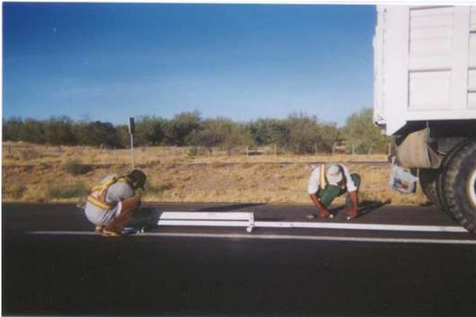
EN LA FOTOGRAFÍA SE OBSERVA LA MEDICION CON VIGA BENKELMAN PARA DETERMINAR LA CAPACIDAD DE CARGA DEL PAVIMENTO EN EL CARRIL DE BAJA VELOCIDAD KM 17+400
