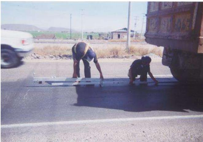
EN LA FOTOGRAFÍA SE OBSERVA LA UTILIZACION DE LA VIGA BENKELMAN PARA DETERMINAR LAS DEFLEXIONES DEL PAVIMENTO EN EL KM 13+800 CARRIL DE BAJA.
