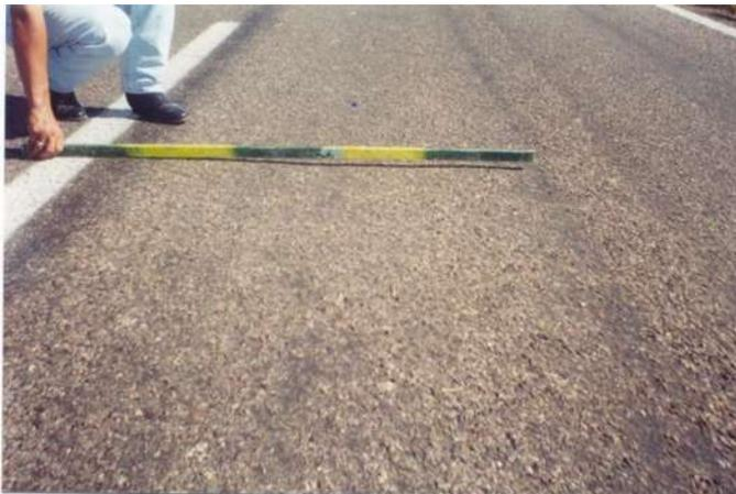
EN LA FOTOGRAFÍA SE OBSERVA LA MEDICION DE RODERAS CON REGLA METALICA EN EL CARRIL DE BAJA VELOCIDAD KM 5+400
