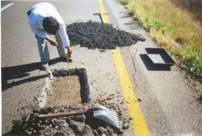
EN LA FOTOGRAFÍA SE OBSERVA LA EXPLORACION DE LA ESTRUCTURA DEL PAVIMENTO MEDIANTE PCA'S EN EL KM 7+300 CARRIL DE BAJA
