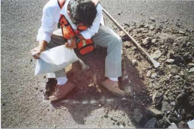
EN LA FOTOGRAFÍA SE OBSERVA PERSONAL DE LABORATORIO DETERMINANDO EL GRADO DE COMPACTACION EN LA CAPA DE BASE HIDRAULICA EN EL KM 2+120 CUERPO B
