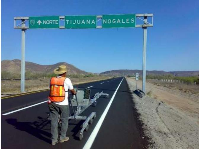
EN LA FOTOGRAFÍA SE OBSERVA LAS MEDICIONES DEL INDICE DE SERVICIO UTILIZANDO EL PERFILGRAFO.
