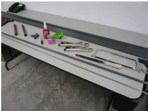
Foto 5. IV.3.2 Vista de las varillas para el armado del extensómetro.
