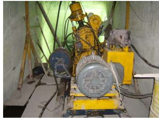
Foto 3 y 4. IV.3 Vista de la perforadora Longyear antes y después de la colocación del motor eléctrico.
