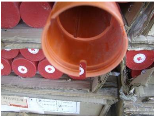
Foto 2. IV.3.5 Vista de las ranuras por donde se desliza el sensor inclinométrico.
