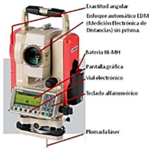
Foto 2. III.3.3.1.2.2.2 Partes de la estación total modelo R300.
