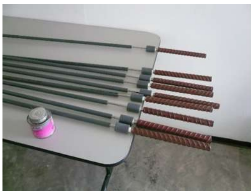
Foto 1. IV.3.2 Vista de las varillas del extensómetro.
