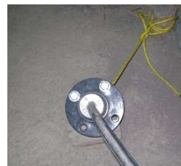
Foto 8. IV.3.2 Extensómetro colocado para el anclaje de las barras.
