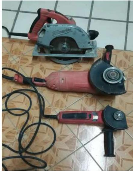
Fotografía 4.1. Guardas de protección en maquinaria.
