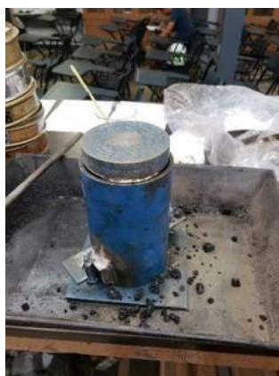
FIGURA 34.- CILINDRO PREPARADO PARA SER COMPACTADO (FOTO E. SALINAS R., 2019)
