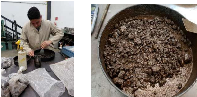
FIGURA 43.- MEZCLADO DE MATERIALES Y EMULSIÓN (FOTO E. SALINAS R., 2019)
