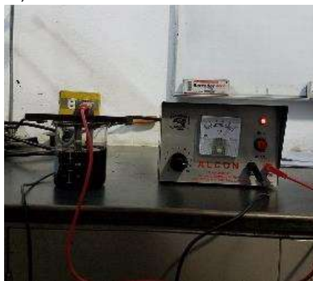
FIGURA 16.- PRUEBA CARGA ELÉCTRICA DE PARTÍCULAS (FOTO E. SALINAS R., 2019)
