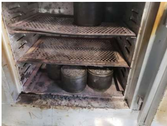
FIGURA 49. - SECADO DE PASTILLA EN HORNO A 60 °C (FOTO E. SALINAS R., 2019)
