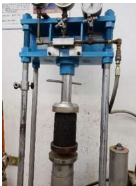
FIGURA 39.- APLICACIÓN DE CARGA A ESPECÍMEN (FOTO E. SALINAS R., 2019)
