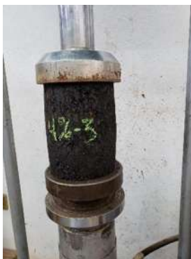
FIGURA 40.- FALLA DE ESPECÍMEN (FOTO E. SALINAS R., 2019)
