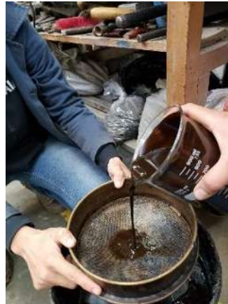
FIGURA 12.- PASO DE EMULSIÓN POR LA MALLA #20 (FOTO E. SALINAS R., 2019)
