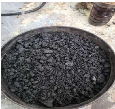
FIGURA 46.- ROMPIMIENTO DE LA MEZCLA (FOTO E. SALINAS R., 2019)
