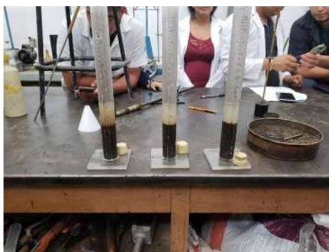
FIGURA 23.- NIVELES DE FINOS (FOTO E. SALINAS R., 2019)
