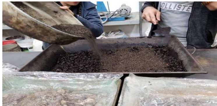
FIGURA 29.- MEZCLADO DE MATERIALES Y EMULSIÓN (FOTO E. SALINAS R., 2019)
