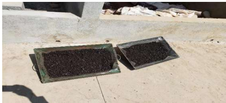
FIGURA 30.- EXPOSICIÓN DE MEZCLAS AL SOL PARA ELIMINACIÓN DE AGUA (FOTO E. SALINAS R., 2019)
