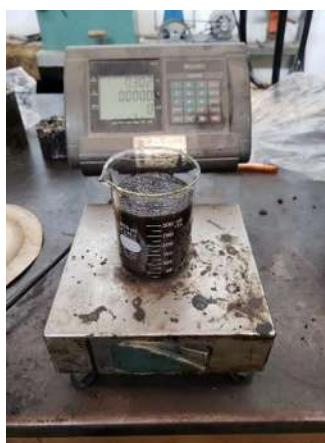
FIGURA 42.- PESADO DE CANTIDAD NECESARIA DE EMULSIÓN (FOTO E. SALINAS R., 2019)
