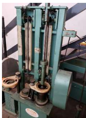
FIGURA 48.- COMPACTACIÓN DE MEZCLA (FOTO E. SALINAS R., 2019)
