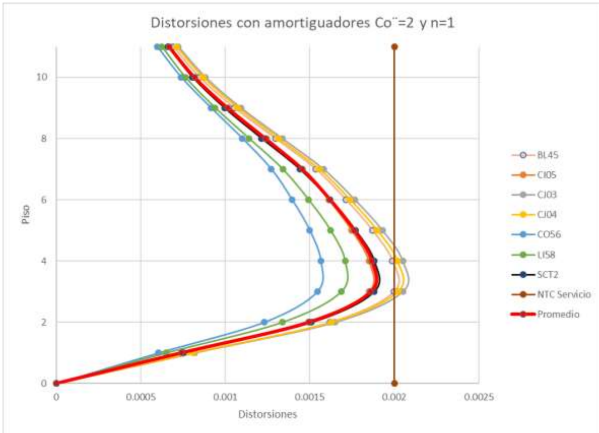
Figura 82: Distorsiones del edificio con prueba 8 de amortiguadores
