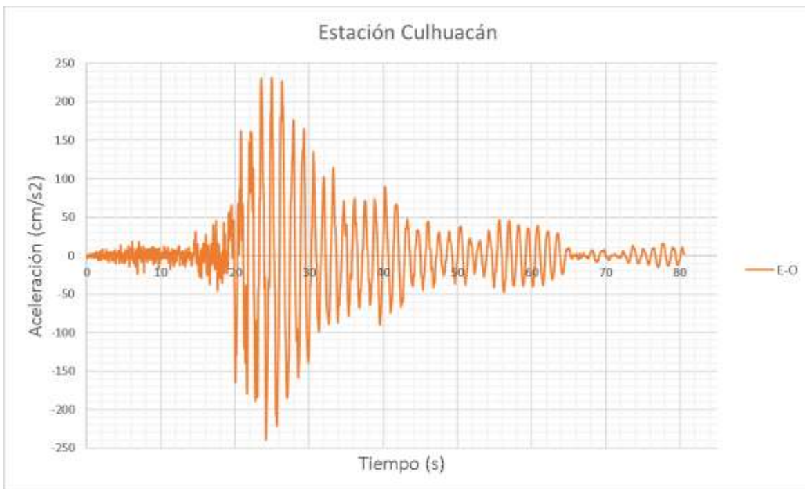
Figura 13: Acelerograma del sismo de 2017 en la estación Culhuacán en dirección Este-Oeste. (Fuente: Torres Álvarez, SMIG, 2017)
