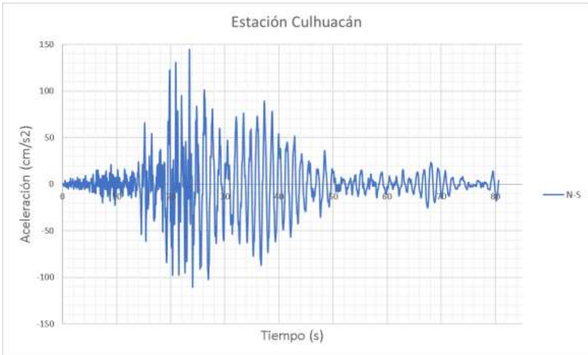
Figura 12: Acelerograma del sismo de 2017 en la estación Culhuacán en dirección Norte-Sur.
