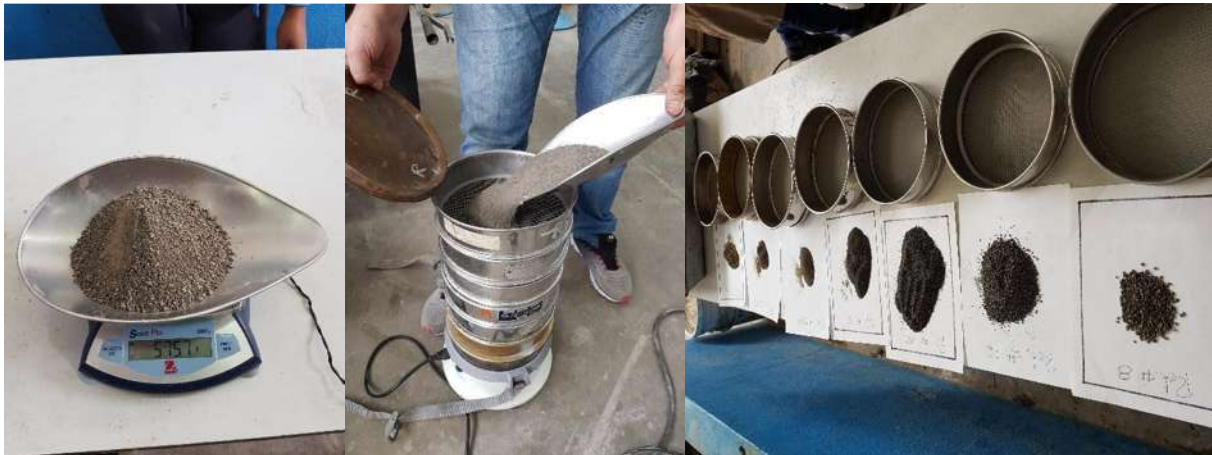
Ilustración 52. Análisis granulométrico en arena
