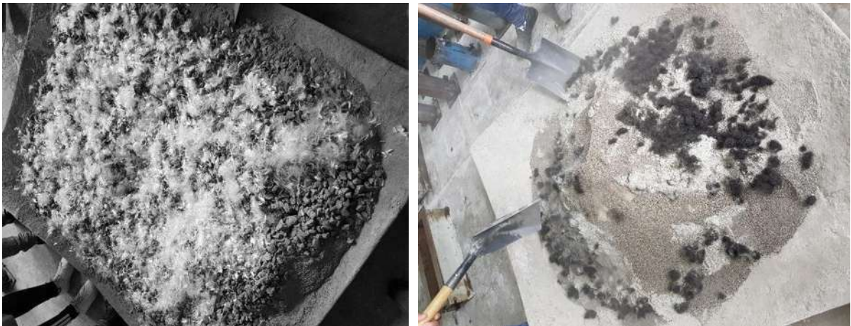
Ilustración 56. adición de micro.fibras de polipropileno y cabello humano
