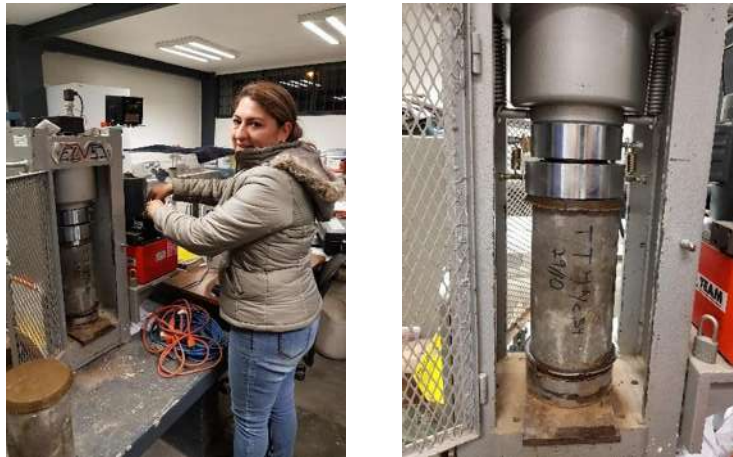
Ilustración 63. Resistencia a la compresión simple
