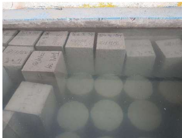
Ilustración 61. Curado del concreto
