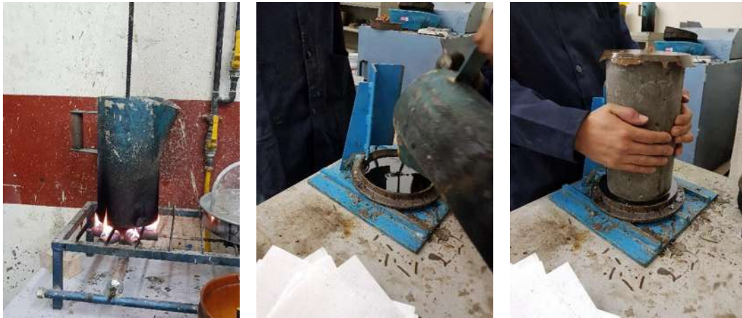
Ilustración 62. Cabeceo de especimene cilindricos
