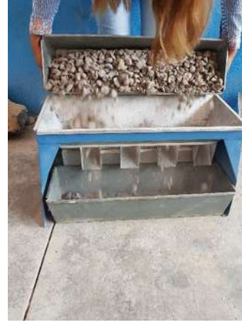
Ilustración 36. Cuarteo Mecánico de grava.
