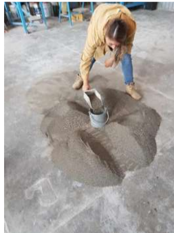
Ilustración 42. Masa volumétrica seca y suelta.
