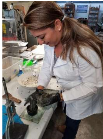
Ilustración 24. Se introduce a presión dentro del anillo cónico
