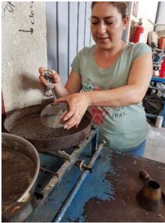
Ilustración 37. Secado y pesado de la arena para % de humedad actual
