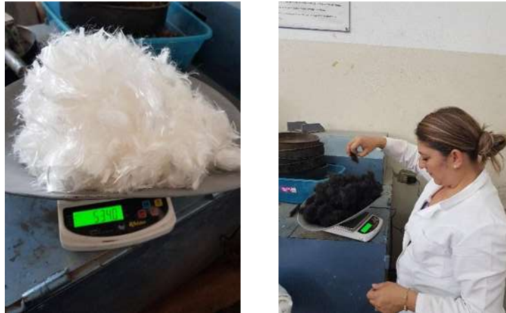
Ilustración 55. Proporcionamiento de micro-fibra de polipropileno y de cabello humano.
