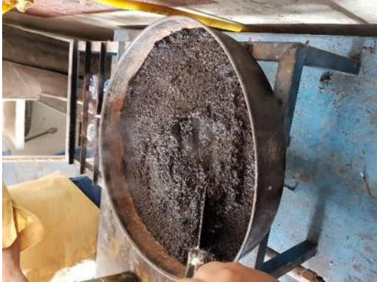
Ilustración 39. Secado superficial de la arena.
