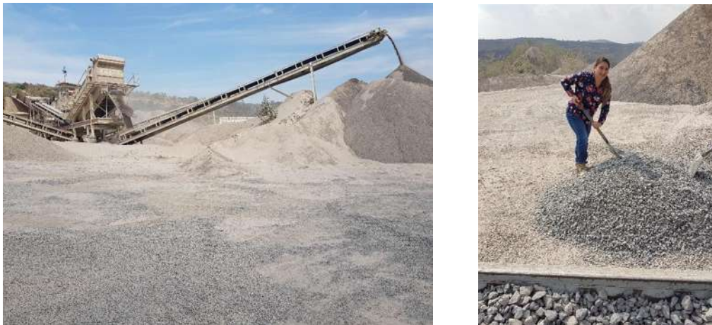
Ilustración 31. Muestreo de los agregados petreos
