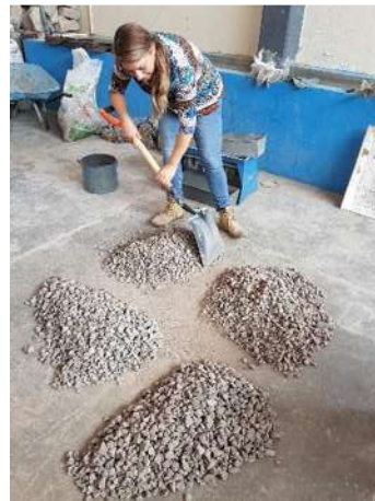
Ilustración 33. Cuarteo Manual de grava.
