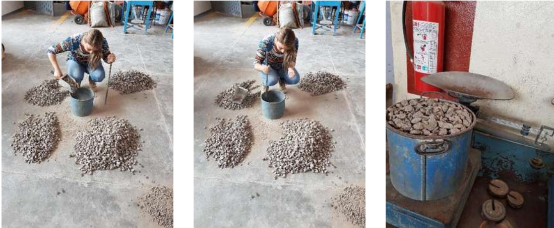
Ilustración 51. Masa volumétrica seca y varillada en grava
