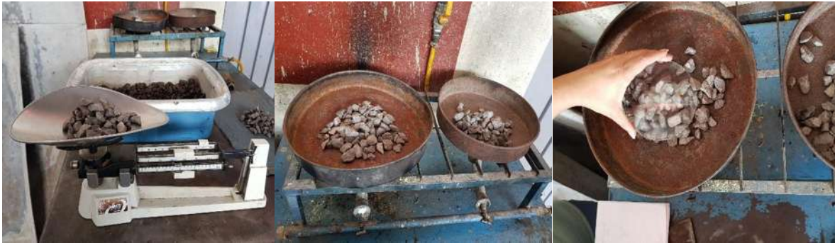
Ilustración 48. Humedad actual en grava
