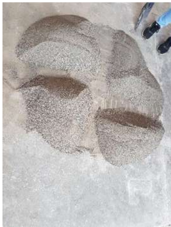
Ilustración 32. Cuarteo Manual de arena.
