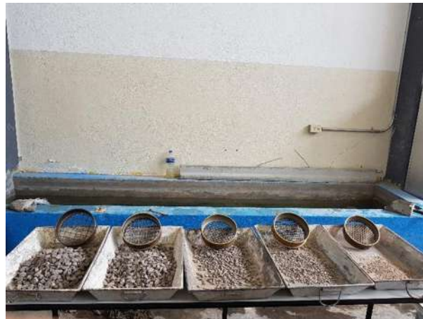
Ilustración 53. análisis granulométrico de grava
