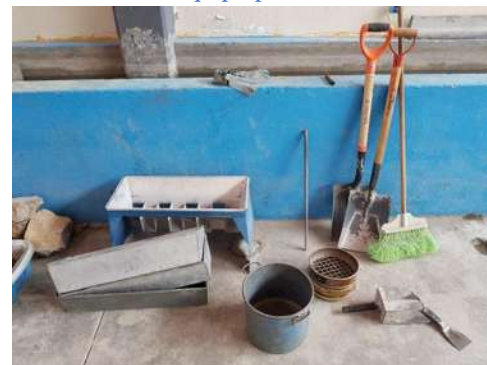
Ilustración 34. Equipo para cuarteo mecánico
