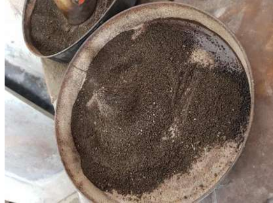
Ilustración 40. Verificación de humedad superficial.
