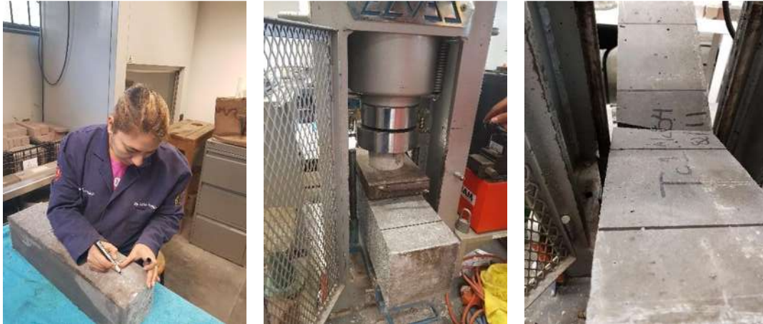
Ilustración 64. Resistencia a la flexión en Vigas
