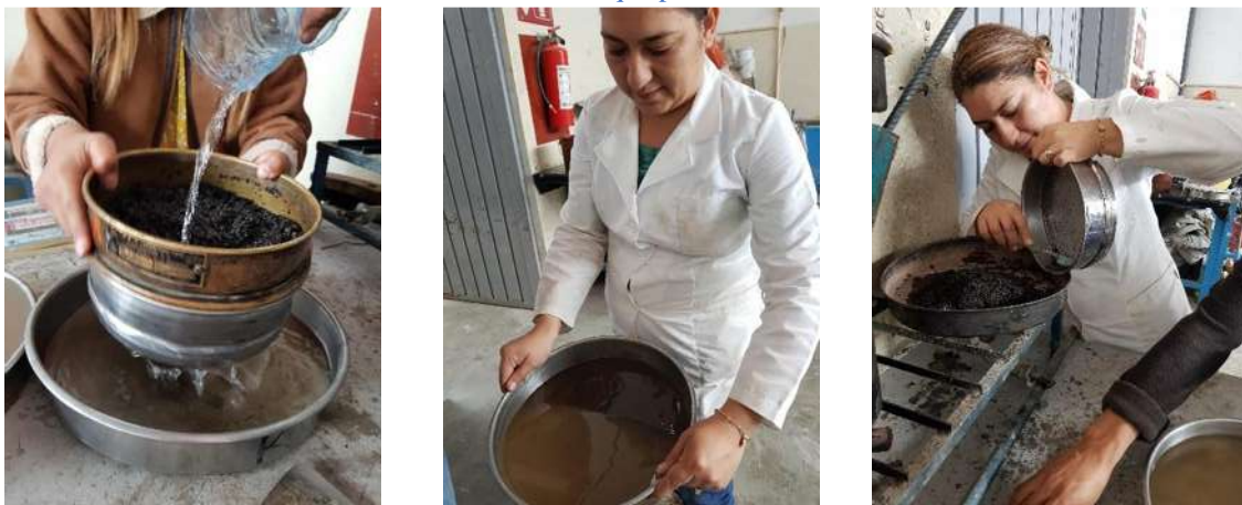
Ilustración 46 Material que pasa la malla N° 200.
