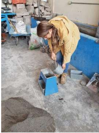
Ilustración 35. Cuarteo Mecánico de arena.
