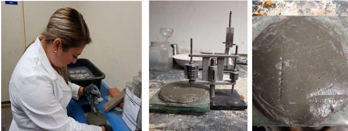
Ilustración 28. Procedimiento tiempo de fraguado con agujas Gillmore
