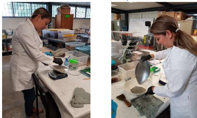
Ilustración 20. Peso del cemento para densidad.
