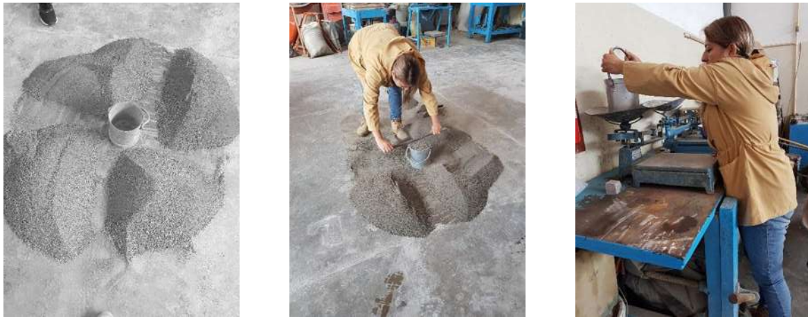
Ilustración 43. Masa Volumétrica Seca Varillada
