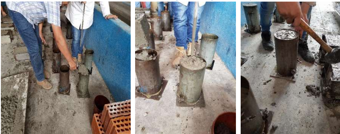
Ilustración 60. Elaboración de especímenes prismáticos y cilíndricos
