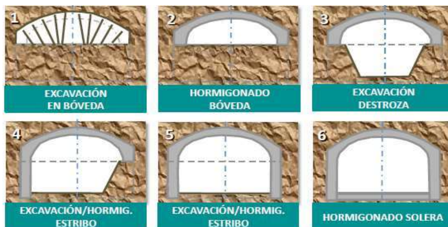
Imagen 10. Proceso de excavación del Método Belga [9].
