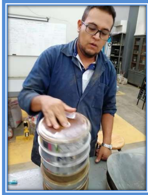
Figura 13. Cribado de material fino, Villanueva. 2019
