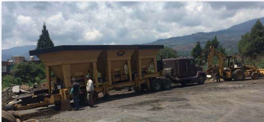
Figura 5.2.1 Colocación de los neumáticos a las tolvas. Fuente: Elaboración propia
