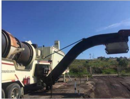
Figura 4.3.16 Elevador de arrastre para la salida de la mezcla. Fuente: Elaboración propia
