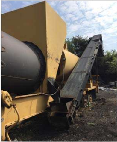
Figura 5.1.8Caja de golpe en la planta asfáltica. Fuente: Elaboración propia
