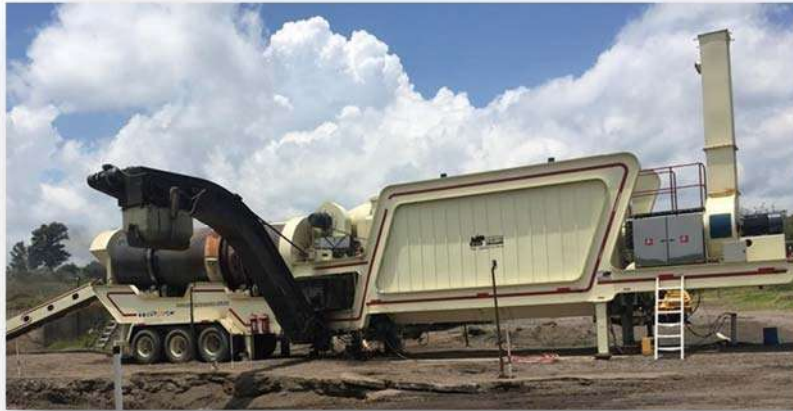
Figura 4.3.19 Planta asfáltica TRIASO. Fuente: Elaboración propia
