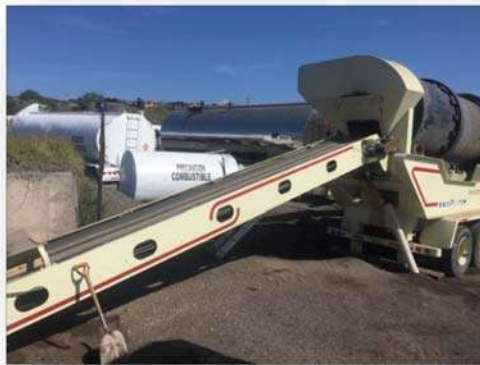
Figura 4.3.17 Banda de alimentación de la planta. Fuente: Elaboración propia
