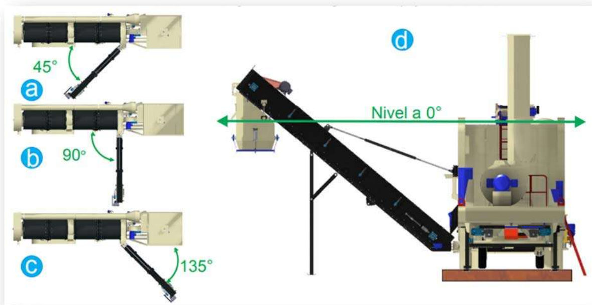
Figura 5.3.11 Elevador de salida de mezcla. Fuente: www.triaso.com.mx
