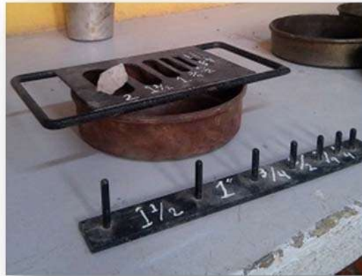
Figura 3.2.1.3 Calibrador de espesor y longitud para identificar las partículas lajeadas y alargadas. Fuente: www.laboratorioevanheslp.com
