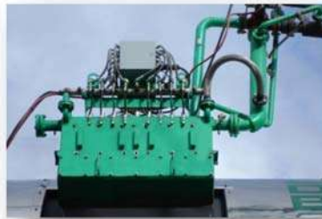
Figura 4.3.29 Sistema Green Double Barrel (Sistema Verde). Fuente: www.astecinc.com
