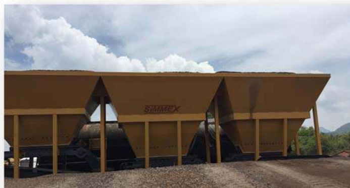
Figura 4.3.10 Tolvas de almacenamiento para materiales pétreos. Fuente: Elaboración propia
