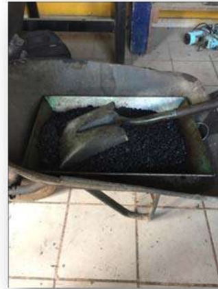
Figura 4.3.43 Muestra representativa de mezcla asfáltica en caliente producida en planta. Fuente: Elaboración propia
