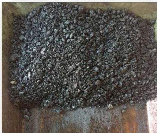
Figura 4.3.23 Mezcla asfáltica en caliente producida en planta. Fuente: Elaboración propia
