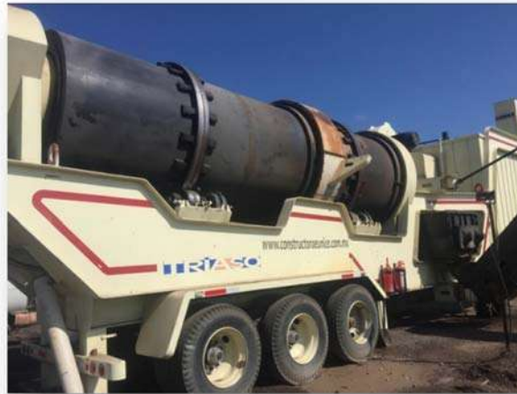
Figura 4.3.15 Tambor mezclador de planta asfáltica. Fuente: Elaboración propia
