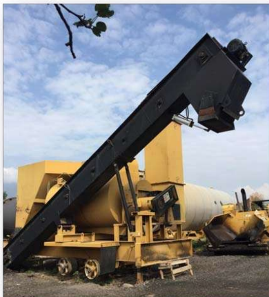
Figura 5.1.13 Elevador montado donde se descarga la mezcla. Fuente: Elaboración propia.
