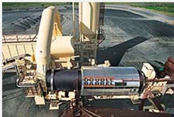
Figura 4.3.1.11 Planta continua con tambor secador-mezclador DoubleBarrel. www.astecinc.com
