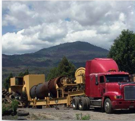
Figura 5.2.3 Transporte de tambor secador. Fuente: Elaboración propia
