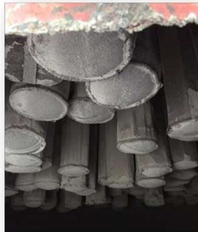
Figura 4.3.40 Bolsas en el interior del Bag house. Fuente: Elaboración propia
