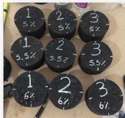
Figura 5.4.3 Pastillas elaboradas en laboratorio para diseño de mezcla. Fuente: Elaboración propia
