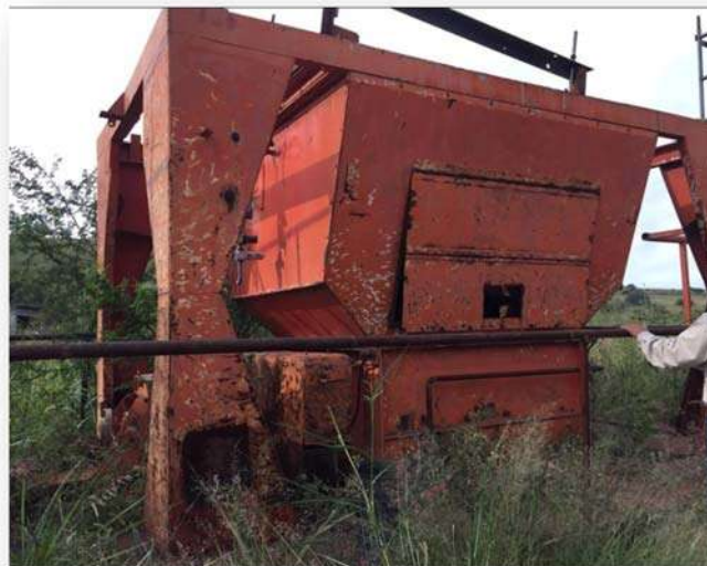
Figura 4.3.8 Unidad de mezclado o amasadora. Fuente: Elaboración propia
