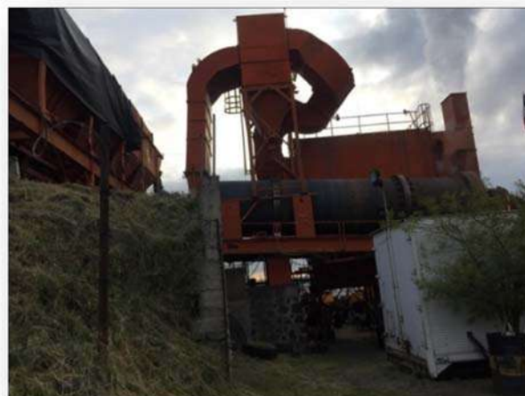
Figura 4.3.38 Ciclón recolector de polvos. Fuente: Elaboración propia
