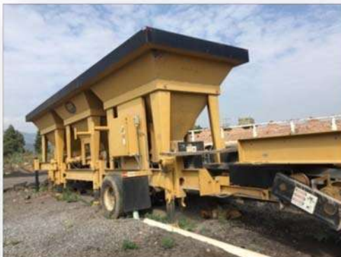
Figura 5.1.3 Tolvas de almacenamiento. Fuente: Elaboración propia
