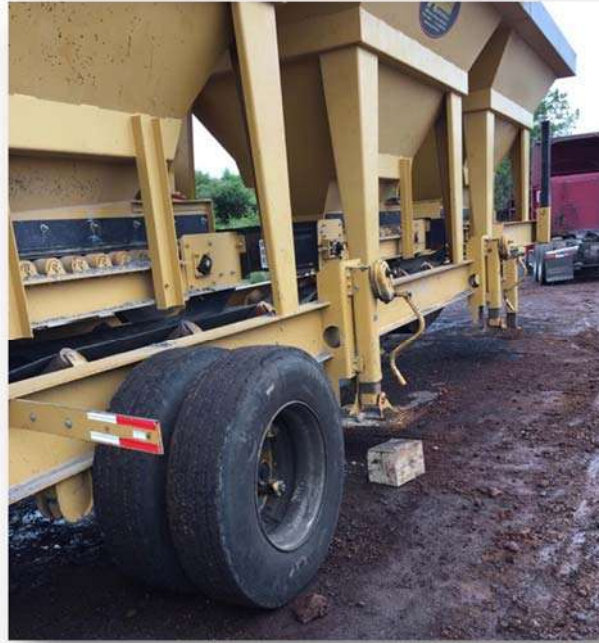
Figura 5.3.3.10 Colocación de las tolvas. Fuente: Elaboración propia
