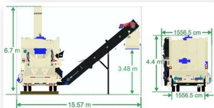
Figura 4.1.14 Dimensiones generales de un elevador de descarga. Fuente: www.triaso.com.mx
