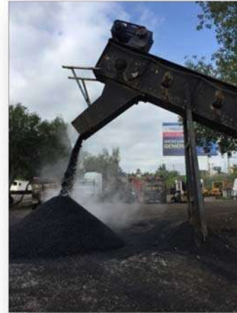
Figura 4.3.34 Mezcla asfáltica producida en planta. Fuente: Elaboración propia
