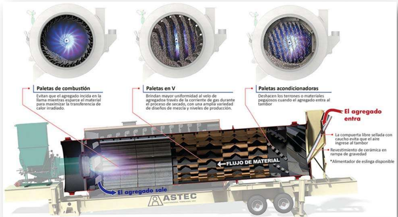
Figura 4.3.26 Proceso de secado en el tambor Double Barrel interior. Fuente: www.astecinc.com
