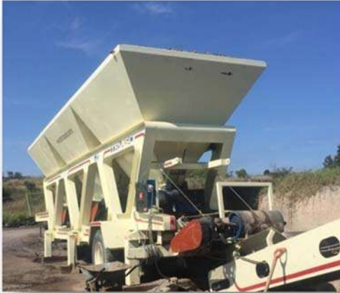
Figura 4.3.18 Tolvas de almacenamiento. Fuente: Elaboración propia
