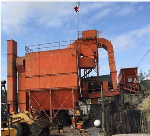
Figura 4.3.39 Colector Bag house o caja de bolsas. Fuente: Elaboración propia
