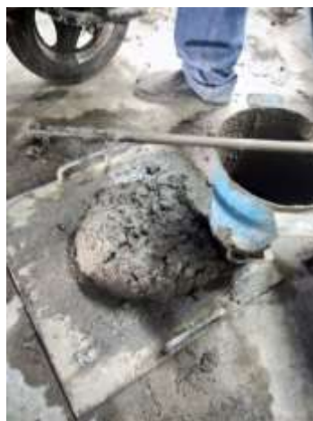
Ilustración 49. Revenimiento en mezcla "Aditivo" (Fotografía Joana Enríquez).
