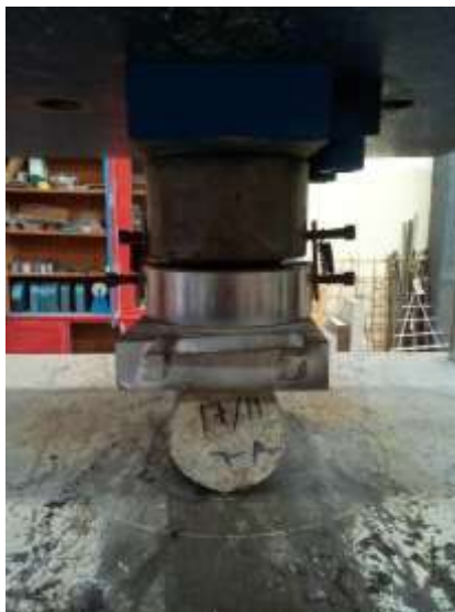
Ilustración 39. Ensayo de espécimen a tensión indirecta. (Fotografía Joana Enríquez).
