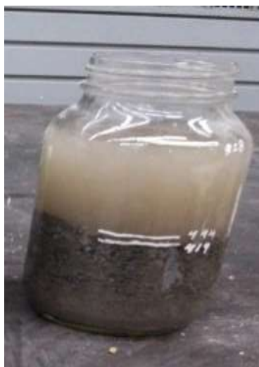
Ilustración 20. Llenado del recipiente con material y agua hasta las marcas establecidas (Fotografía Joana Enríquez).
