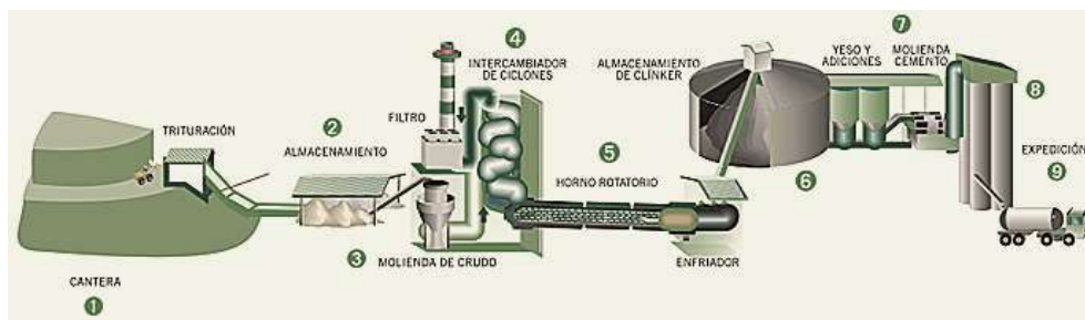
Ilustración 1. Esquema del proceso de producción del cemento (Fundación Laboral del Cemento y Medio ambiente, 2013).
