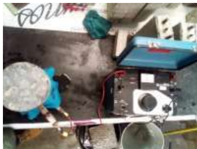
Ilustración 36. Equipo utilizado en la determinación de resistividad eléctrica (Fotografía Joana Enríquez).
