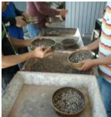
Ilustración 33. Cribado del material para la determinación de la granulometría (Fotografía Joana Enríquez).
