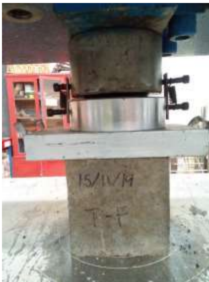
Ilustración 37. Aplicación de carga para prueba de compresión en especímenes prismáticos. (Fotografía Joana Enríquez).
