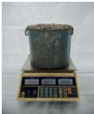
Ilustración 31. Determinación del peso total de la muestra (Fotografía Joana Enríquez).
