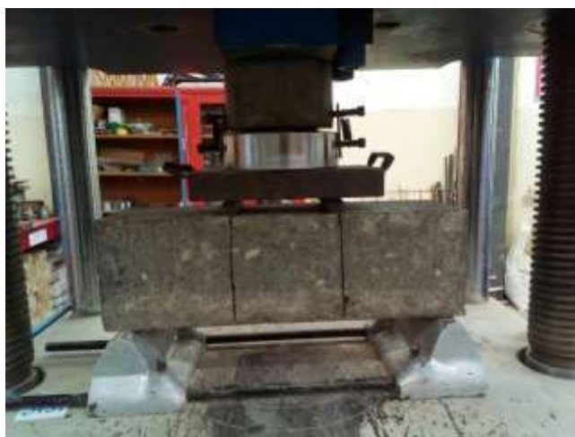
Ilustración 38. Especimen sometido a la prueba de flexión. (Fotografía Joana Enríquez).
