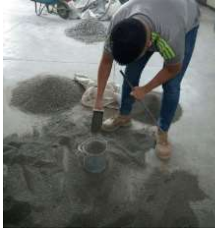
Ilustración 14. Llenado y varillado de MVSV (Fotografía Joana Enríquez).
