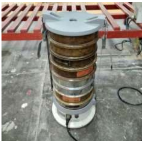
Ilustración 16. Agitado mecánico (Raf-tap) (Fotografía Joana Enríquez).
