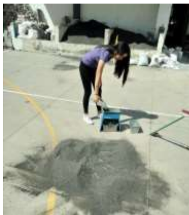
Ilustración 7. Agregando el material al divisor de muestras mecánico (Fotografía Joana Enríquez).
