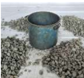
Ilustración 30. Material cuarteado para la determinación de masas volumétricas (Fotografía Joana Enríquez).
