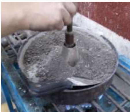
Ilustración 12. Secado superficial del agregado con ayuda del cono troncocónico (Fotografía Joana Enríquez).
