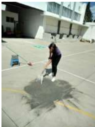
Ilustración 11. División de la muestra en 4 partes iguales (Fotografía Joana Enríquez).
