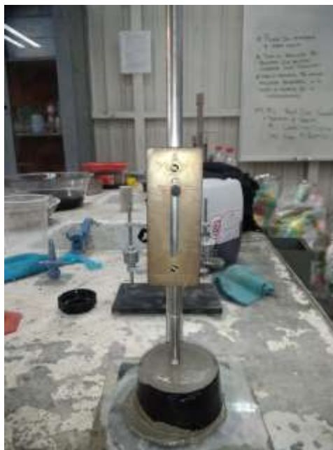
Ilustración 4. Penetración de la aguja (Fotografía Joana Enríquez).
