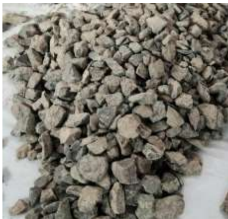
Ilustración 26 Cuarteo del material para obtener una muestra lo más homogénea posible (Fotografía Joana Enríquez).
