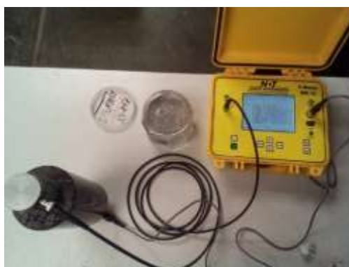
Ilustración 35. Prueba Velocidad de Pulso Ultrasónico (Fotografía Joana Enríquez).
