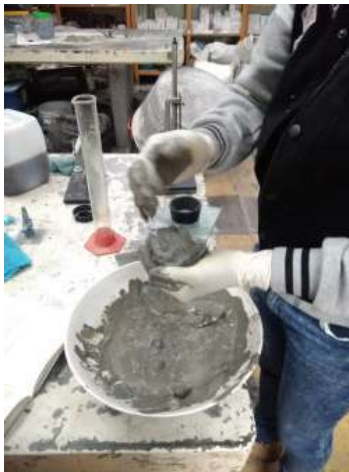
Ilustración 3. Mezclado de la pasta con las manos (Fotografía Joana Enríquez).
