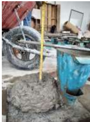
Ilustración 43. Revenimiento de mezcla “Fibra” (Fotografía Joana Enríquez).
