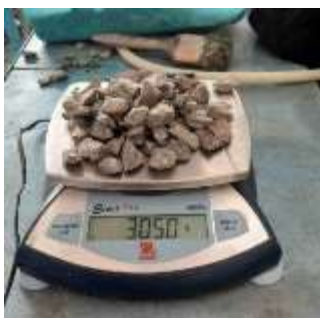
Ilustración 27 Pesado de la muestra representativa de grava (Fotografía Joana Enríquez).
