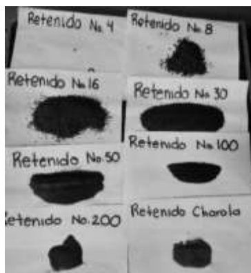
Ilustración 17. Separación de los retenidos en cada malla (Fotografía Joana Enríquez).
