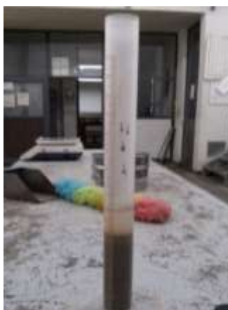
Ilustración 25. Se deja reposar el material en la probeta durante 20 minutos (Fotografía L. C.).
