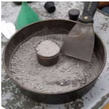
Ilustración 24. Llenado de capsula (Fotografía L. C.).
