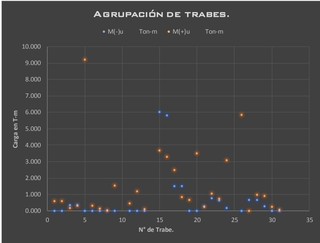
Figura 23.- Agrupación de trabes en función de su momento máximo.
