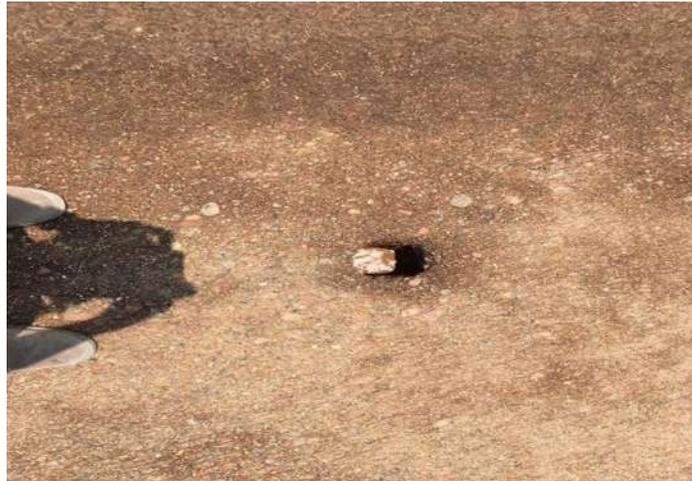
*Fotografía No. 2.10. Fotografía de la perforación sobre la base para prueba de compactación.*
