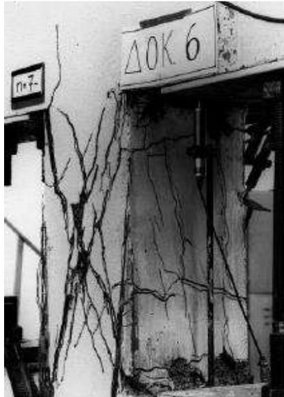
Figura 2.1 Patrón de agrietamiento típico en columnas “cortas” de concreto reforzado que fallan por cortante (Moretti y Tassios, 2007)
