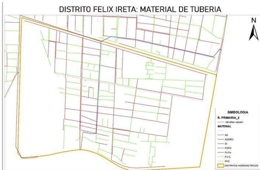
Figura 15. Material de la tubería en el distrito hidrométrico Félix Ireta
