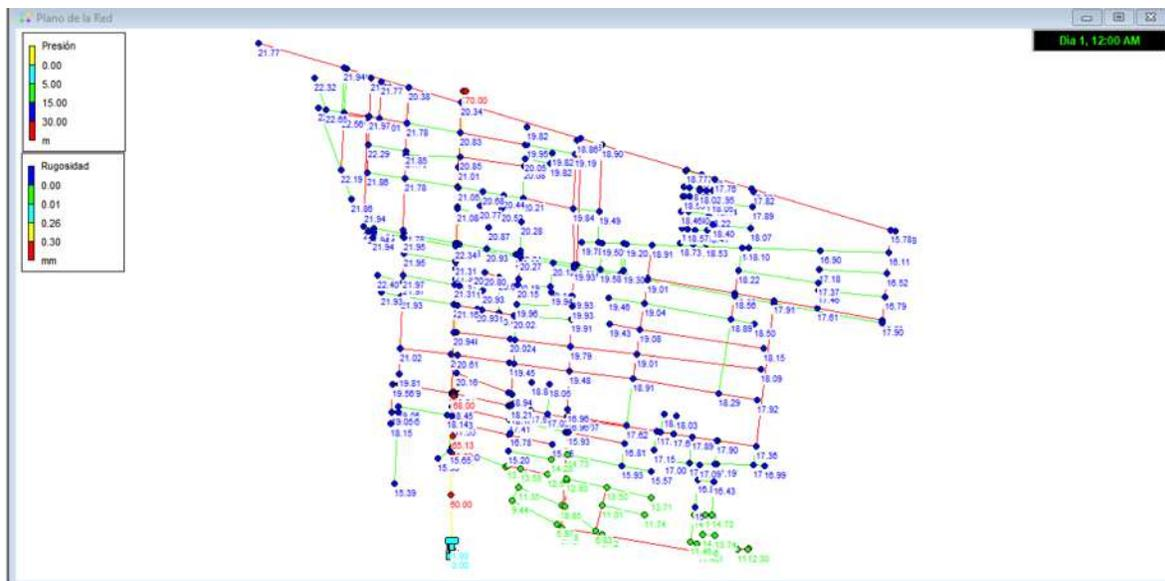
Figura 19. Simulación de la condición real de la red en la hora de menor demanda
