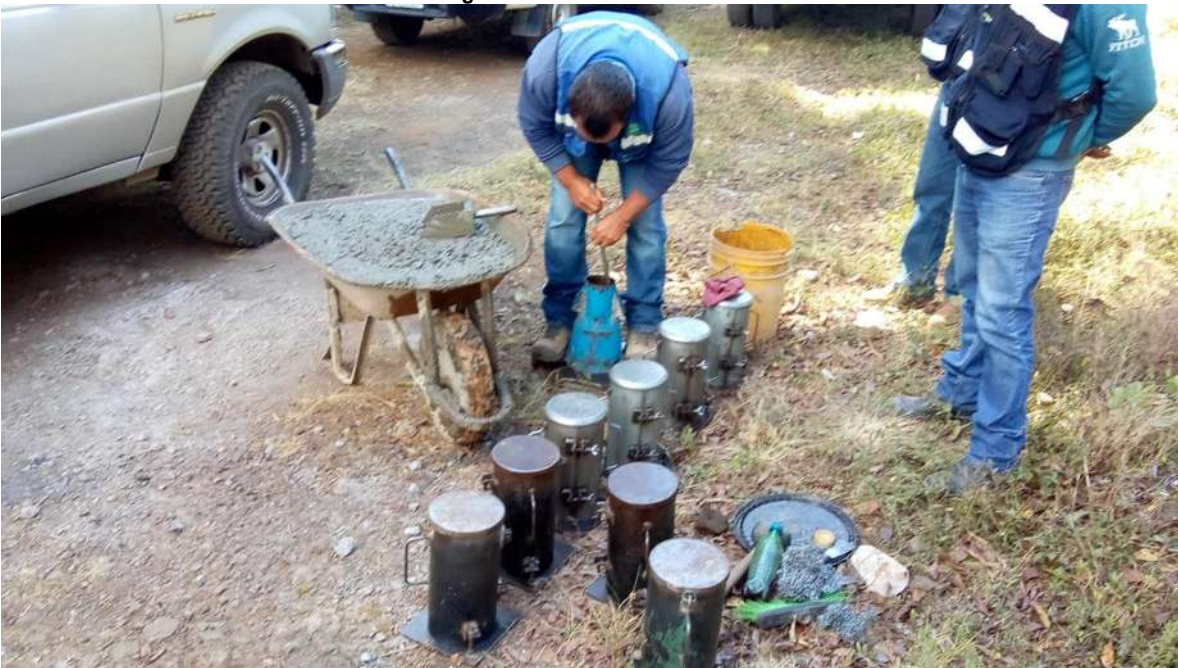
Figura 37. Revisión del concreto fresco y elaboración de especímenes para ensayos de resistencia.
