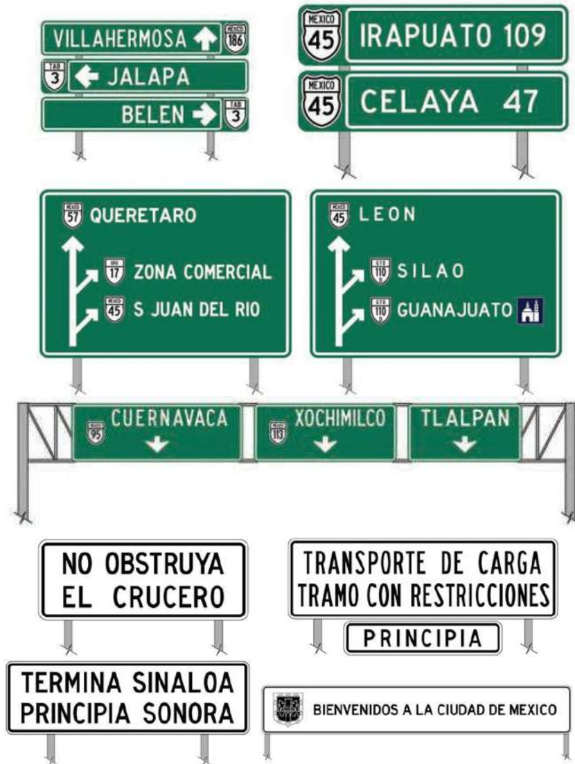
Figura 1.53 Ejemplificación de señalamiento de información general y de destino. (SCT S. , Manual de Señalización Vial y Dispositivos de Seguridad, 2014).
