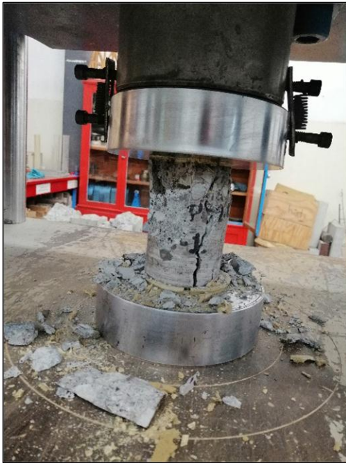
Figura 1.92 Especímen ensayado a compresión. (Granados Ceras, 2020).
