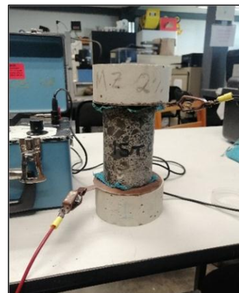
Figura 1.85 Realizando prueba de resistividad eléctrica. (Granados Ceras, 2020).
