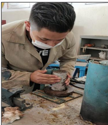
Figura 1.90 Proceso de cabeceo de núcleos de concreto. (Granados Ceras, 2020).
