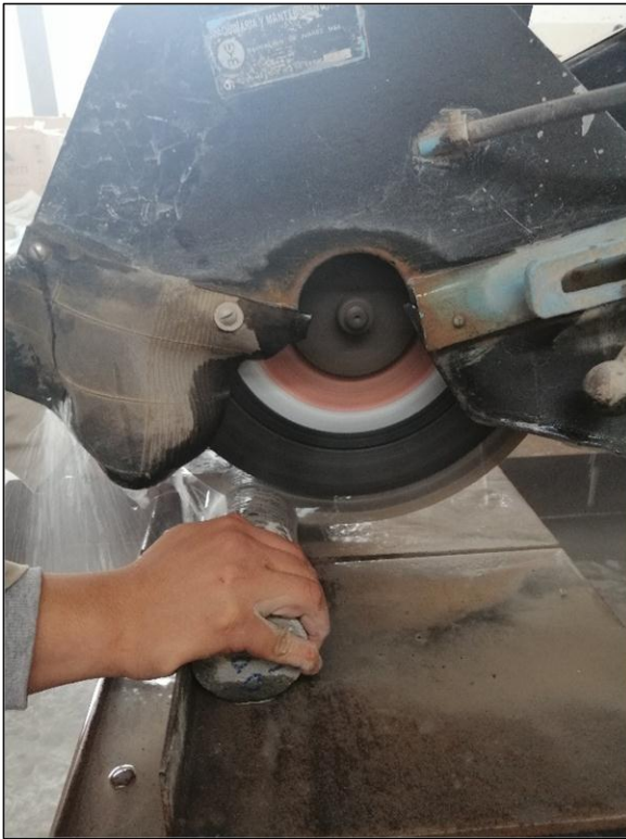
Figura 1. 83 Realizando cortes en corazones. (Granados Ceras, 2020)
