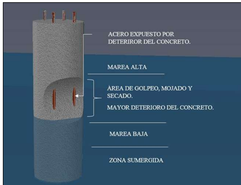
Figura 1.37. Columna de concreto con acero de refuerzo expuesto. (Granados Ceras, 2020).
