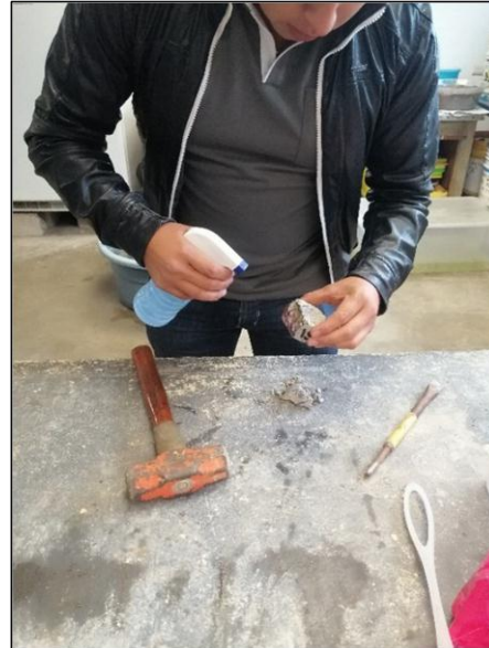
Figura 1. 89 Rociando Fenolftaleína en rodajas de núcleos de concreto.. (Granados Ceras, 2020).
