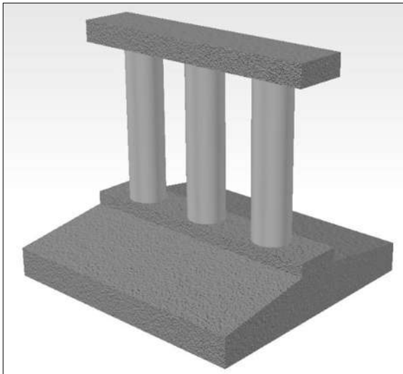
Figura 1.26 Pila tipo pórtico. (Granados Ceras, 2020).
