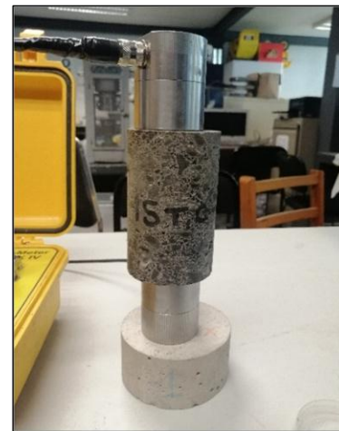
Figura 1. 87 Realizando prueba de Velocidad de pulso. (Granados Ceras, 2020).
