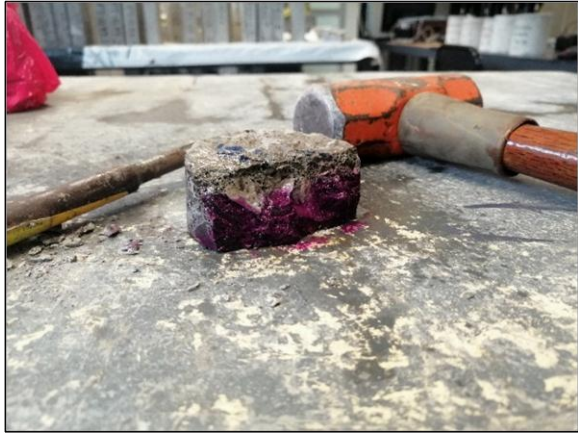
Figura 1. 88 Concreto reaccionando con el indicador acido-base. (Granados Ceras, 2020).
