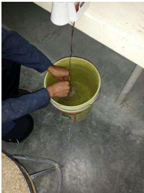
Ilustración 17 Cálculo de la gravedad específica. Método de inmersión. Por el autor.
