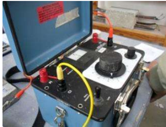
Ilustración 21 Equipo utilizado para determinar la resistividad eléctrica.
