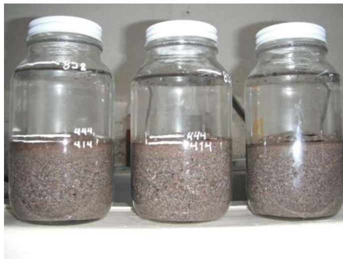
Ilustración 16 Análisis de contenido de finos.
