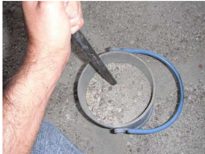
Ilustración 14 Varillado de la arena en la prueba de MVSV
