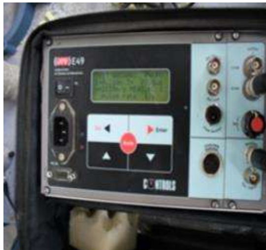
Ilustración 20 Equipo para medir la velocidad de pulso ultrasónico (ASTM-C-597,2009)
