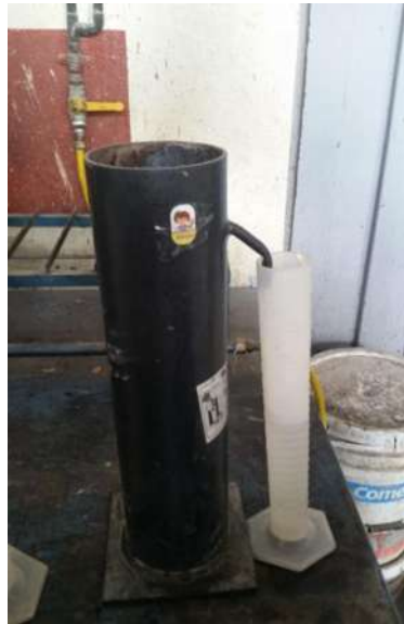
Ilustración 9 Determinación de la densidad de la grava por medio del volumen desplazado en el picnómetro
