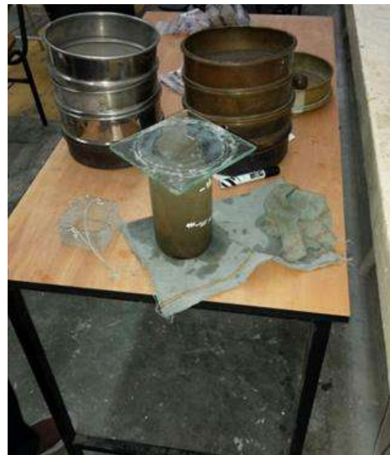
Ilustración 18 Cálculo de la gravedad específica. Método de inmersión. Por el autor.
