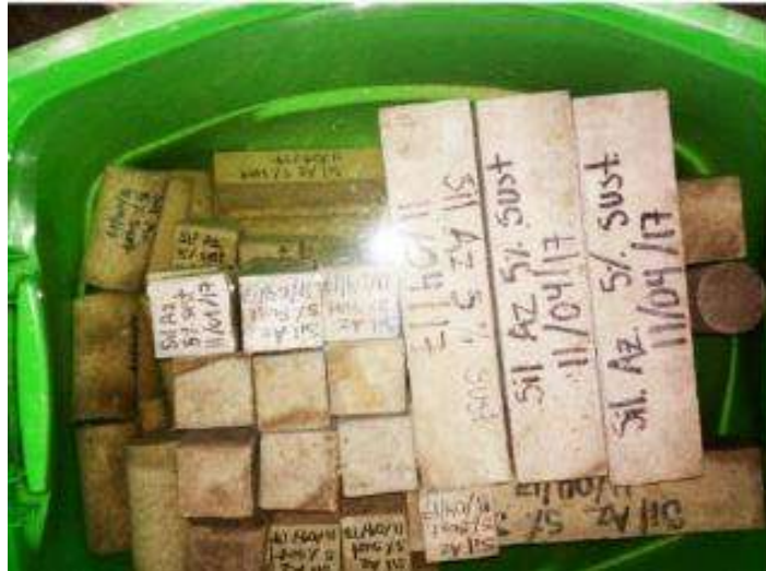
Ilustración 41 Curado de los especímenes por sumersión. (Santillán Barragán, 2017)
