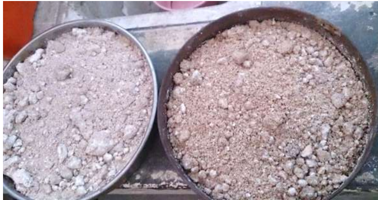
Ilustración 8 Secado a la intemperie de la sílice (Vaca Arciga, 2017)
