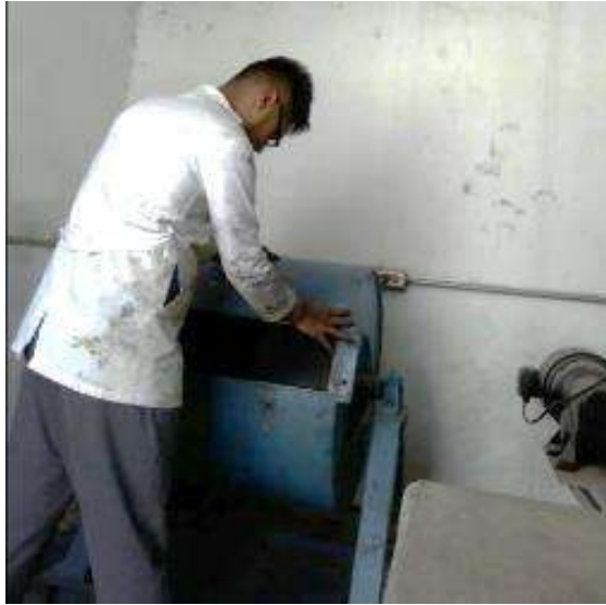
Ilustración 9 Trituración de Sílice en la Máquina de desgaste de Los Ángeles. (Vaca Arciga, 2017)
