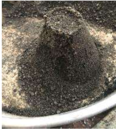
Ilustración 16 Secado superficial de la muestra mediante el molde troncocónico. (Vaca Arciga, 2017)
