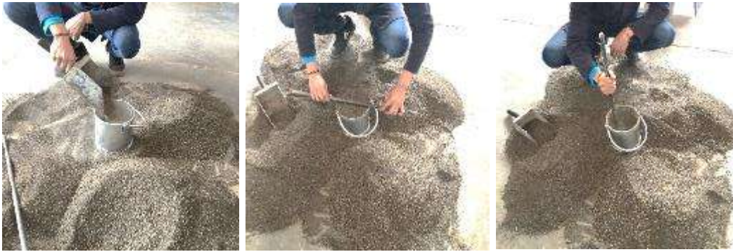
Ilustración 18 Realización de la prueba de MVSV (Báez Ángel, 2018)
