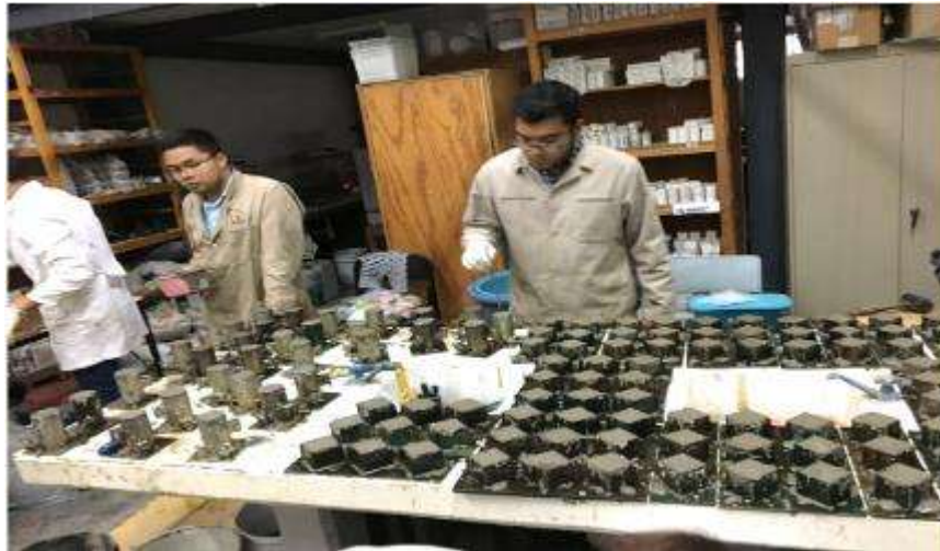
Ilustración 35 Elaboración de los especímenes. (Báez Ángel, 2017)
