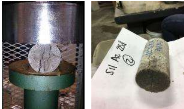
Ilustración 49 Prueba de tensión indirecta en cilindros. (Báez Ángel, 2017)
