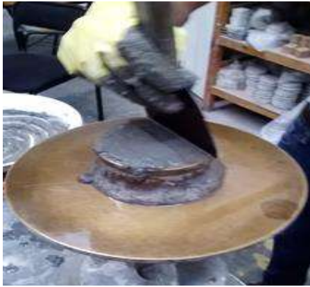
Ilustración 29 Enrasado con una espátula el exceso de mortero. (VELÁZQUEZ ROBLERO, 2017)
