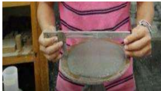
Ilustración 31 Toma de mediciones para determinar la fluidez (Vaca Arciga, 2017)
