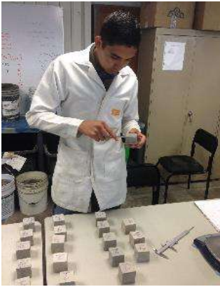
Ilustración 46 Prueba de compresión simple en cubos. (Carreón Eduardo, 2020)
