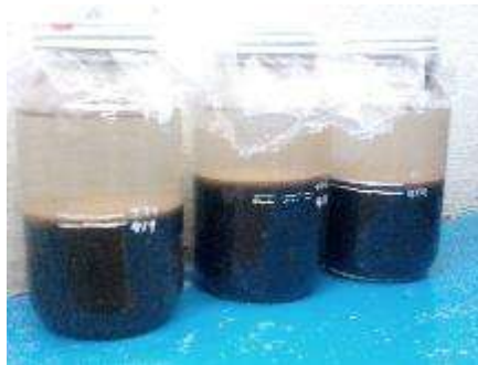
Ilustración 23 Prueba de sedimentación. (Báez Ángel, 2017)
