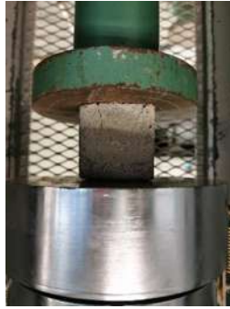
Ilustración 46 Prueba de compresión simple en cubos. (Carreón Eduardo, 2020)
