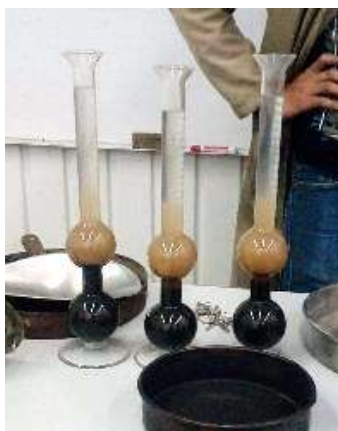
Ilustración 25 Determinación de la densidad de la arena por medio del frasco de Chapman (Báez Ángel, 2017)
