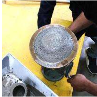
Ilustración 30 Expansión de la mezcla de forma manual haciendo girar la leva. (VACA ARCIGA, 2017)
