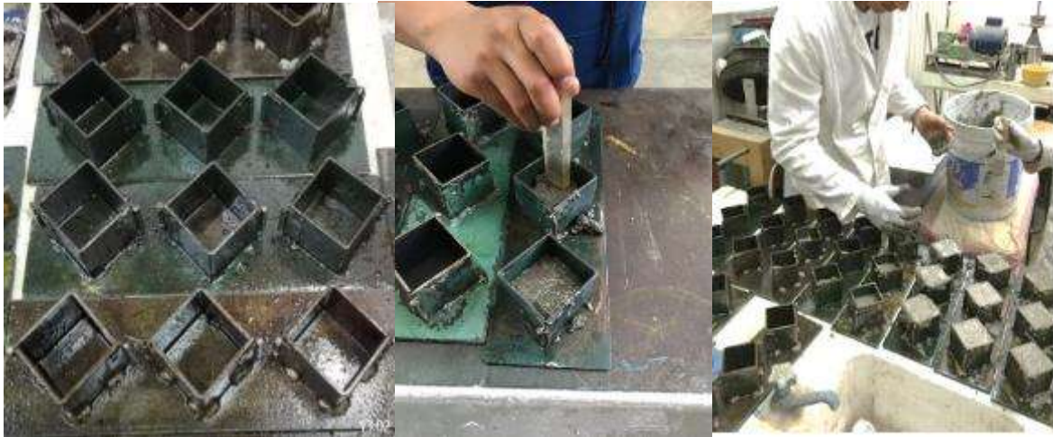
Ilustración 37 Moldes, llenado y colado de especímenes cúbicos (Báez Ángel, 2017)
