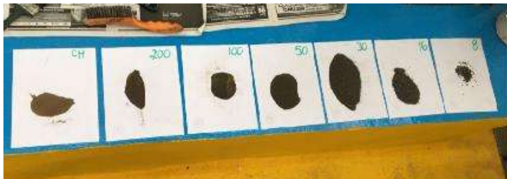
Ilustración 19 Material retenido de las diferentes mallas una vez pesadas. (Vaca Arciga, 2017)
