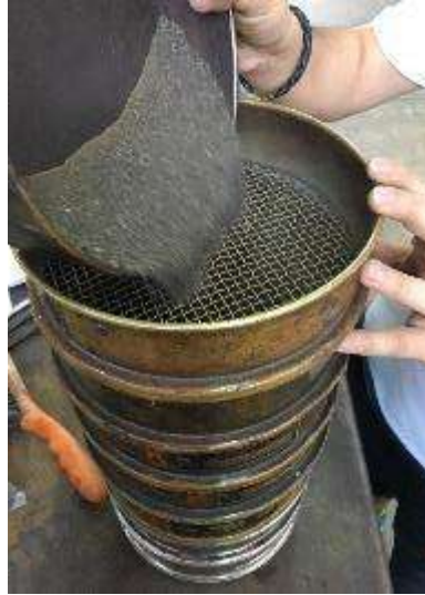
Ilustración 20 Vaciado de la muestra representativa de arena dentro de las mallas. (VACA ARCIGA, 2017)
