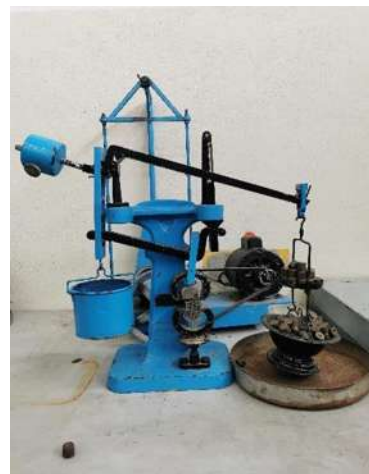
Ilustración 50 Prueba de tensión directa en briquetas. (Carreón Eduardo, 2020)
