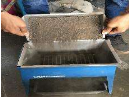
Ilustración 13 Cuarteo por cuarteador mecánico. (Báez Ángel, 2018)
