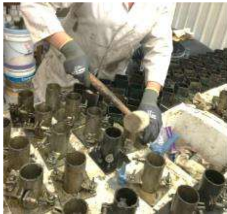
Ilustración 39 Elaboración de cilindros. (Santillán Barragán, 2017)
