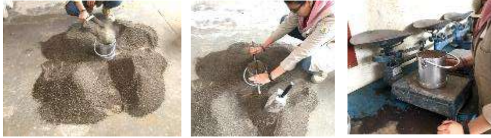
Ilustración 17 Realización de la prueba de MVSS (Báez Ángel, 2018)
