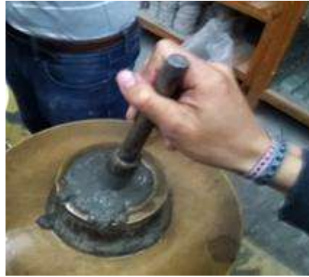
Ilustración 28 Compactación de la pasta. (VACA ARCIGA, 2017)
