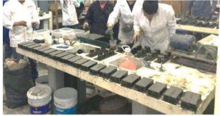
Ilustración 38 Moldes y colado de prismas (Báez Ángel, 2017).
