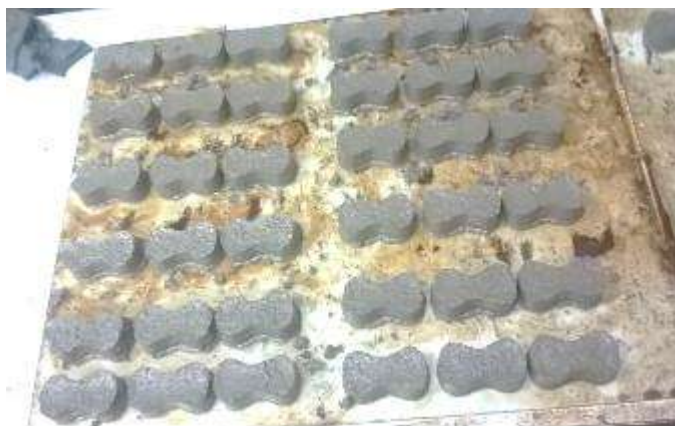
Ilustración 40 Elaboración de briquetas. (Báez Ángel, 2017)
