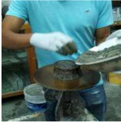
Ilustración 27 Llenado del molde de bronce en dos capas. (Báez Ángel, 2017)
