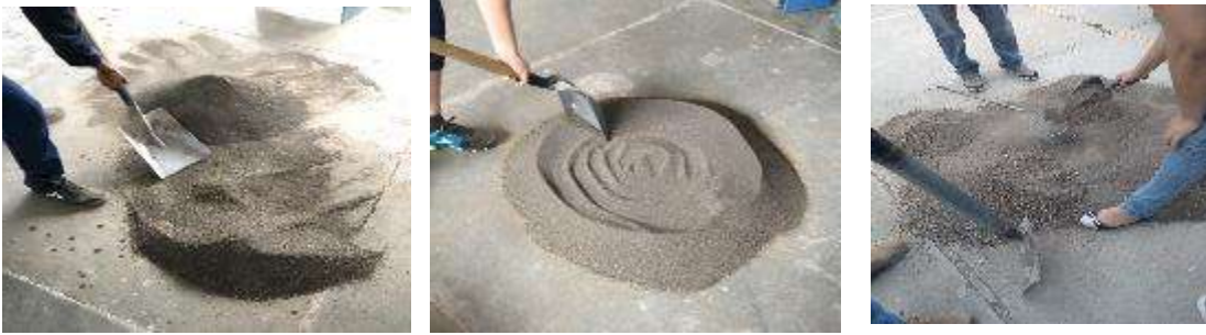
Ilustración 14 Cuarteo Manual (Vaca Arciga, 2017)
