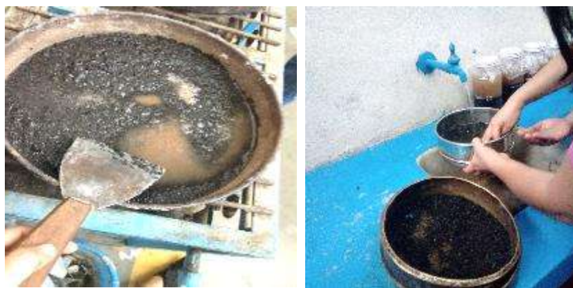
Ilustración 24 Prueba de terrones de arcilla. (Báez Ángel, 2017)
