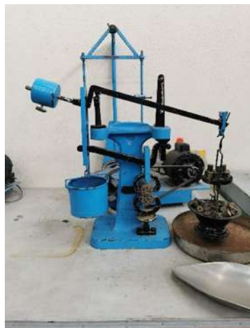
Ilustración 50 Prueba de tensión directa en briquetas. (Carreón Eduardo, 2020)
