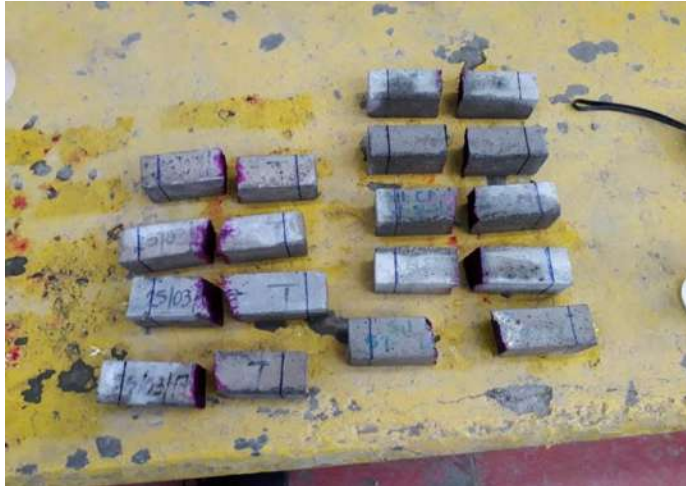
Ilustración 53 Muestras con fenolftaleína aplicada a los especímenes. (Carreón Eduardo, 2020)
