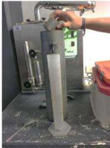
Ilustración 42 Prueba de densidad. (VACA ARCIGA, 2017)
