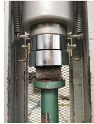
Ilustración 46 Prueba de compresión simple en cubos. (Carreón Eduardo, 2020)
