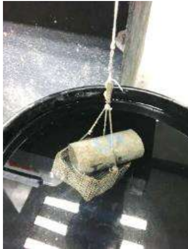
Ilustración 43 Prueba de Gravedad Específica. (Báez Ángel, 2017)
