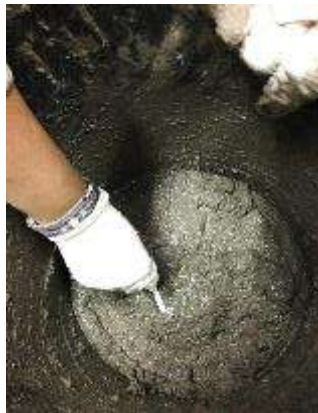
Ilustración 32 Papel indicador puesto en contacto con el mortero (Báez Ángel, 2018)
