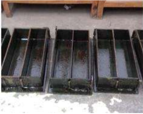
Ilustración 38 Moldes y colado de prismas (Báez Ángel, 2017).
