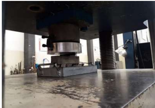
Ilustración 47 Especímenes sometidos a flexión. (Carreón Eduardo, 2020)
