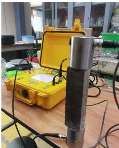
Ilustración 45 Prueba Velocidad de Pulso Ultrasónico (Carreón Eduardo, 2020)
