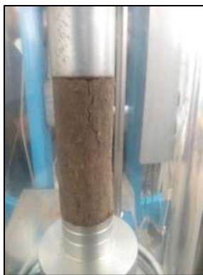
Figura 58. Especimen despues de haber fallado.
