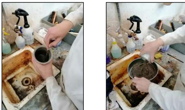
Figura 20. Colocación del material en la malla N° 200.
