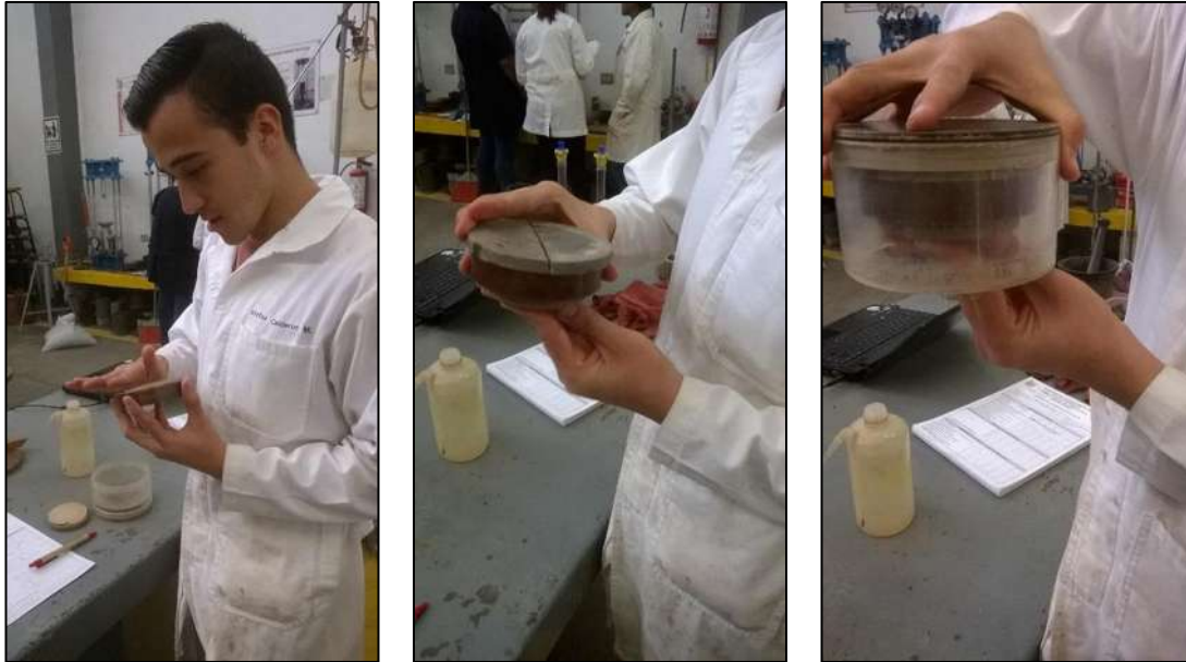
Figura 49. Colocación de las piedras porosas.
