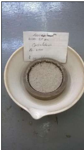
Figura 51. Anillo despues de la prueba.
