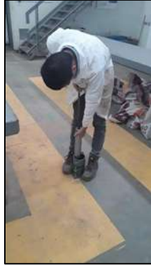
Figura 32. Compactación con el pisón.
