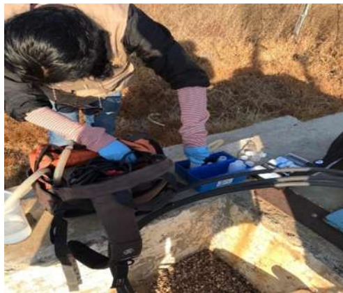
Proceso de llenado de muestras mediante un filtro de nitrilo y una bomba de filtrado de agua.
