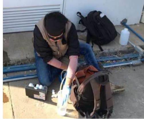
Proceso de llenado de muestras mediante un filtro de nitrilo y una bomba de filtrado de agua.
