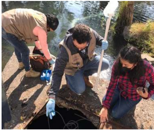
Colección de muestra de agua proveniente de un manantial (manantial “manantiales”) ingresando el dispositivo multiparamétrico de forma directa.
