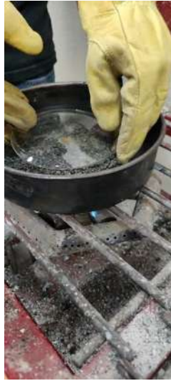
Ilustración 24. La arena aún contiene agua puesto que se empaña el cristal. Fuente: Propia
