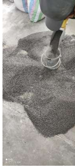
Ilustración 27. Llenado del recipiente con masa y volumen conocidos. Fuente: Propia
