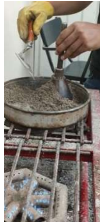
Ilustración 18. Apisonadas en el molde tronco cónico. Fuente: Propia
