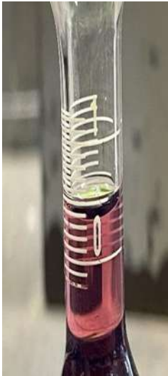
Ilustración 55. Lectura inicial al introducir el petróleo. Fuente: Propia
