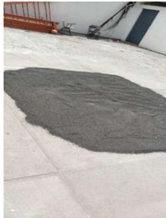
Ilustración 8. Arena negra (J) en proceso de secado en el patio del laboratorio de materiales. Fuente: Propia
