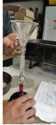
Ilustración 52. Introducción del cemento con ayuda del embudo. Fuente: Propia
