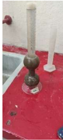
Ilustración 21. Se llenó el frasco con la arena en condición saturada y superficialmente seca. Fuente: Propia
