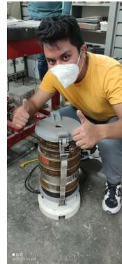
Ilustración 34. Agitador de tamices con el juego de mallas cribando la arena. Fuente: Propia
