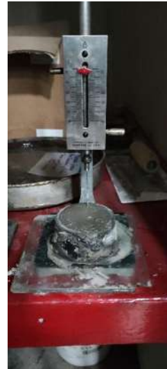
Ilustración 49. Medición al momento de fraguado final. Fuente: Propia
