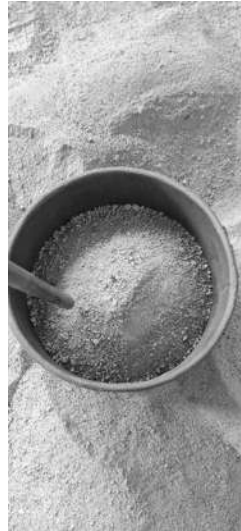
Ilustración 30. Entre cada capa se dio un total de 25 varilladas distribuidas uniformemente. Fuente: Propia
