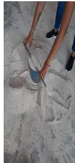
Ilustración 31. Enrasado con ayuda de la varilla punta de bala. Fuente: Propia
