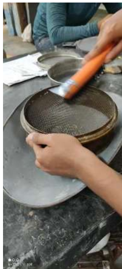
Ilustración 35. Limpieza de las cribas con ayuda del cepillo para evitar la pérdida de partículas. Fuente: Propia
