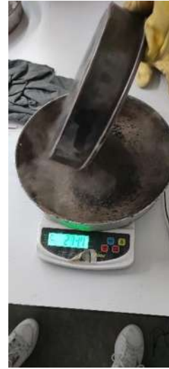
Ilustración 25. Se registra la masa final de la arena y se registra como M_s . Fuente: Propia
