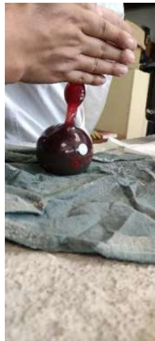
Ilustración 53. Extracción del aire atrapado entre el cemento. Fuente: Propia
