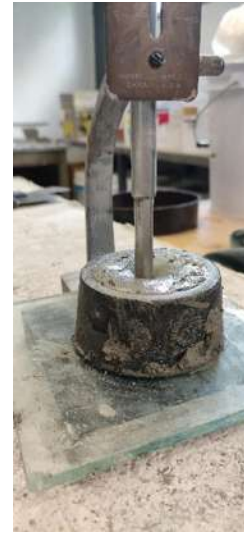
Ilustración 44. Penetración de la aguja a los 30 segundos de ser soltada. Fuente: Propia
