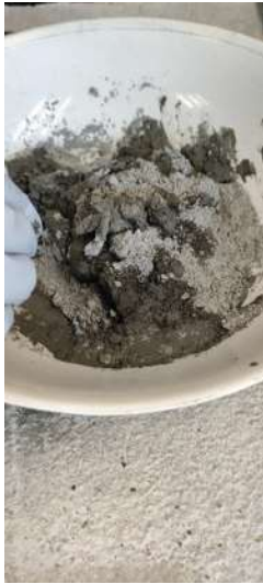
Ilustración 45. Se preparó la mezcla del mismo modo que para el ensayo de consistencia normal. Fuente: Propia
