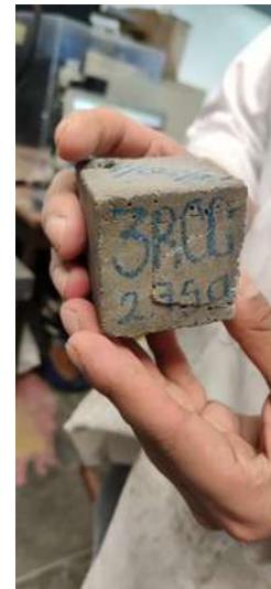
Ilustración 75. Falla presentada una vez alcanzada la carga máxima. Fuente: Propia
