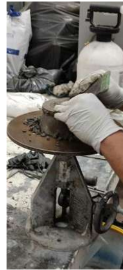
Ilustración 61. Enrasado del molde. Fuente: Propia
