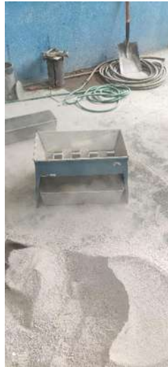
Ilustración 12. Cuarteador instalado para realizar el ensayo. Fuente: Propia
