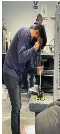
Ilustración 56. Se introduce la cal con ayuda del embudo. Fuente: Propia
