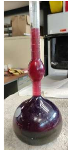
Ilustración 54. Toma del valor en la parte inferior del menisco. Fuente: Propia
