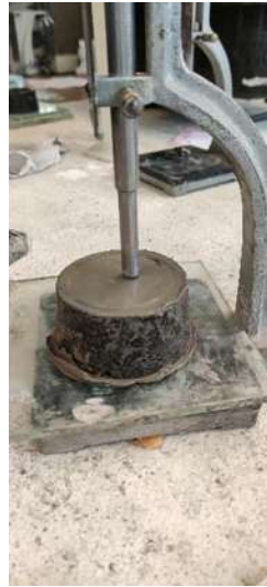
Ilustración 43. Colocación de la pasta en el aparato de Vicat. Fuente: Propia
