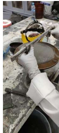
Ilustración 63. Medición del diámetro extendido de la mezcla de mortero. Fuente: Propia
