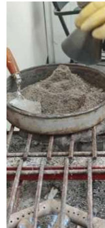
Ilustración 19. Al retirar el molde, se puede apreciar como la arena se disgrega. Fuente: Propia
