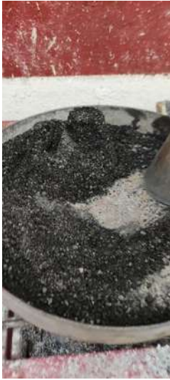
Ilustración 23. Arena en condición saturada y superficialmente seca Fuente: Propia.
