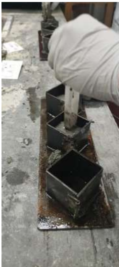
Ilustración 64. Apisonado de especímenes cúbicos. Fuente: Propia
