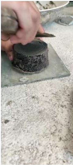
Ilustración 42. Pasta en el molde siendo enrasada. Fuente: Propia
