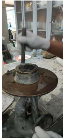
Ilustración 60. Apisonado en el molde sobre la mesa de fluidez. Fuente: Propia
