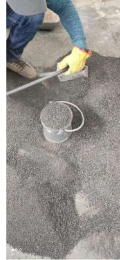
Ilustración 28. Se enrasó el recipiente con ayuda de la varilla punta de bala. Fuente: Propia
