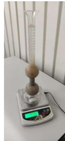
Ilustración 22. Se registra el peso del frasco más el agua y más la arena. Fuente: Propia
