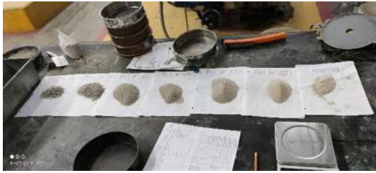
Ilustración 37. Distribución de partículas según lo retenido en los distintos tamices. Fuente: Propia
