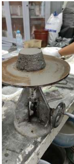
Ilustración 62. Mortero previo a los 25 golpes con la mesa de fluidez. Fuente: Propia
