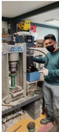
Ilustración 74. Aplicación de la carga constante al espécimen. Fuente: Propia
