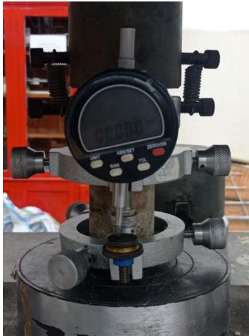
Figura 37. Cilindro en prensa hidráulica, con medidor de deformaciones instalado. (C. A. Díaz Ávila)
