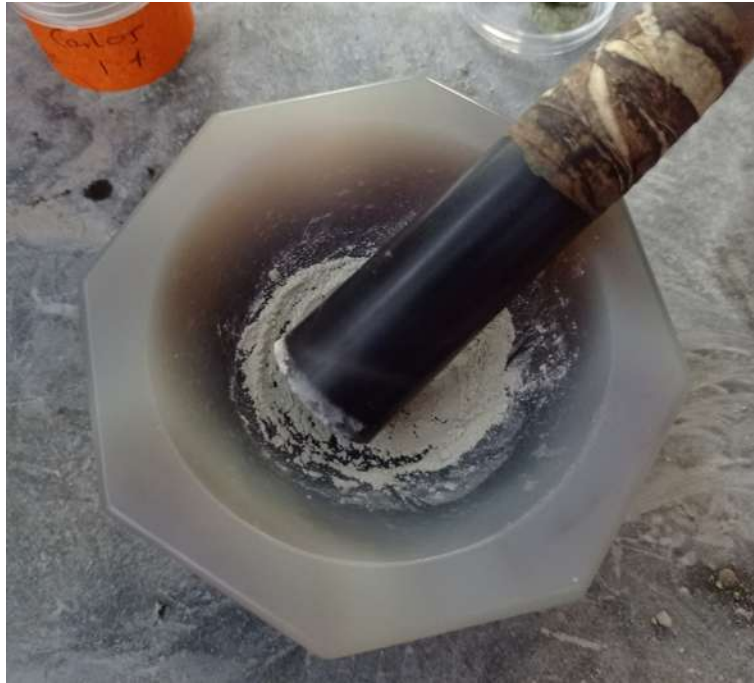
Figura 22. Mucílago de nopal anhidro y molido en mortero de ágata. (C. A. Díaz Ávila)
