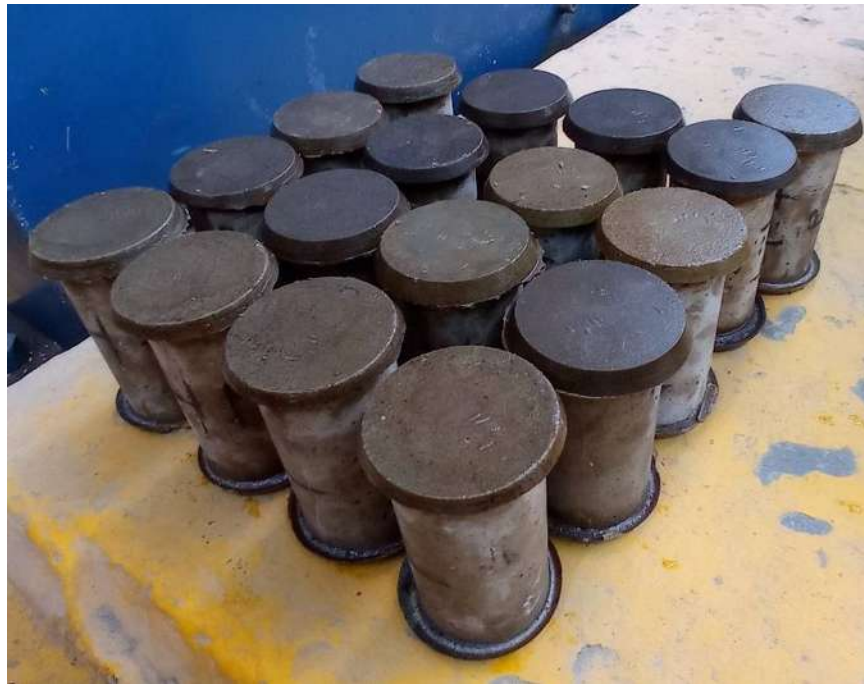
Figura 36. Cilindros cabeceados con azufre. (C. A. Díaz Ávila)
