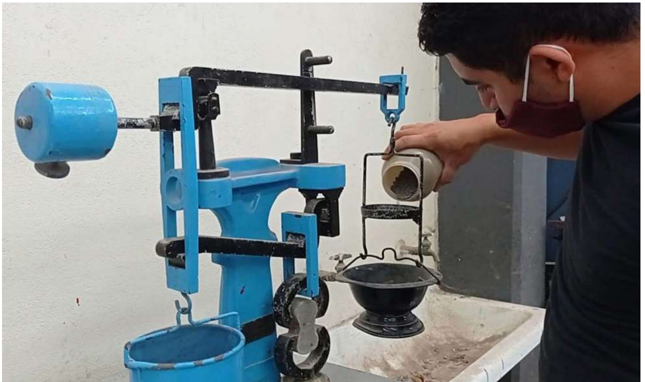
Figura 40. Prueba de tensión directa en briquetas. (C. A. Díaz Ávila)
