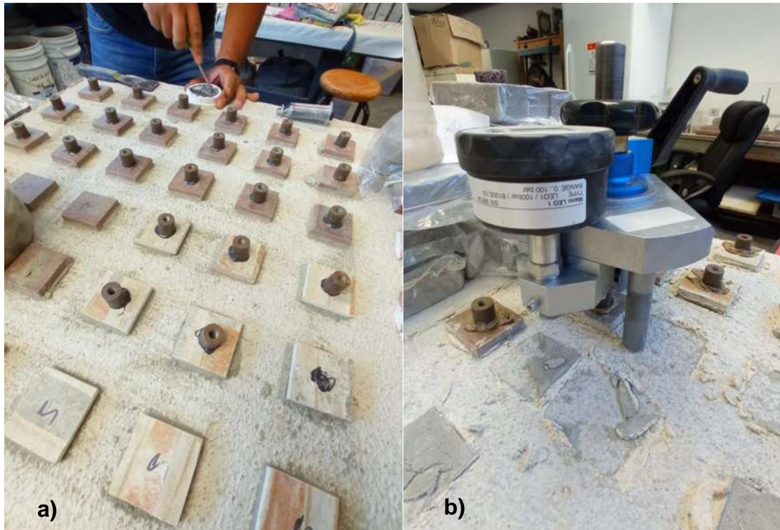
Figura 43. a) Instalación de Dólis con resina epóxica para prueba de adherencia y b) Equipo pull-off instalado en los Dólis para hacer prueba de adherencia. (C. A. Díaz Ávila)
