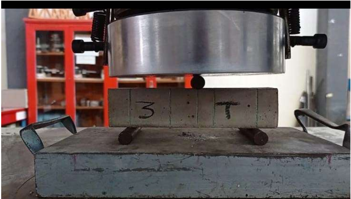
Figura 38. Prisma instalado en prensa hidráulica para aplicar flexión. (C. A. Díaz Ávila)
