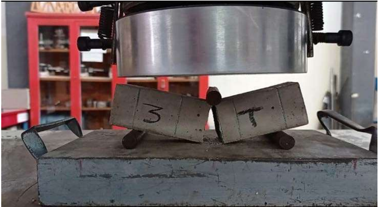
Figura 39. Falla deseada en los especímenes. (C. A. Díaz Ávila)
