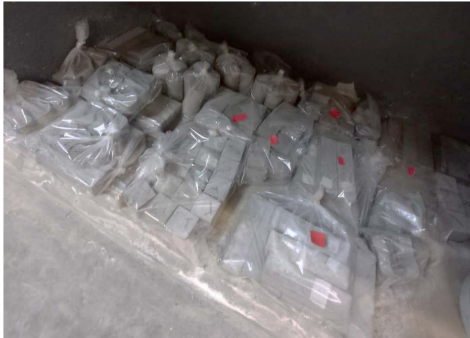
Figura 32. Curado de especímenes de mortero con mucílago de nopal. (C. A. Díaz Ávila)
