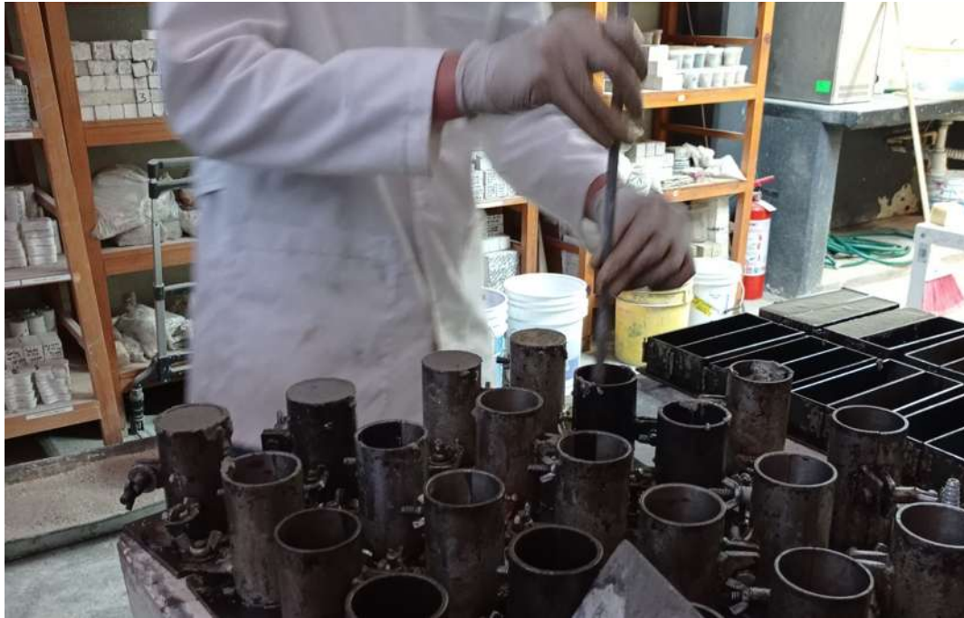
Figura 31. Proceso de elaboración de cilindros de mortero. (C. A. Díaz Ávila)
