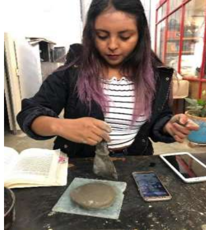
Ilustración 18. Elaboración de la pastilla de cemento. Fuente: Elaboración propia
