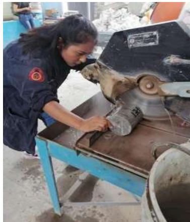
Ilustración 56. Corte de especímenes de concreto. Fuente: Elaboración propia
