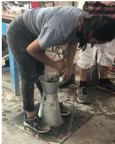
Ilustración 51. Ejecución de la prueba de revenimiento. Fuente: Elaboración propia
