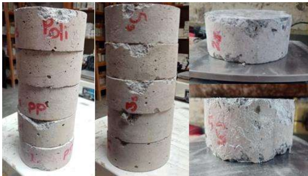
Ilustración 82. Especímenes de las mezclas adicionadas con PET y polipropileno al finalizar la prueba. Fuente: Elaboración propia
