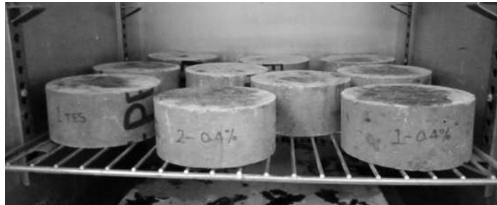
Ilustración 58. Muestras de concreto en horno de secado a una temperatura de 100 °C a 110 °C. Fuente: Elaboración propia
