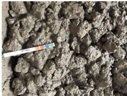
Ilustración 53. Tira indicadora sobre el concreto. Fuente: Elaboración propia
