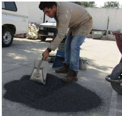
Ilustración 21. Cuarteo manual en arena. Fuente: Elaboración propia.
