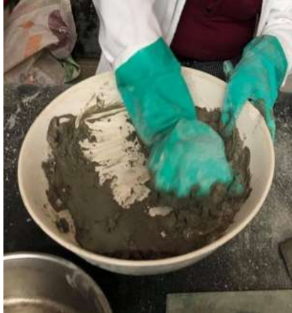
Ilustración 17. Preparación de la pasta de cemento. Fuente: Elaboración propia
