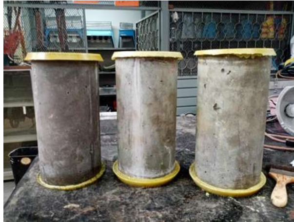
Ilustración 54. Cabeceo de especímenes. Fuente: Elaboración propia
