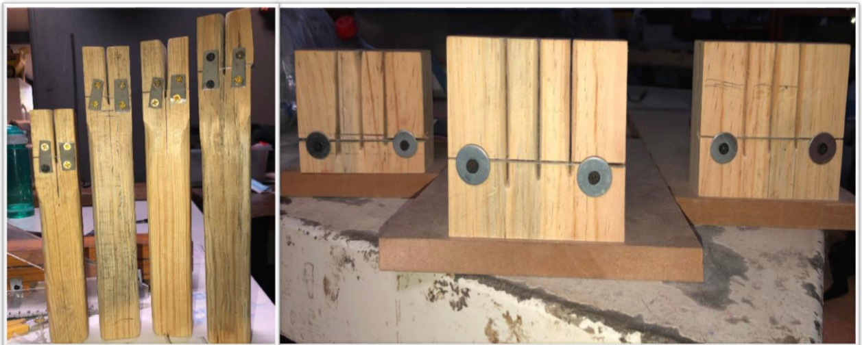
Figura 3.2. Equipos elaborados para la producción de tiras de PET: Fuente: Elaboración propia.
