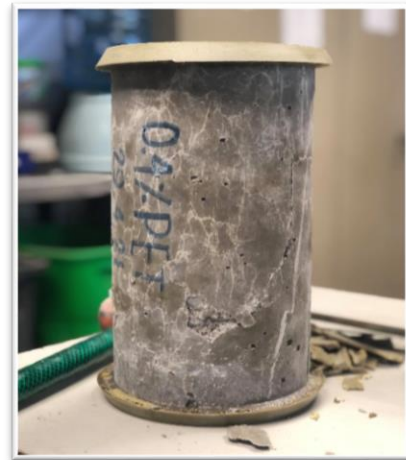
Figura 4.44 Falla del espécimen de concreto.
