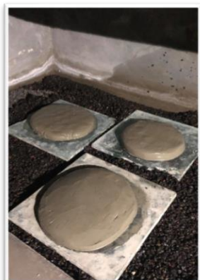
Figura 4.5. Colocado de especímenes de prueba en cuarto húmedo. Fuente: Elaboración propia..
