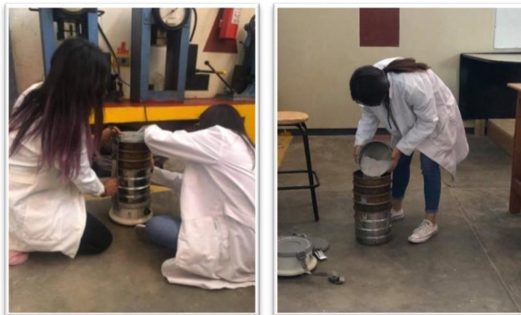
Figura 4.20. Acomodo de mallas en orden decreciente y vaciado de la muestra de agregado fino. Fuente: Elaboración propia..
