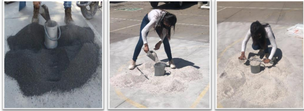
Figura 4.13. Llenado y enrasado del recipiente con la muestra en materiales A y B. Fuente: Proipia
