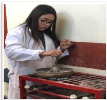
Figura 4.15. Colocación de molde troncocónico sobre el material. Fuente: Elaboración propia.
