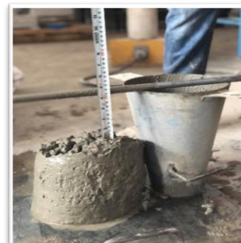
Figura 4.38. Toma de lectura del revenimiento. Fuente:
