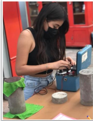
Figura 4.13 Acomodo de placas metálicas y toma de lectura de resistencia eléctrica. Fuente: Elaboración propia.
