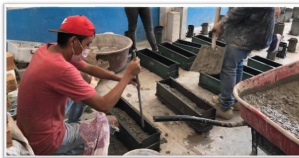
Figura 3.4. . Varillado en elaboración de muestras de concreto fresco. Fuente: Elaboración propia.
