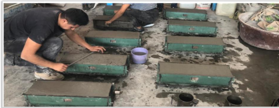
Figura 3.10. Proceso de enrasado de moldes en vigas y cilindros, Fuente: Elaboración
