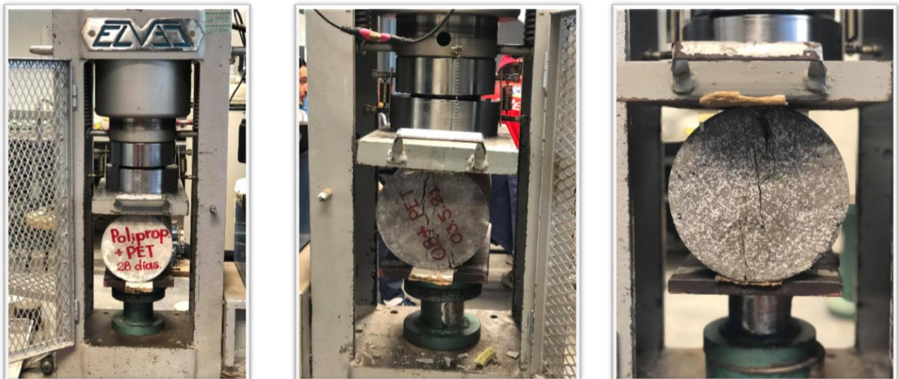
Figura 4.47. Colocación de espécimen en la máquina y aplicación de carga. Fuente: Elaboración propia.
