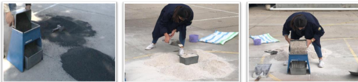
Figura 4.9. Vaciado de material sobre la parte superior del cuarteador mecánico. Material A y B. Fuente: Elaboración propia.
