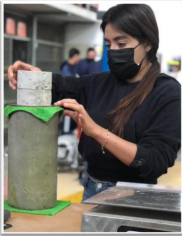
Figura 4.13 Acomodo de placas metálicas y toma de lectura de resistencia eléctrica. Fuente: Elaboración propia.
