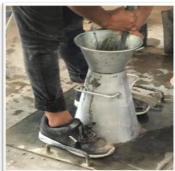
Figura 4.36. Varillado sobre la superficie de la mezcla. Fuente:
