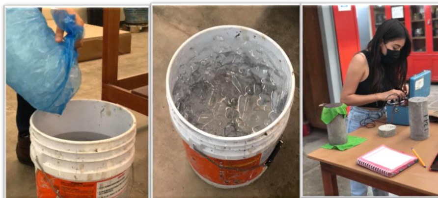
Figura 5.2 Enfriamiento de agua para saturar el espécimen y toma de lectura de Re. Fuente: Propia.
