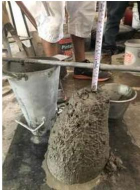
Ilustración 45 Revenimiento de concreto fresco. Fuente: Elaboración propia.
