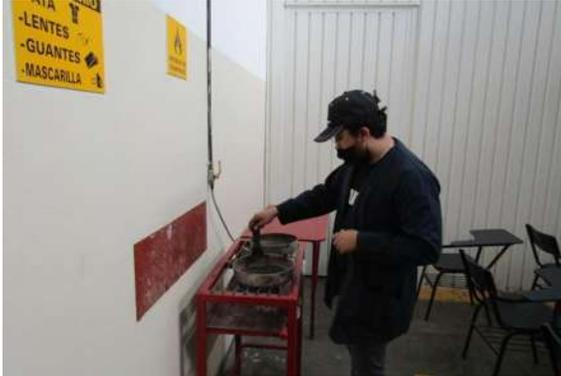
Ilustración 13 Humedad de Absorción de la arena Negra. Fuente: Elaboración propia
