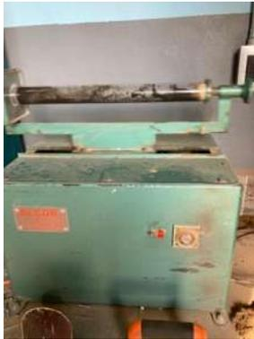
Ilustración 27 Muestra de arena en el agitador mecánico de equivalente de arena.
