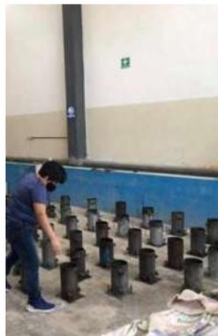
*Ilustración 47 Elaboración de cilindros 15 x 30. Fuente: Elaboración propia.*
