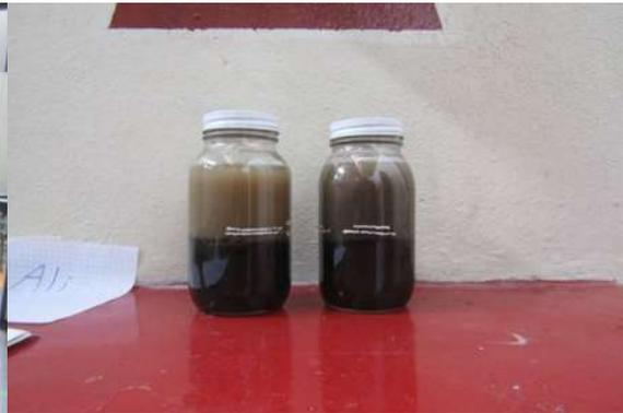
Ilustración 26 Reposo para determinar el material fino de la muestra. Fuente: Elaboración propia.
