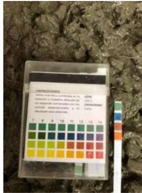
Ilustración 53 Resultado de PH en la mezcla de concreto hidráulico fresco. Fuente: Elaboración propia
