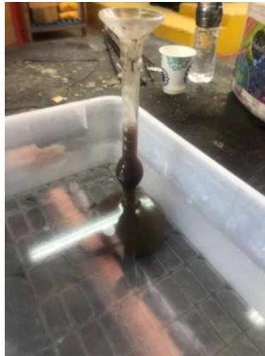
Ilustración 4 Densidad del Cemento. Fuente: Elaboración propia
