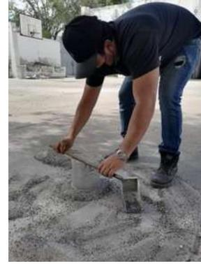
Ilustración 10 MVSS de la arena combinada. Fuente: elaboración propia.
