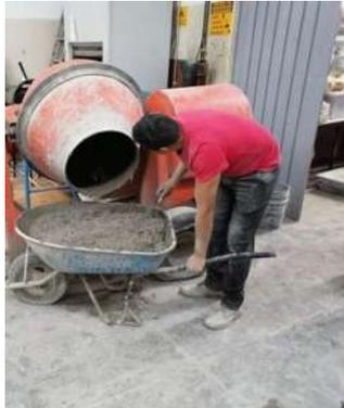
Ilustración 44 Muestreo de concreto fresco. Fuente: Elaboración propia.
