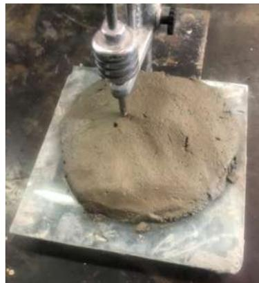
Ilustración 3 Tiempos de fraguado del cemento. Fuente: Elaboración propia.
