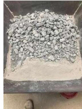
Ilustración 39 Desgaste de los Ángeles de grava triturada. Fuente: Elaboración propia.
