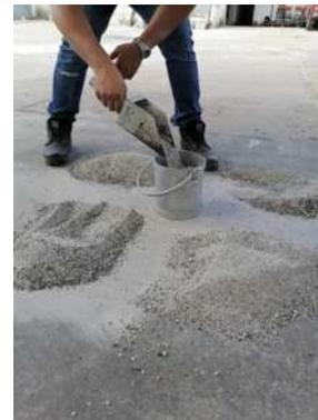
Ilustración 12 MVSV de la arena combinada. Fuente: Elaboración propia.
