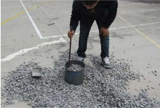
Ilustración 33 Compactación con la varilla de la grava. Fuente: Elaboración propia.
