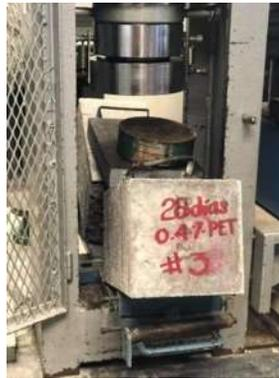
Ilustración 52 Modulo de ruptura de la viga de 15 x 60. Fuente: Elaboración propia
