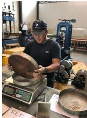
Ilustración 36 Granulometría de la grava triturada. Fuente: Elaboración Propia.
