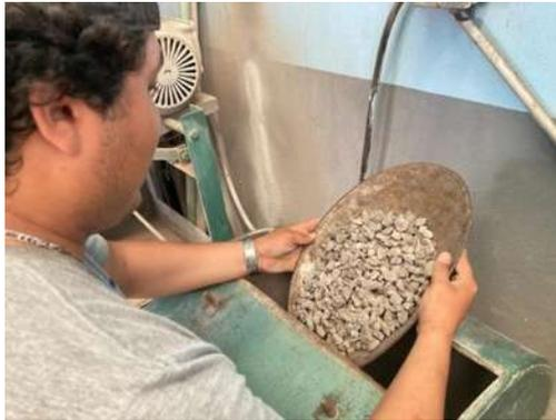
Ilustración 38 Colocación de la grava triturada en la máquina de desgaste de los ángeles. Fuente: Elaboración propia.
