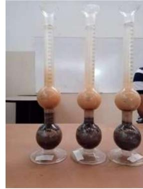
Ilustración 16 Densidad de la arena combinada. Fuente: elaboración propia
