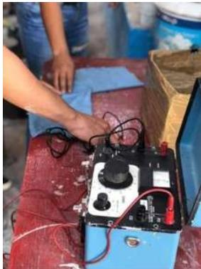
Ilustración 49 Equipo de resistividad eléctrica. Fuente: Elaboración propia.
