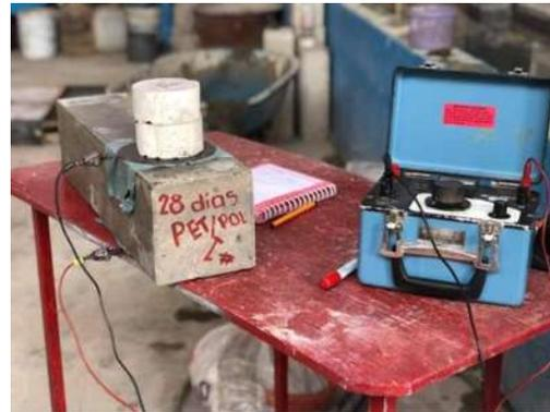
Ilustración 50 Resistividad eléctrica del espécimen. Fuente: Elaboración propia.
