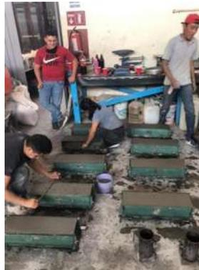
Ilustración 48 Elaboración de vigas de dimensiones 15 cm x 15 cm y longitud de 60 cm.. Fuente: Elaboración propia.
