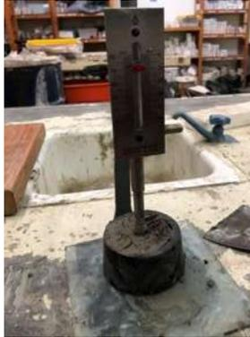
Ilustración 2. Consistencia normal del cemento. Fuente: Elaboración propia
