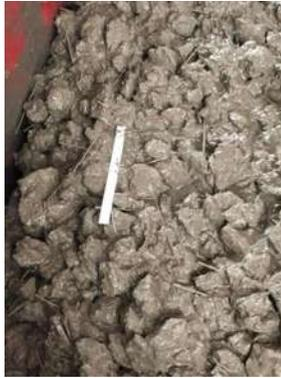
Ilustración 46 Colocación de tira de PH en la mezcla de Concreto hidráulico fresco. Fuente Elaboración propia.
