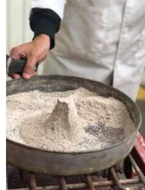
Ilustración 14 Humedad de absorción de la arena Blanca. Fuente: Elaboración propia
