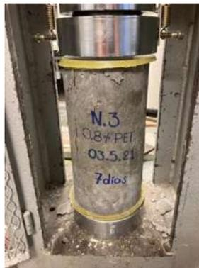
Ilustración 51 Compresión de cilindros de 15 cm de diámetro y 30 cm de longitud. Fuente: Elaboración propia.
