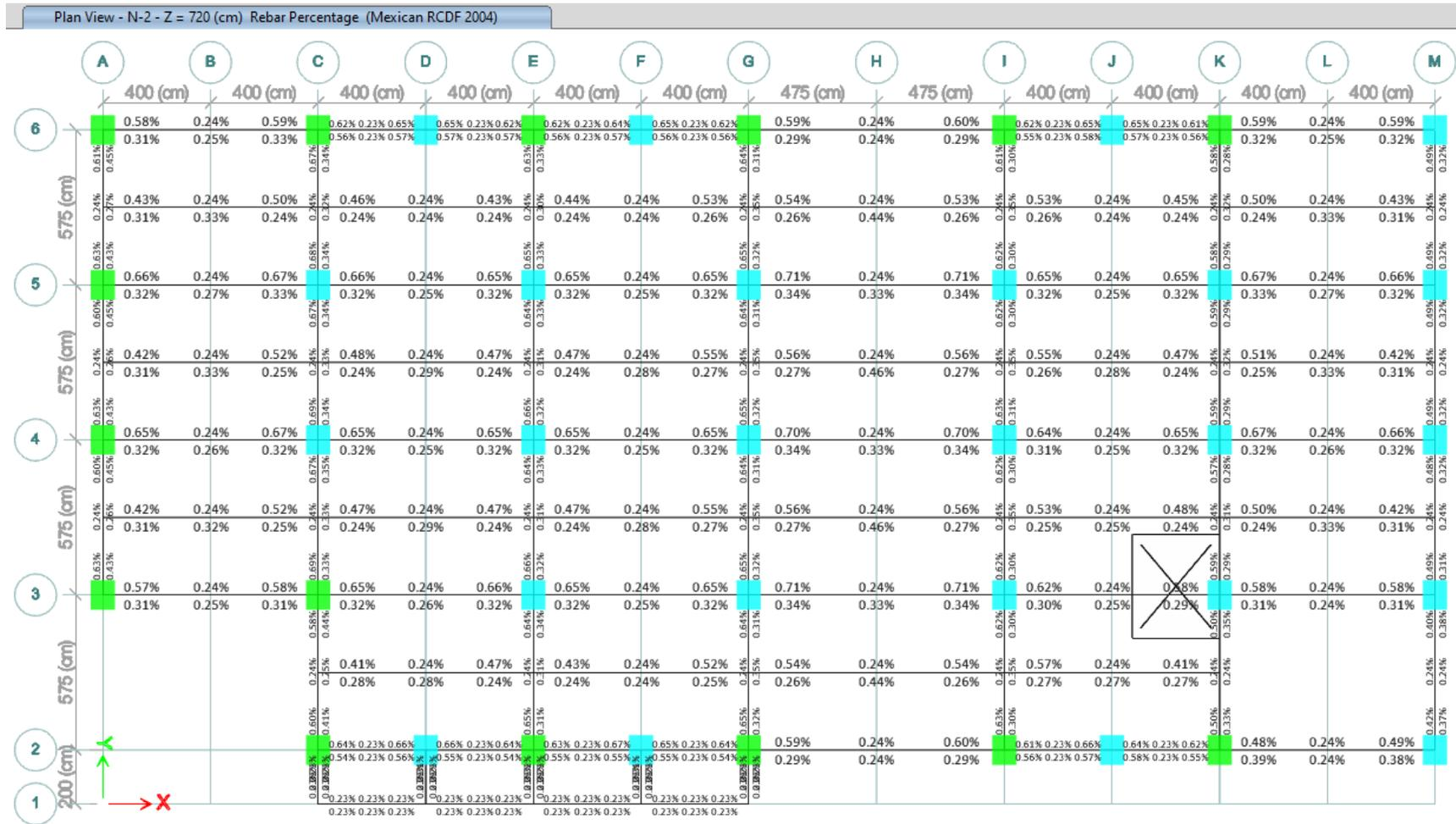
Figura 236 Aceros de refuerzo requeridos a flexión planta N-2
