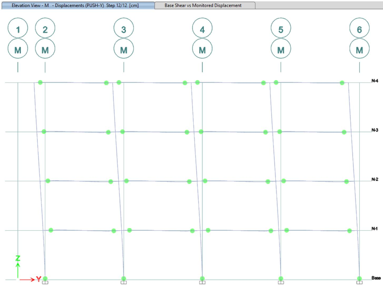
Figura 302 Articulación plástica eje M
