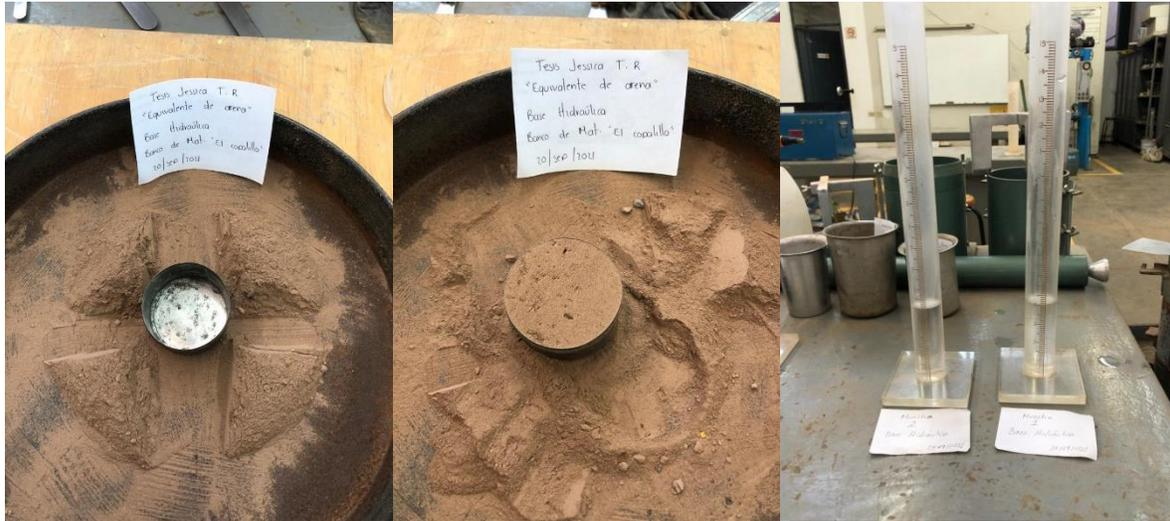
Fig. 48 Cuarteo y muestra para la prueba, Base hidráulica, J. Torres, 2022.
