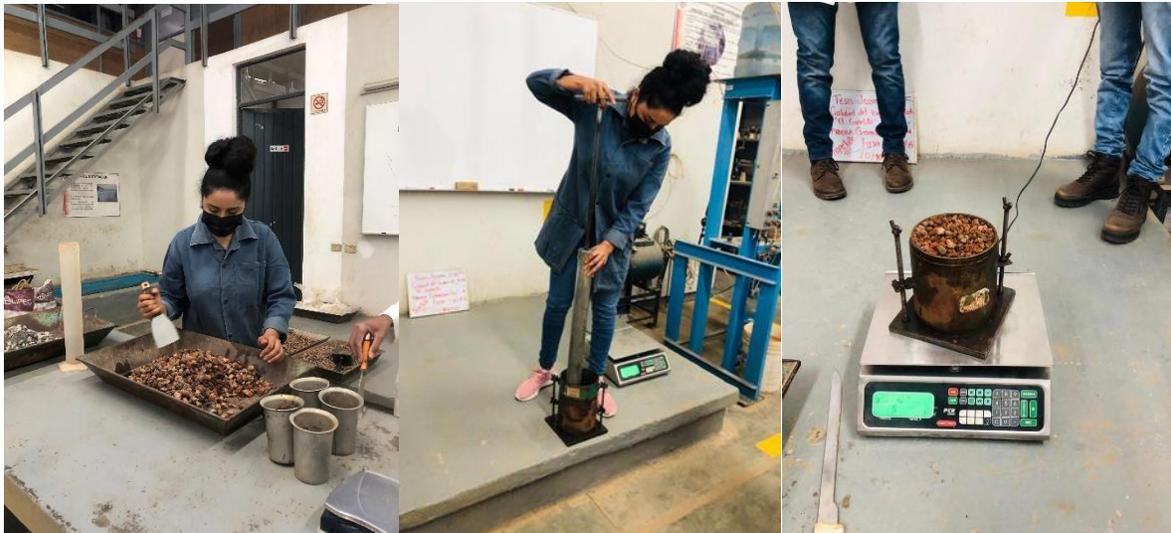
*Fig. 65 Proceso de compactación, Base hidráulica, J. Torres, 2022.*
