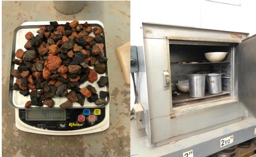
Fig. 28 Peso de la muestra y secado en horno, Base hidráulica, J. Torres, 2022.
