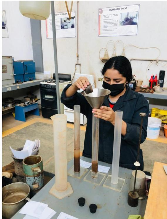
*Fig. 56 Colocación de material en la probeta con ayuda de un embudo, Subrasate, J. Torres, 2022.*
