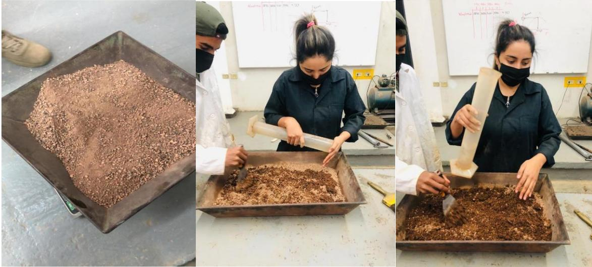
*Fig. 66 Material cribado, y agua agregada para la homogenización del material para la prueba, Subrasante, J. Torres, 2022.*
