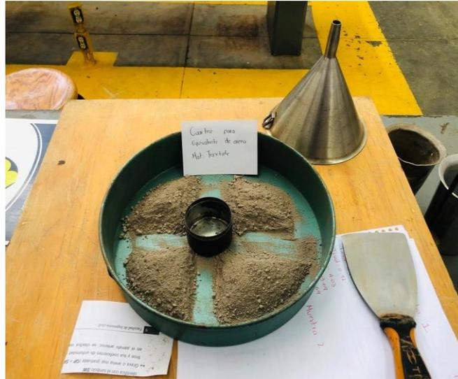
*Fig. 60 Cuarteo de material para obtener muestra y realizar la prueba equivalente de arena, Tepetate, J. Torres, 2022.*
