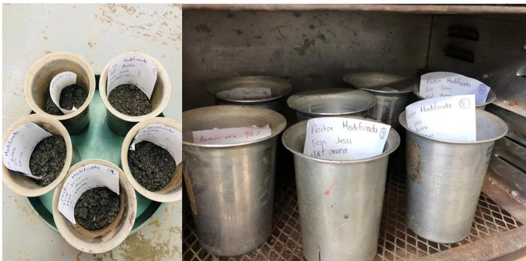
*Fig. 71 Muestras de material con diferentes humedades, Arena, J. Torres, 2022.*
