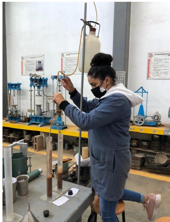
*Fig. 51 Colocación de solución hasta las 15", Base hidráulica, J. Torres, 2022.*
