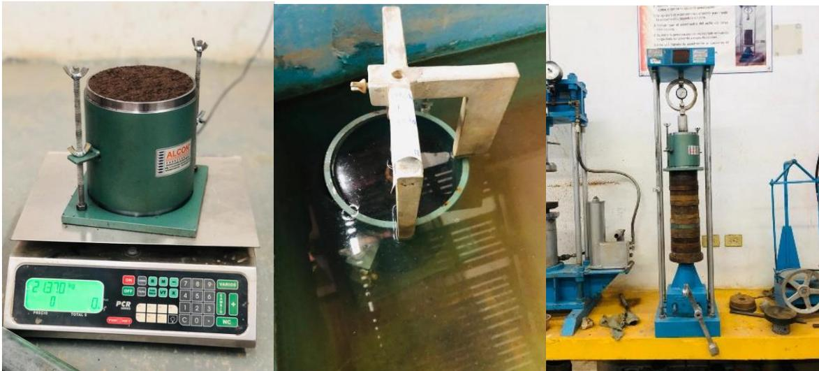
Fig. 89 Muestra colocada en el equipo de carga, Tepetate, J. Torres, 2022.
