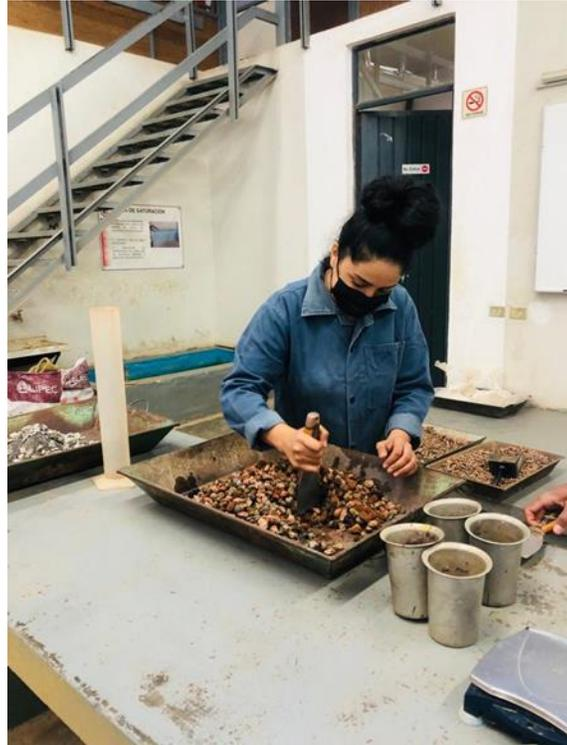
*Fig. 64 Material cribado por la malla 3/4" y aplicación del agua y homogenización del material para realizar la prueba, Base hidráulica, J. Torres, 2022.*
