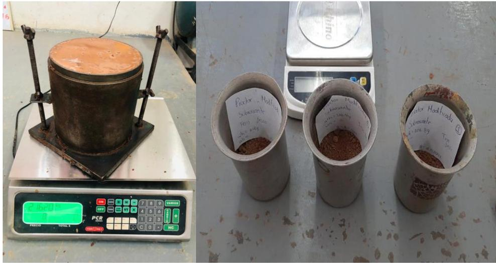
*Fig. 68 Muestras de las pruebas realizadas con diferentes contenidos de agua para secar en el horno, Subrsante, J. Torres, 2022.*
