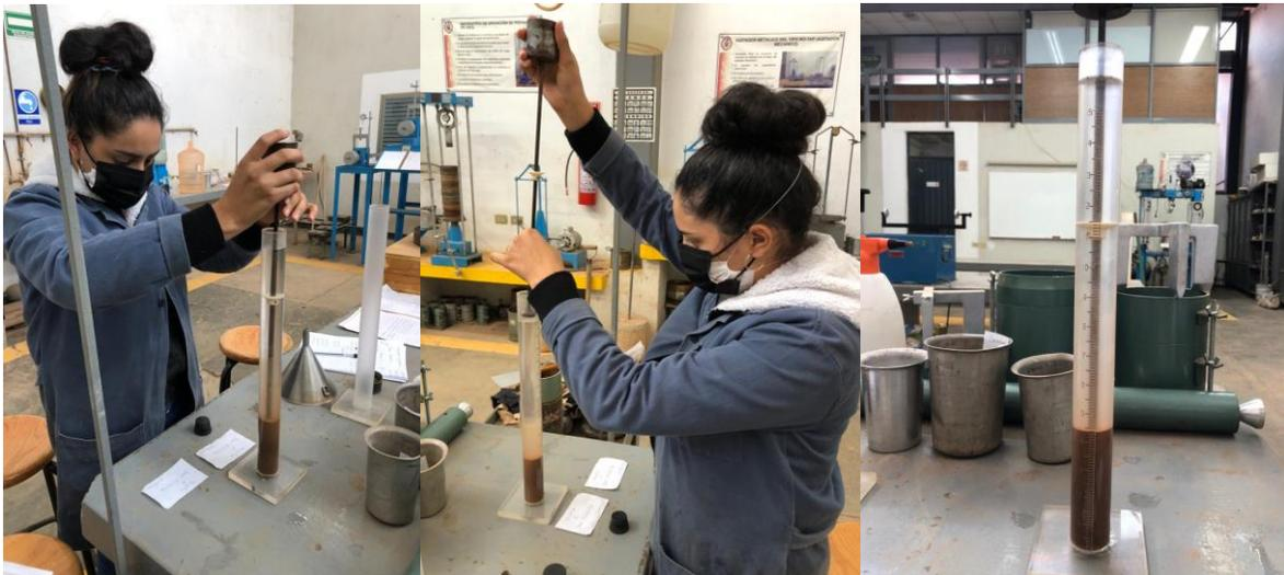
*Fig. 53 Procedimiento de la varilla con pisón para tomar lectura de las arenas presentes en la muestra, Base hidráulica, J. Torres, 2022.*
