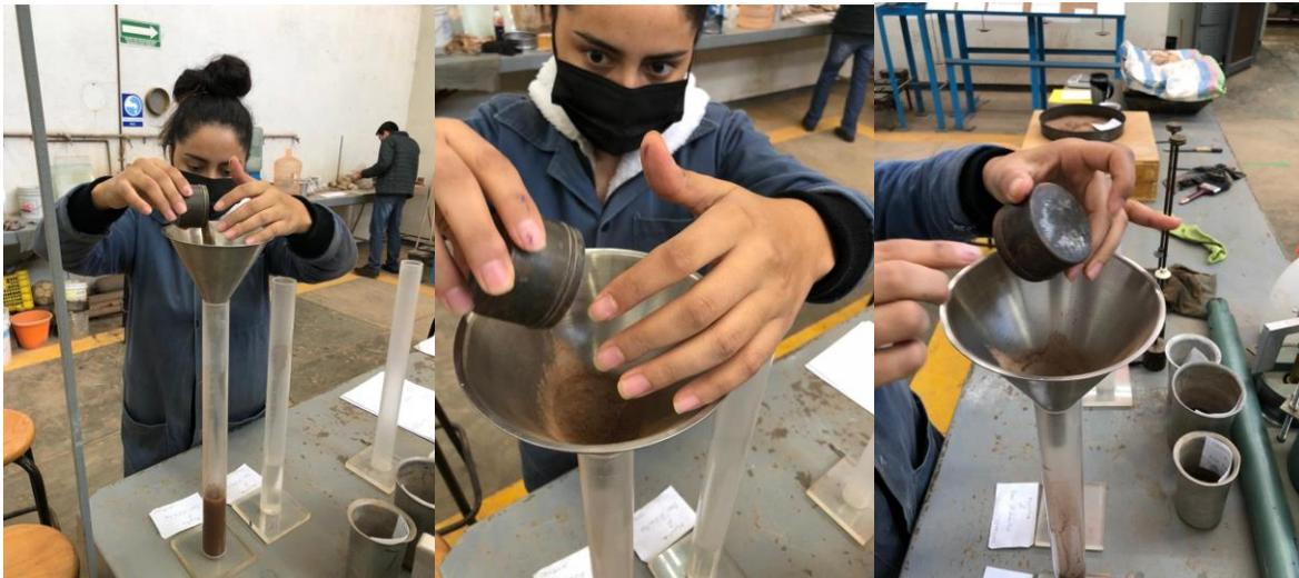
Fig. 49 Colocación de muestra en la probeta que contiene la solución, Base hidráulica, J. Torres, 2022.
