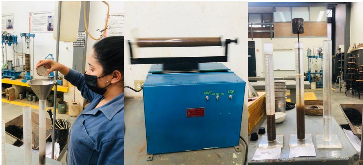
*Fig. 61 Proceso y toma de resultados de la prueba equivalente de arena, Tepetate, J. Torres, 2022.*
