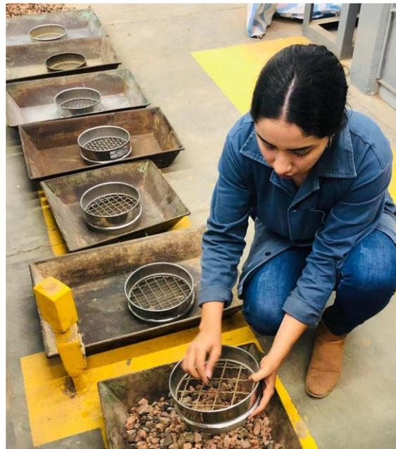
*Fig. 11 Cribado por mallas, Granulometría gruesa, Base hidráulica, J. Torres, 2022.*
