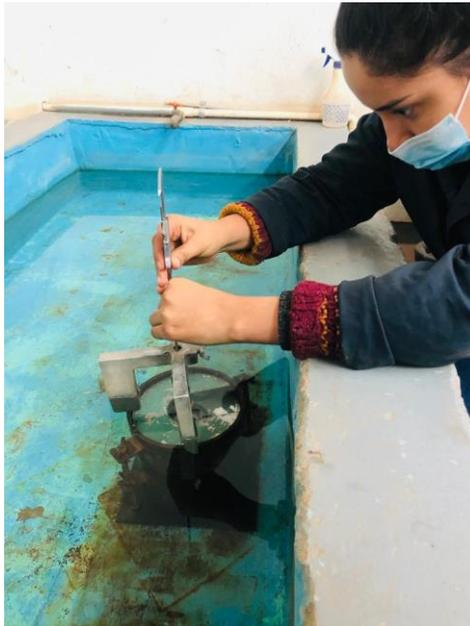
*Fig. 74 Muestra saturada y toma de lectura de expansión, Base hidráulica, J. Torres, 2022.*
