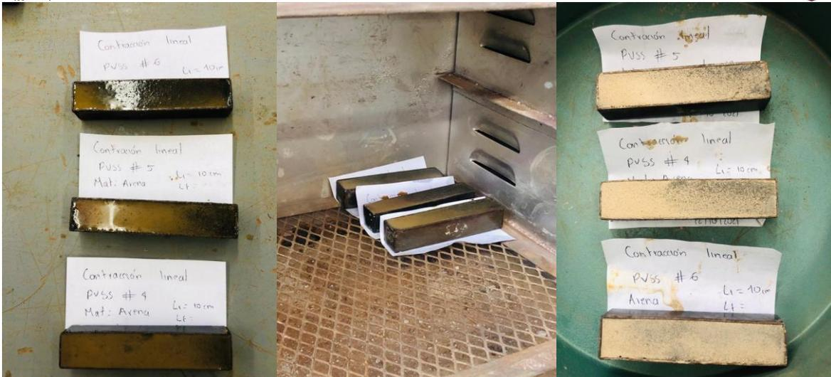
**Fig. 41** Muestra de contracción lineal dentro y fuera del horno de secado, Arena, J. Torres, 2022.
