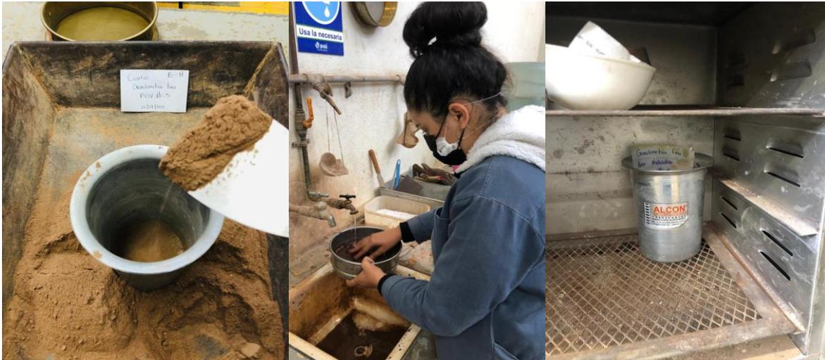
*Fig. 13 Cuarteo, Lavado y secado, para granulometría fina, Base hidráulica, J. Torres, 2022.*
