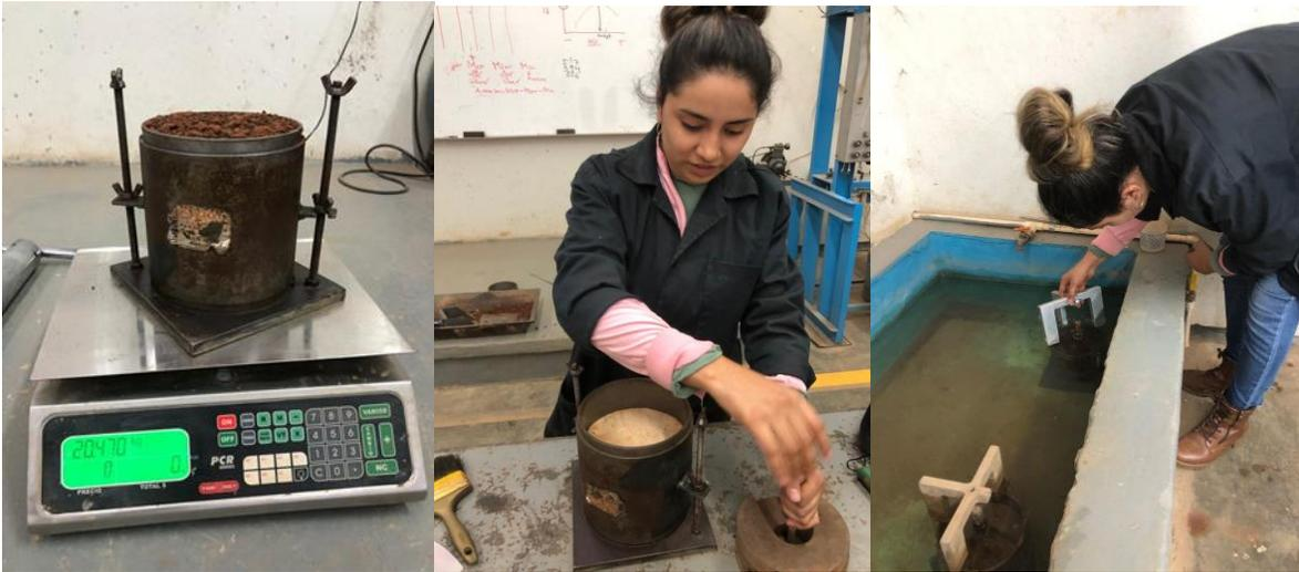
*Fig. 82 Obtención de muestra para CBR, Base hidráulica, J. Torres, 2022.*
