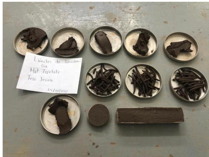
*Fig. 44 Muestras para obtener, límite plástico y líquido, contracción volumétrica y lineal, Tepetate, J. Torres, 2022.*
