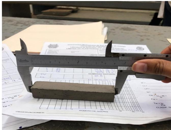
*Fig. 46 Lectura de la contracción lineal, muestra seca, Tepetate, J. Torres, 2022.*
