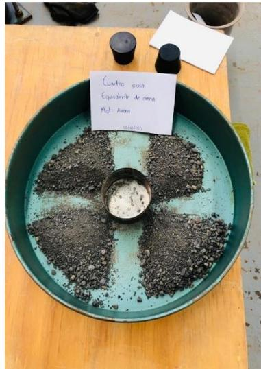
*Fig. 58 Cuarteo de material para obtener muestra y realizar la prueba equivalente de arena, Arena, J. Torres, 2022.*
