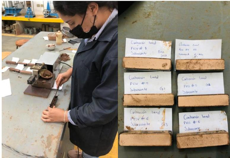
**Fig. 39** Elaboración de las muestras para contracción lineal, y muestras ya retiradas del horno de secado, Subrasante, J. Torres, 2022.
