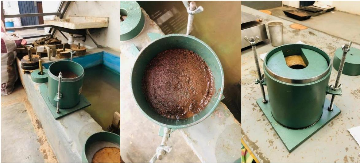
*Fig. 86 Muestra después de saturación y acondicionamiento para prueba CBR, Subrasante, J. Torres, 2022.*
