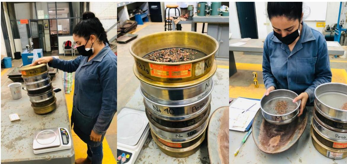
*Fig. 14 Cribado de Granulometría Fina, Base hidráulica, J. Torres, 2022.*
