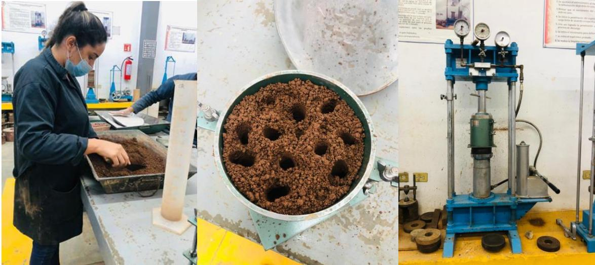
*Fig. 77 Preparación de la muestra mediante prueba Porter, Subrasante, J. Torres, 2022.*
