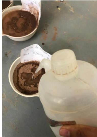
Fig. 33 Muestra saturada, Base hidráulica, J. Torres, 2022.
