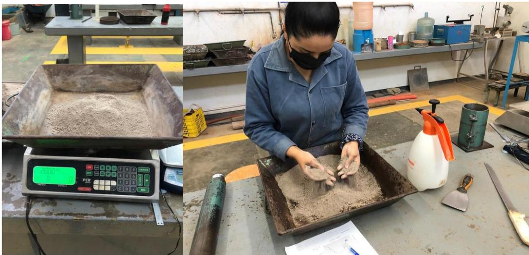
*Fig. 72 Homogenización de material, Tepetate, J. Torres, 2022.*
