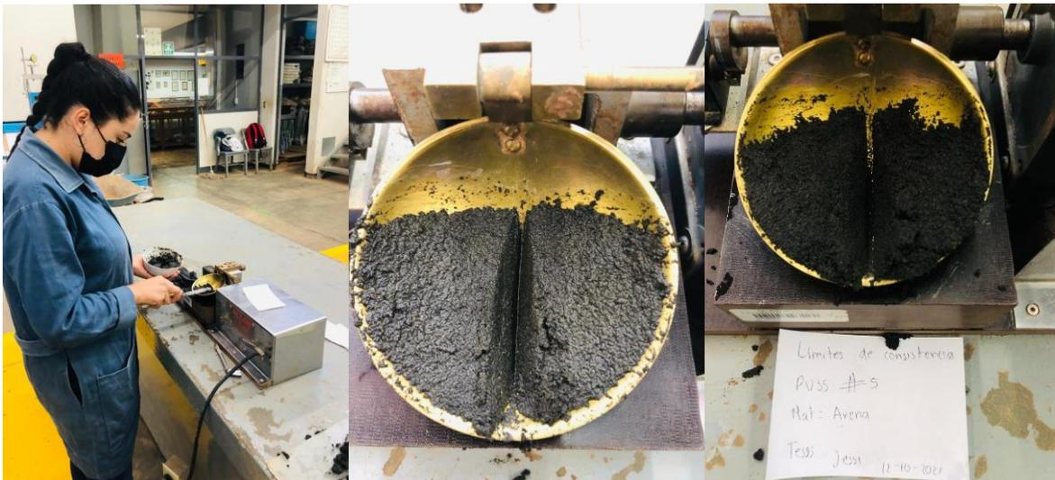
**Fig. 40** Ejecución de la prueba límites de consistencia, Arena, J. Torres, 2022.
