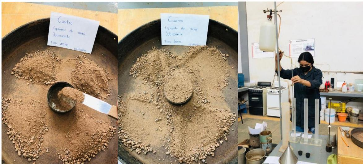
Fig. 55 Cuarteo del material y preparación de la probeta, Subrasante, J. Torres, 2022.
