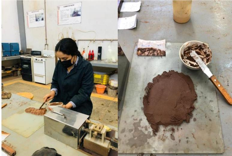
Fig. 37 Secado superficial del material para límites, Subrasante, J. Torres, 2022.
