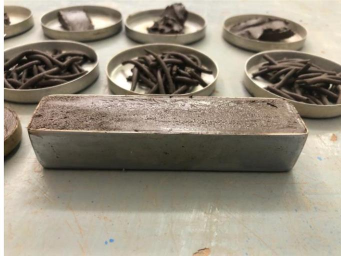
*Fig. 43 Muestra para contracción lineal, Tepetate, J. Torres, 2022.*
