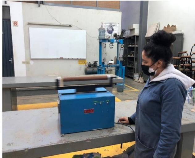
*Fig. 50 Muestra colocada en el agitador mecánico, Base hidráulica, J. Torres, 2022.*
