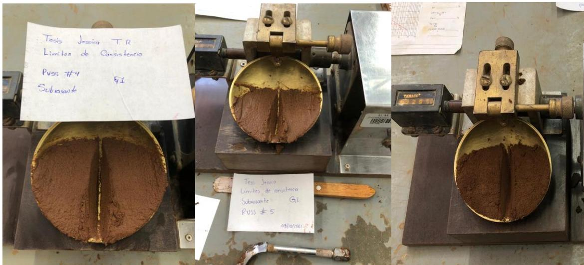
Fig. 38 Procedimiento de la muestra ranurada con diferente contenido de humedad, Subrasante, J. Torres, 2022.
