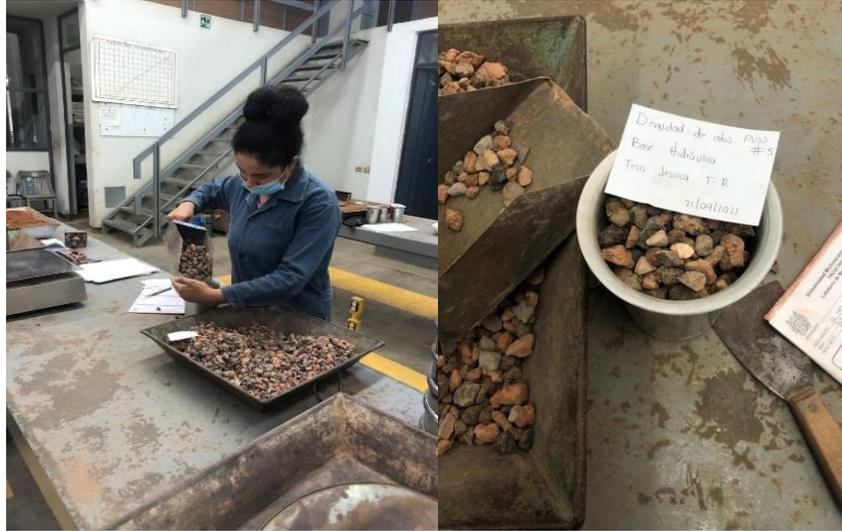
Fig. 26 Muestreo para prueba de absorción, Base hidráulica, J. Torres, 2022.
