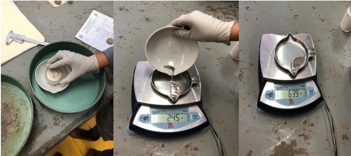
*Fig. 47 Obtención de la contracción volumétrica, Tepetate, J. Torres, 2022.*
