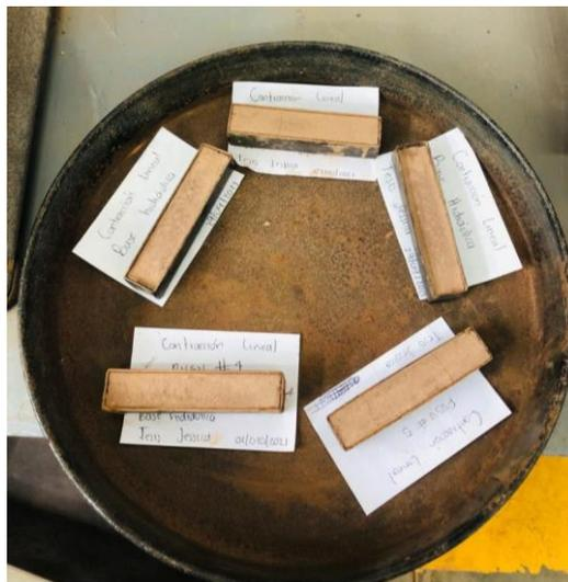
**Fig. 36** Muestras de contracción lineal después de ser secadas en el horno por 24hrs., Base hidráulica, J. Torres, 2022.
