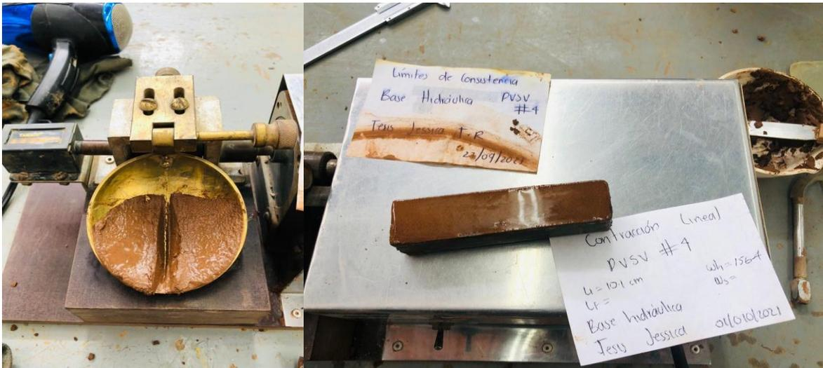
**Fig. 35** Muestra ranurada en la copa de casagrande y muestra para la obtención de la contracción lineal, J. Torres, 2022.
