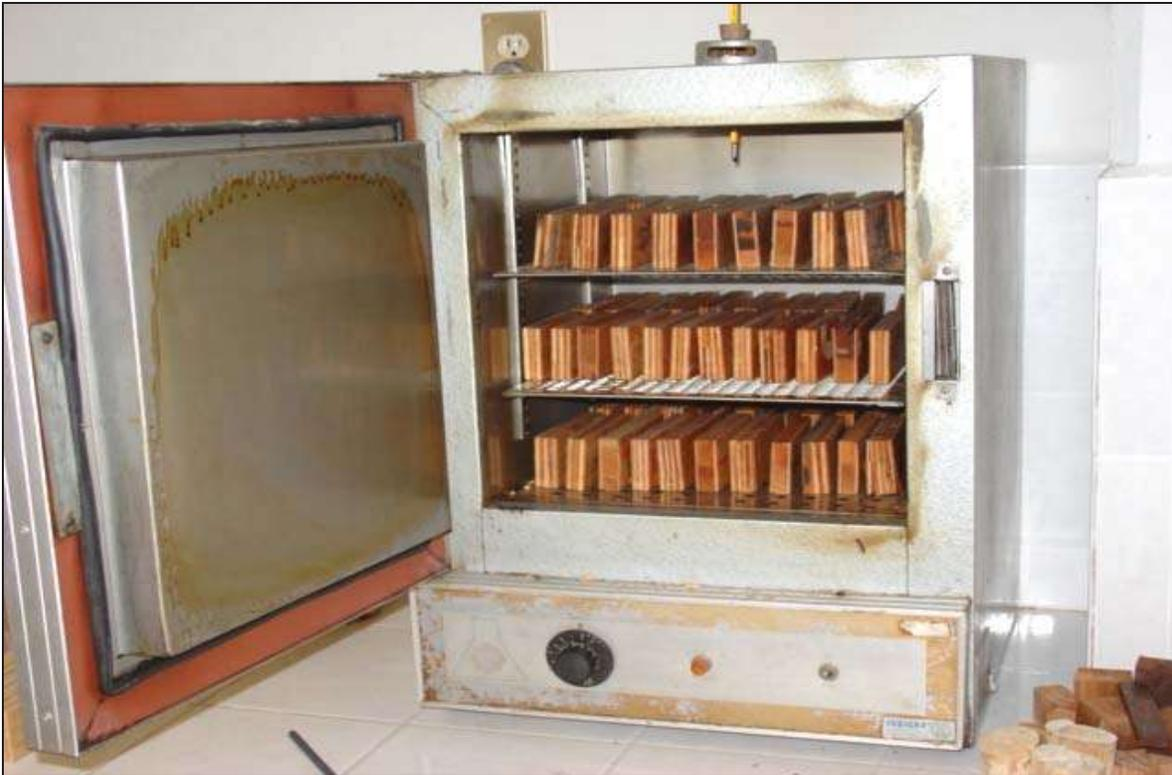
Figura 13. Probetas de la prueba de adhesión dentro del horno con circulación forzada.
