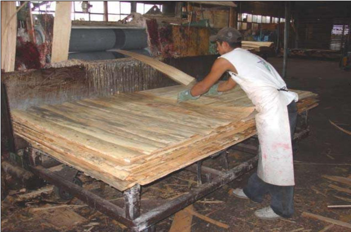
Figura 8. Engomado y armado de los tableros enlistonados enchapados.
