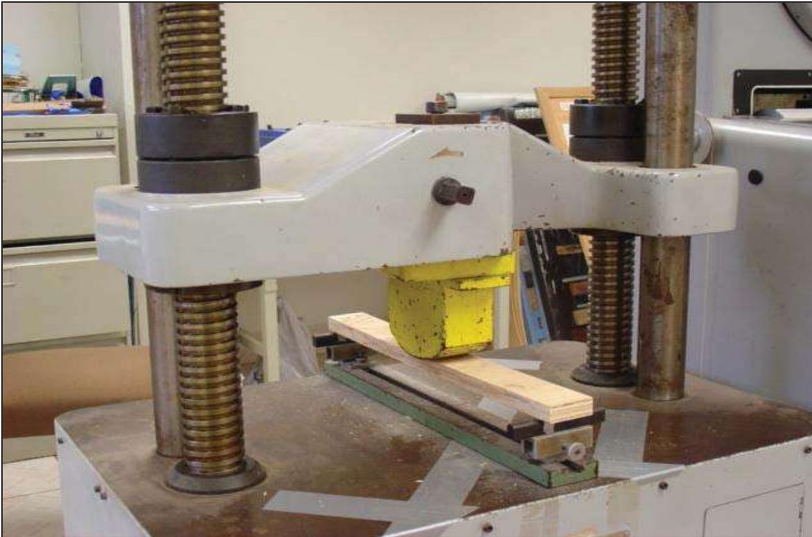
Figura 10. Ensayo de flexión estática en una probeta transversal.
