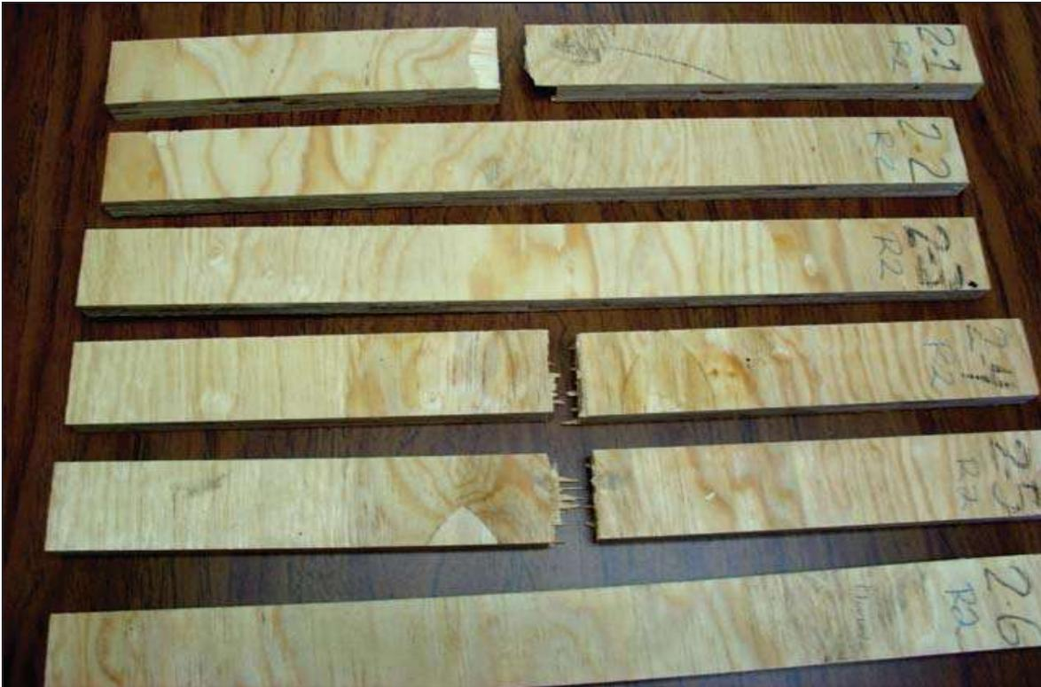
Figura 16. Tipo de fallas en probetas transversales del tablero recortes de triplay (R2), de 19mm.
