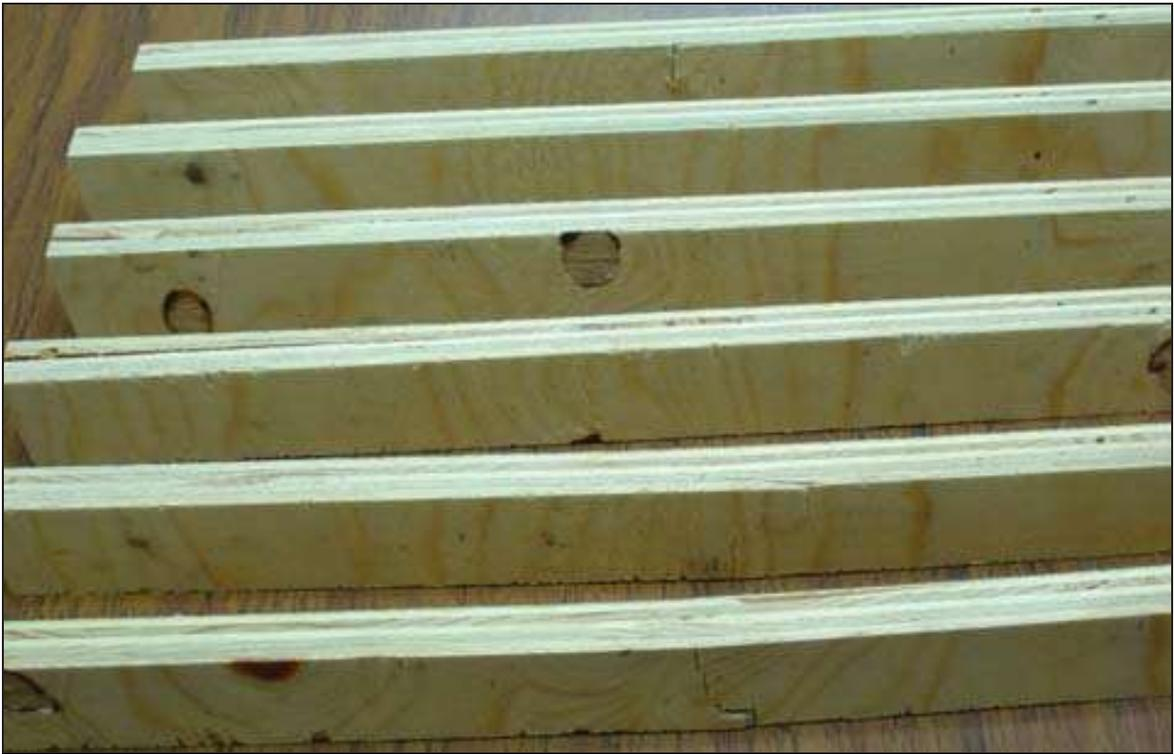
Figura 17. Tipo de fallas en probetas transversales del triplay de 19 mm.
