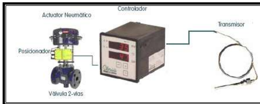
Figura. 16. Esquema de conexión de válvula, actuador, controlador y de los sensores.
