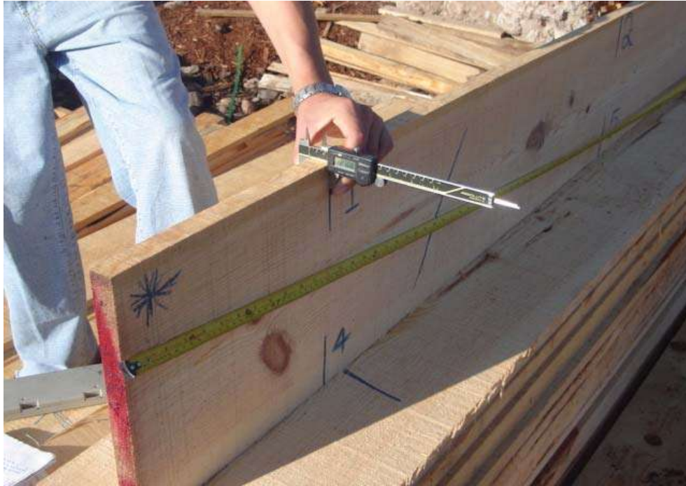
Figura 6. Medición en uno de los 6 puntos de la tabla.
