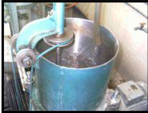
Figura No. 2. Lavado de la pulpa.
