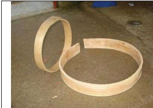
Figura 40. Dos tipos de aros de cahulote que se utilizan para la bases de los bancos
