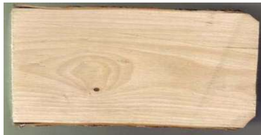
Figura 28. Tablilla de madera del árbol de algodoncillo, donde se observa el corte tangencial
