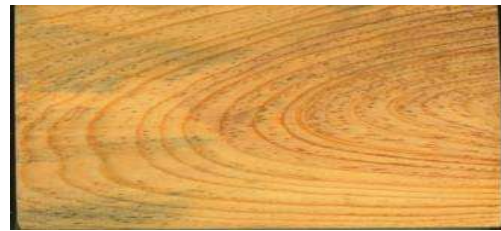
Figura 5. Tablilla con corte tangencial de Pinus oocarpa Schiede.
