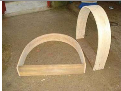
Figura 41. Dos aros de media luna de madera de cahulote con tablilla de pino al frente
