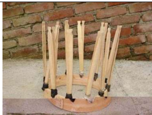
Figura 52. Amarre ya terminado de las patas al aro base de cahulote.
