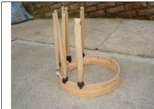
Figura 51. Forma en que se van amarrando las patas al aro de base con las tiras de cuero crudo.
