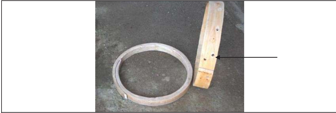
Figura 50. Vista de aros de cahulote donde se observa los orificios que se hecen para los amarres
