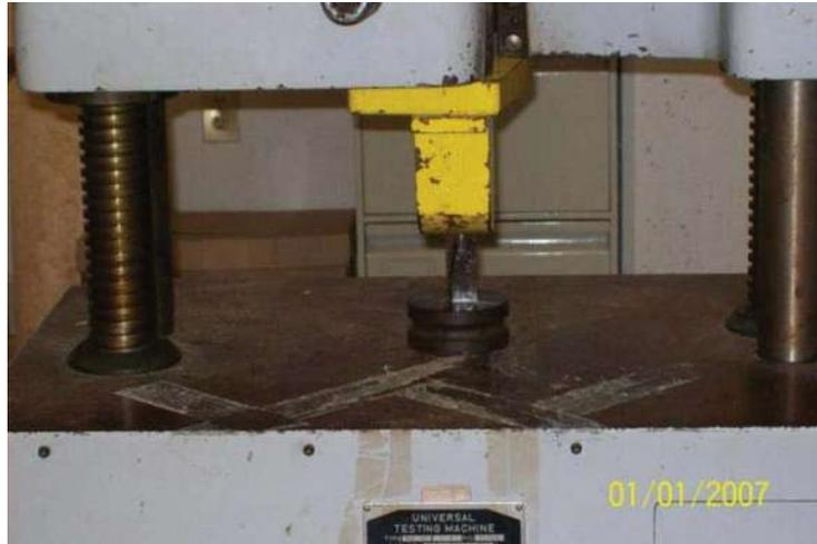
Figura 6.18 Prueba de compresión paralela del compuesto RP-Lir
