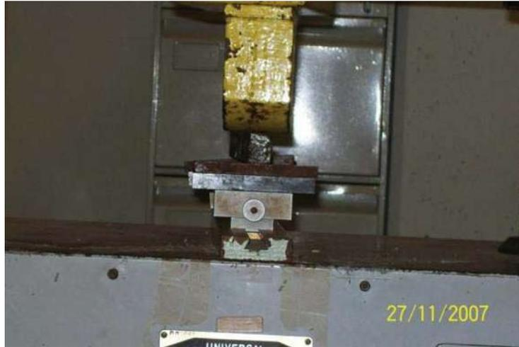
Figura 6.16 Prueba de flexión del compuesto RP-Lir
