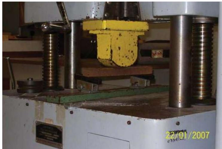
Figura 6.15 Pruebas de flexión de probetas de resina poliéster.
