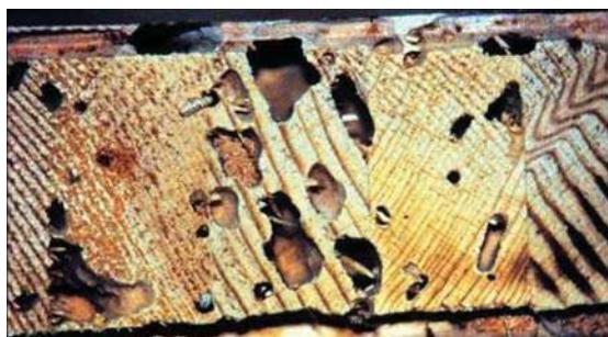
Figura 66. Daños por Cryptotermes brevis Walker Fuente: (Materson, 2007)
