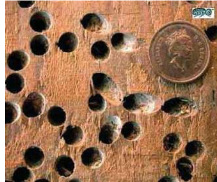
Figura 92. Daños por Bankia Fuente: (Keith, 2007)
