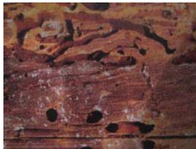
Figura 29 Daños de madera apilada por Calymmaderus oblongus (Gorham) Fuente: (Cibrián. et al. ,
