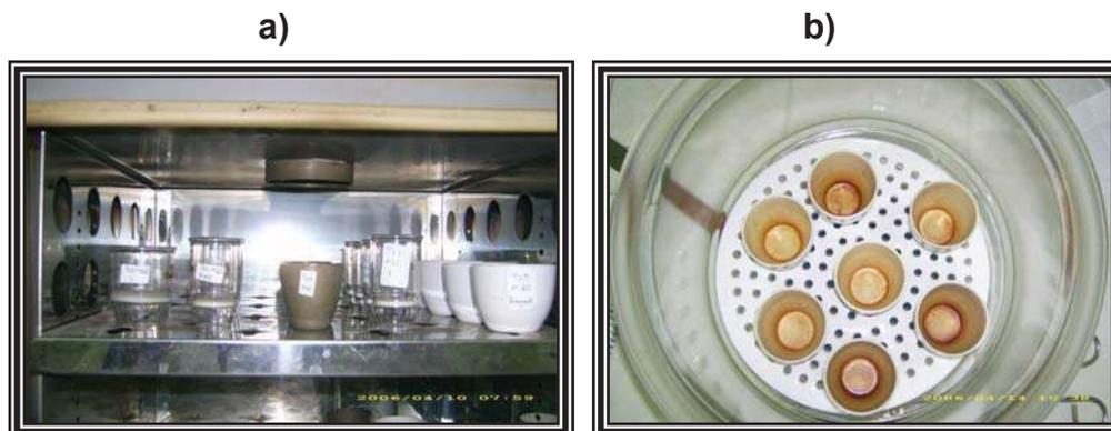
**Figura 12.** Determinación del extracto total, a) Secado, b) Extracto total
