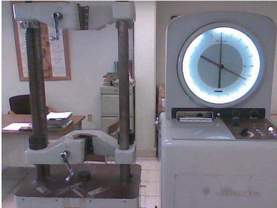
Figura 10 Maquina Universal Shimadzu, 10 toneladas de capacidad.
