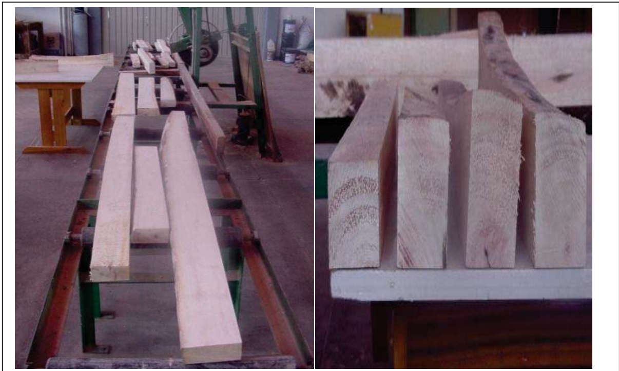
Figura 8 Listones aserrados, orientados radial y tangencialmente.
