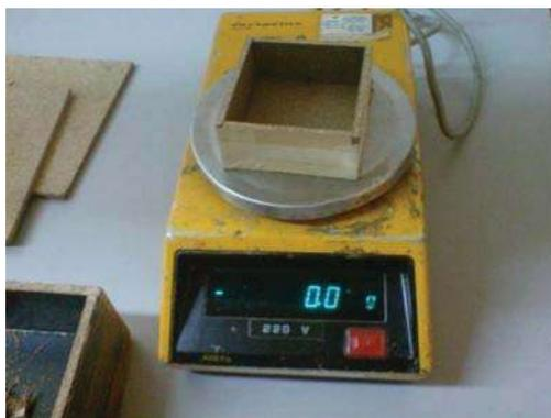
Fig. 4. Pesado de recipiente y tara de balanza para aserrín y virutas.
