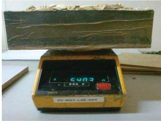
Fig. 5. Introducción y pesado de muestra para astillas.
