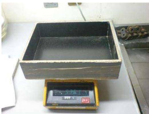
Fig. 3. Pesado de recipiente y tara de balanza para astillas.
