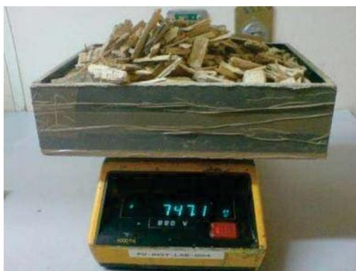
Fig. 9. Obtención de pesos para determinación del C.H. (astillas).
