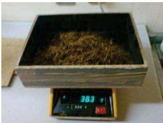
Fig. 8. Obtención de pesos para determinación del C.H. (virutas).
