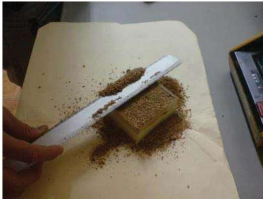
Fig. 6. Introducción y pesado de muestra para aserrín y virutas.
