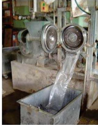
**Figura 10.** Desfibrador de Pulpa
