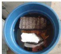
Figura 11. Probetas en inmersión con sales de boro después del baño caliente.
