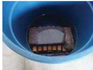
Figura 4. Probetas en inmersión con sales de boro por el método de inmersión simple.
