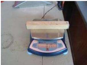
Figura 3. Pesado de probetas para la impregnación con sales de boro por el método de inmersión simple.
