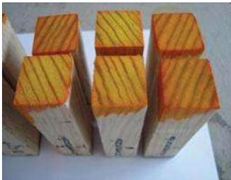
Figura 21. Probetas impregnadas con sales de boro por el método de inmersión simple. Aplicación de la solución 1.
