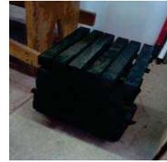
Figura 16. Probetas impregnadas con sales de cobre azol por el método baño caliente-frío y apiladas para secado.
