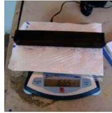
Figura 15. Pesado de probetas después del baño-frío impregnadas con sales de cobre azol.
