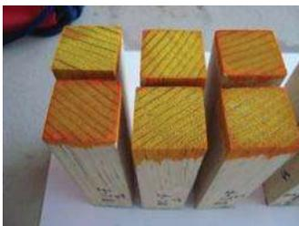
Figura 23. Probetas impregnadas con sales de boro por el método baño caliente-frío. Aplicación de la solución 1.
