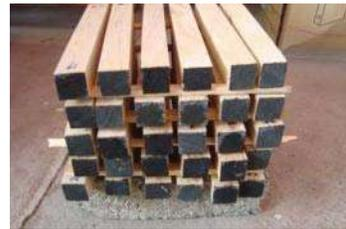
Figura 5. Probetas impregnadas con sales de boro por el método de inmersión simple y apiladas para secado.
