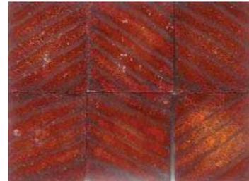
Figura 22. Probetas impregnadas con sales de boro por el método de inmersión simple. Aplicación de la solución 2.
