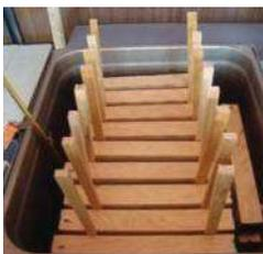
Figura 9. Apilado de probetas en el termobañero para la impregnación con sales de boro por el método baño caliente-frío.
