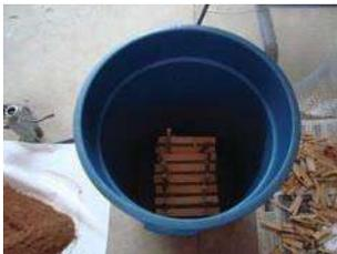
Figura 6. Apilado de probetas para inmersión con sales de cobre azul por el método de inmersión simple.
