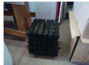
Figura 8. Probetas impregnadas con sales de cobre azul por el método de inmersión simple y apiladas para secado.
