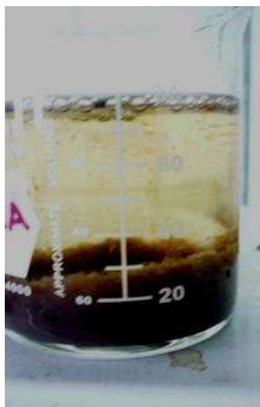
Ilustración 6.4. Lignina acetosolv precipitada, de la etapa 3.
