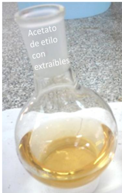
Ilustración 7.2. Extraíbles arrastrados por el acetato de etilo.
