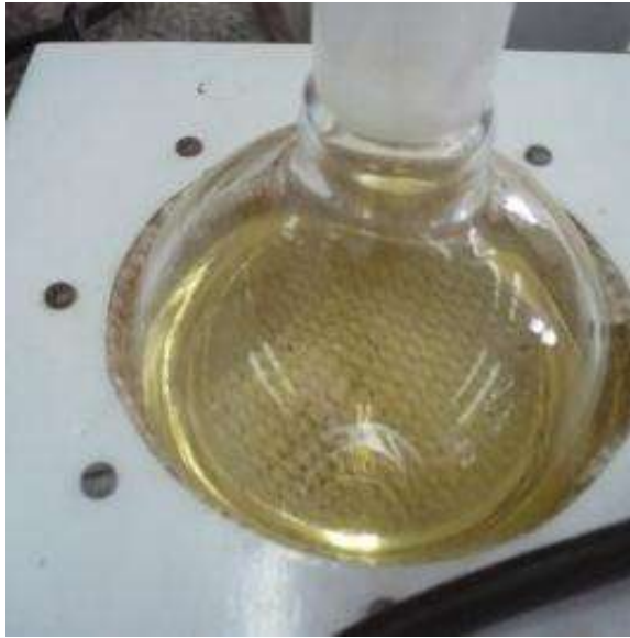
Ilustración 7.3. Licor Acetosolv, después de la digestión A.
