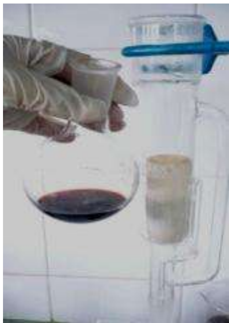
Ilustración 7.5. Licor Acetosolv, después de la digestión C.
