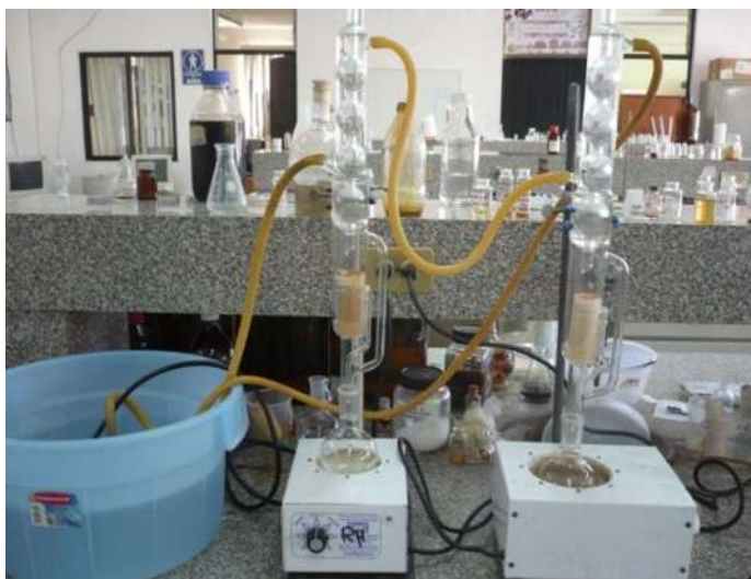
Ilustración 6.1. Montaje en serie de los equipos Soxhlet para la liberación de extraíbles.
