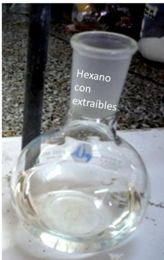
Ilustración 7.1. Extraíbles arrastrados por el hexano.
