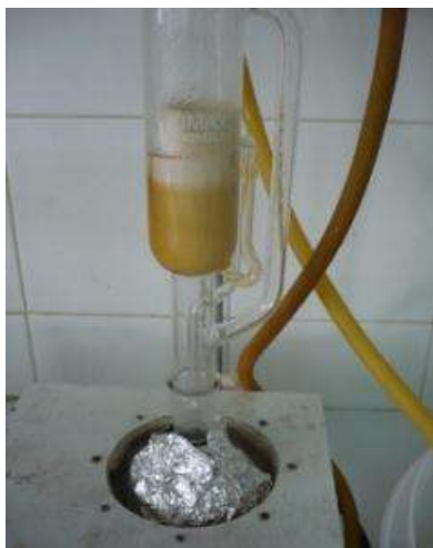
Ilustración 6.3. Representación de la digestión del proceso acetosolv en el equipo soxhlet.
