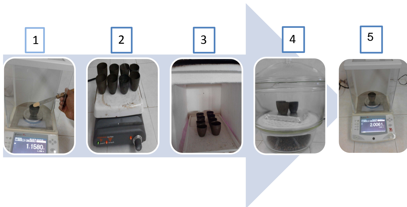
Figura 10. Diagrama determinación de porcentaje de cenizas. 1) Peso inicial de la muestra en crisoles de níquel, 2) Oxidación de la madera en placa de calentamiento 3) Obtención de cenizas en la mufla a 525 °C, 4) Cenizas en el desecador absorbiendo la humedad remanente presente en las muestra, 5) Peso de la cenizas o compuestos inorgánicos.
