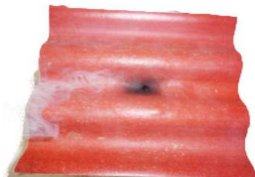
Fig. 6.20. Condiciones alcanzadas durante la prueba de conductividad térmica por medio de termopar.
