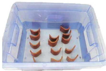
Fig. 6.8. Ensayos de hinchamiento del espesor y absorción de agua.
