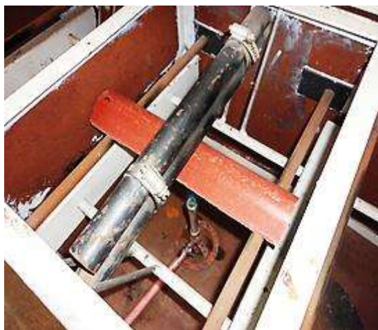
Fig. 6.21. Probeta soportando 2.5 kg bajo la acción del fuego.
