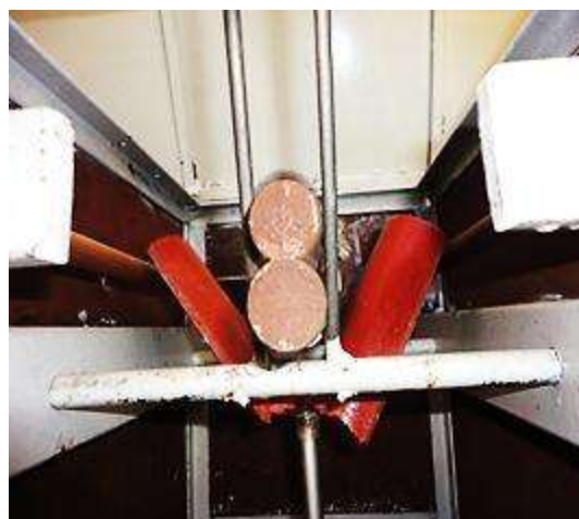
Fig. 6.22. Probeta vencida por el fuego y la carga.
