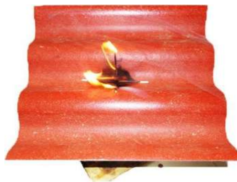
Fig. 6.18. Ensayo de conductividad térmica, cuando se alcanza la temperatura de ignición.
