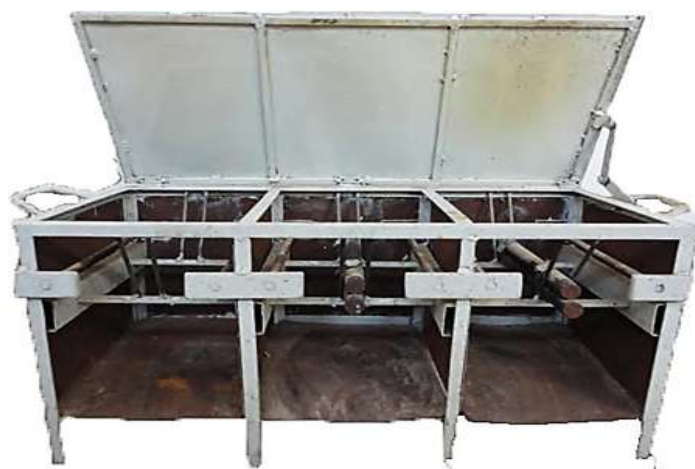
Fig. 6.16. Quemador múltiple para pruebas térmicas y de resistencia al fuego.
