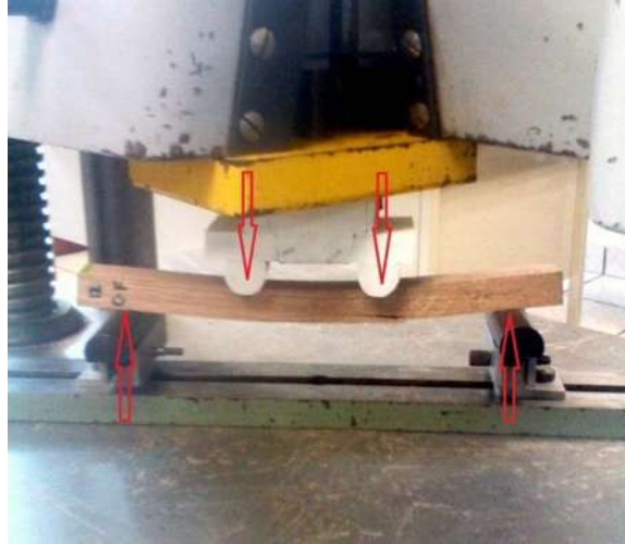
Figura 5.1. Caballete utilizado en la prueba de flexión estática.
