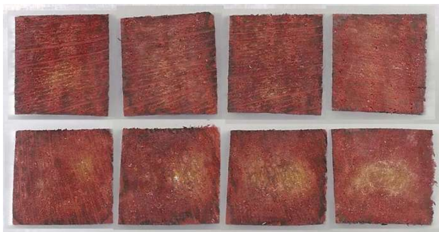
Figura 6.5. Penetración de las sales de boro por el método de baño caliente-frío.
