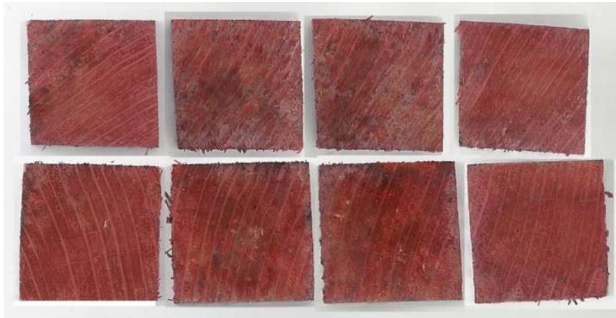
Figura 6.6. Penetración de las sales de boro por el proceso Bethell.
