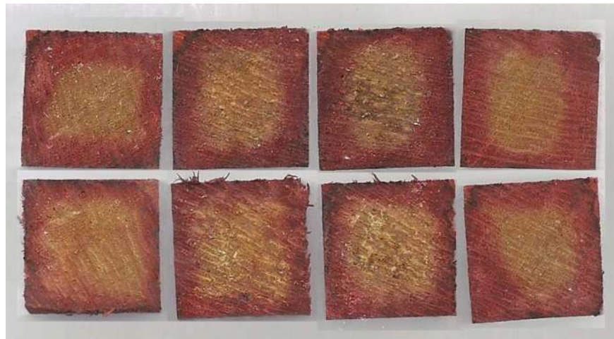
Figura 6.4. Penetración de las sales de boro con el método de inmersión.
