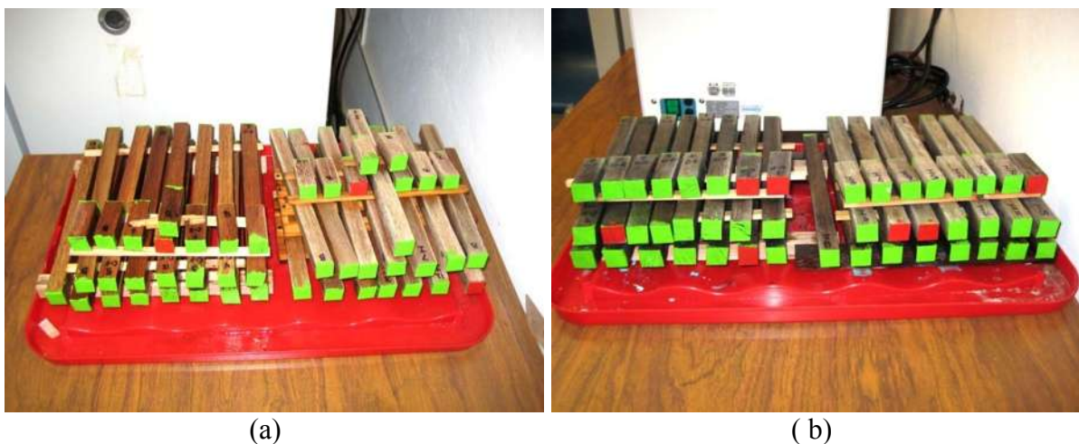
Figura 6.1. Probetas impregnadas con los preservantes: boro (a) y cobre azol (b).
