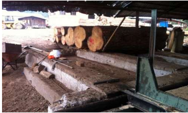
Figura 10. Rampa de aserrío
