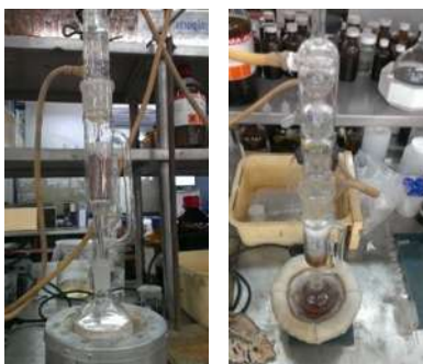
Fig. 26. Equipo Soxhlet para extracciones usado en la experimentación.
