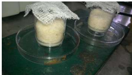
Fig. 29. Aspecto de la celulosa Cross y Bevan, posterior a la hidrólisis de la holocelulosa.
