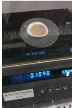
Fig. 31. En esta imagen se aprecia la lignina residual extraída de la holocelulosa.
