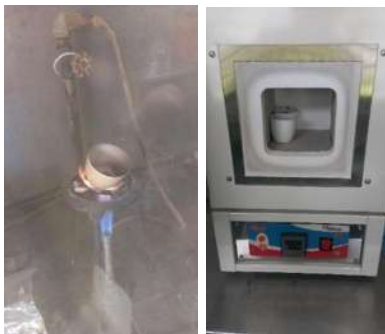
Fig. 25. Calcinación de la muestra con mechero y calcinación en mufla para la obtención del porcentaje de cenizas.
