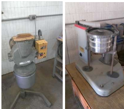
Fig. 23. Molino Retsch (izq.), clasificador Rotap (der.).
