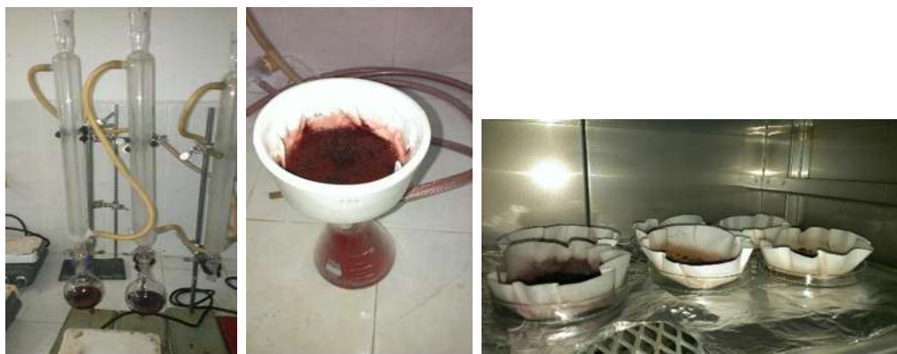
Fig. 35. Pasos de la prueba de Stiasny (reactividad de los taninos con formaldehído). En la imagen de la izquierda se muestra el reflujo, en el centro la filtración y a la derecha el secado.
