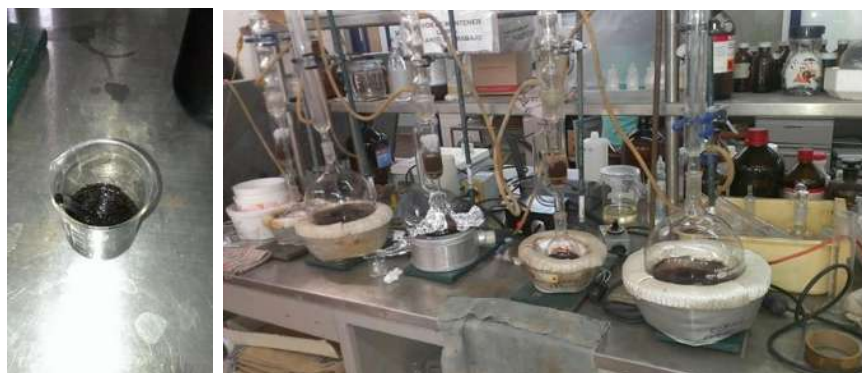
Fig. 30. Aislamiento de la lignina, en la imagen de la derecha se muestra la hidrólisis de los carbohidratos de la madera en “frío” y en la imagen de la derecha se distinguen los matraces balón (1L) donde se prosigue la digestión pero ya con el ácido sulfúrico diluido y aplicandocalor.
