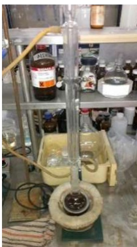
Fig. 27. Equipo para reflujo en la preparación de la madera para análisis químicos.
