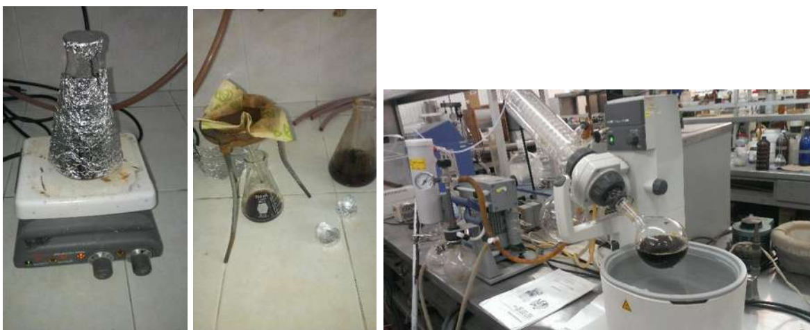
Fig. 34. Algunos pasos del procedimiento de extracción de los taninos condensables. A la izquierda se observa la maceración, en la imagen del centro se nota el procedimiento de filtración y a la derecha se distingue la concentración del licor.
