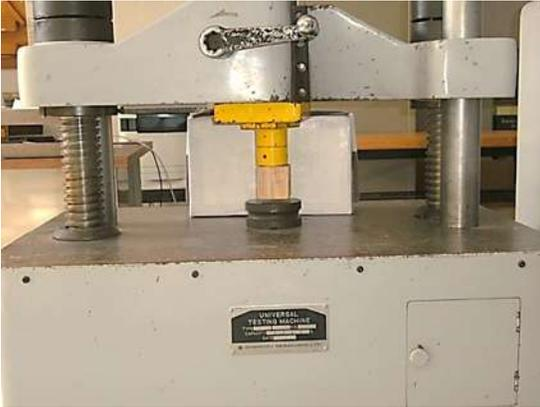
Figura 4.8 Ensayo de Dureza Janka
