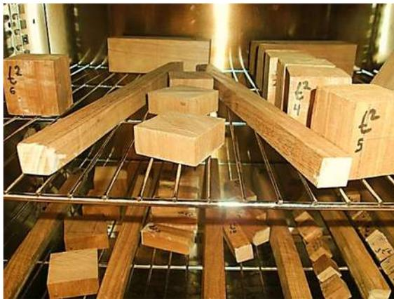
Figura 4.13 Probetas expuestas a alta temperatura
