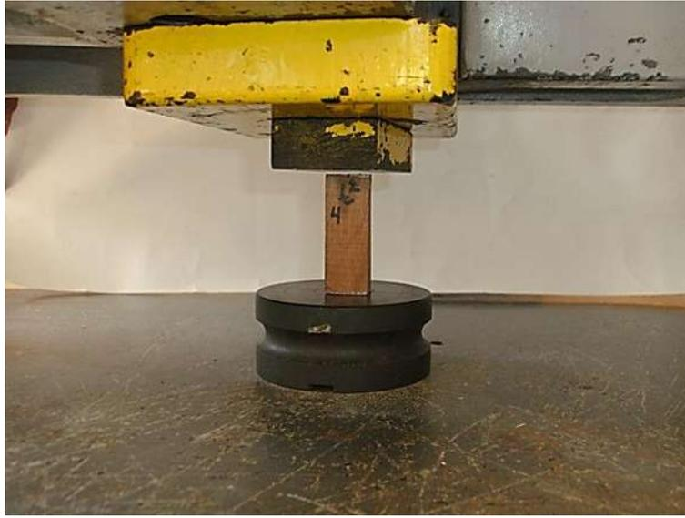
Figura 4.11 Ensayo de resistencia a compresión paralela
