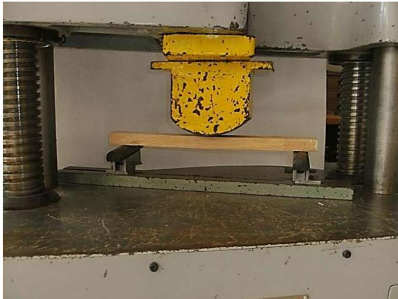
Figura 4.12 Ensayo de resistencia a flexión estática
