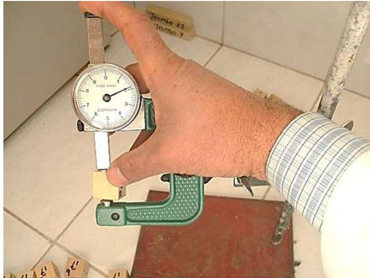
Figura 4.7 Medición de las probetas de hinchamiento-contracción
