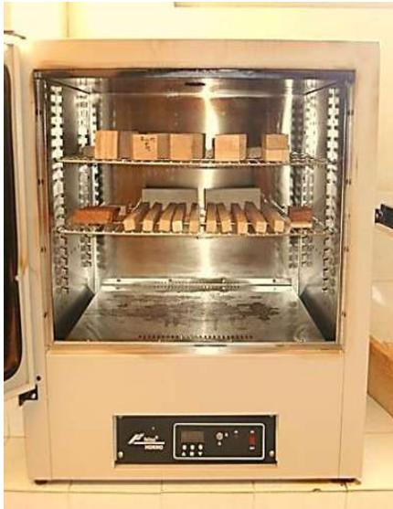
Figura 4.2 Horno digital para deshidratación y tratamiento térmico
