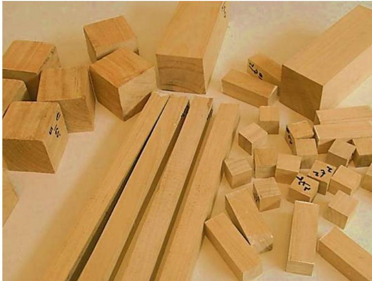
Figura 4.1 Probetas de ensayo de la madera de *Vitex gaumeri*
