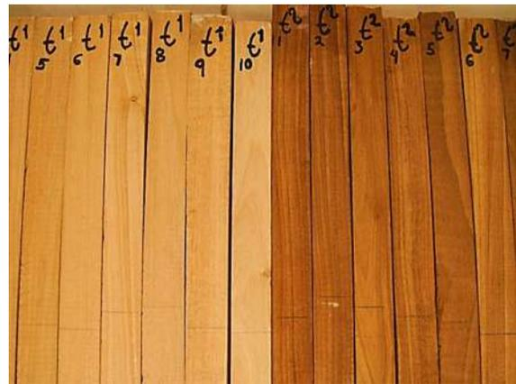
Figura 4.14 Probetas con termo-tratamiento
