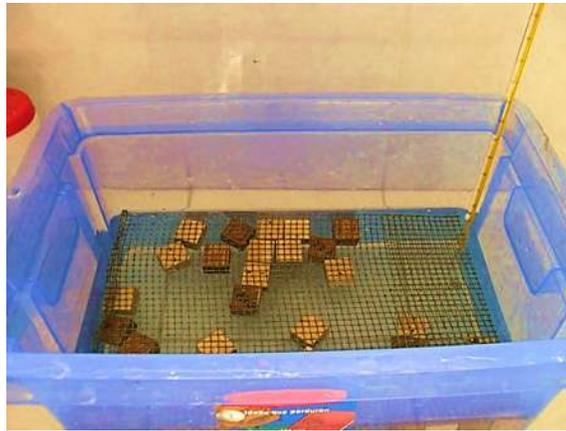
Figura 4.6 Probetas inmersas para hinchamiento
