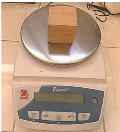
Figura 4.5 Determinación del peso de las probetas
