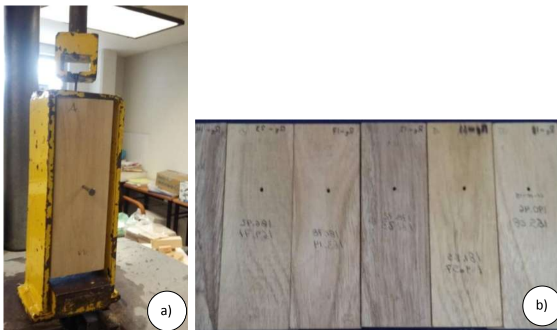
Figura 14. a) Ensayo de extracción de clavos; b) Probetas ensayadas
