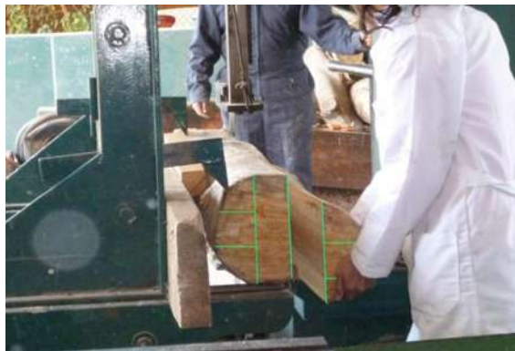
Figura 7. Obtención de probetas para pruebas físico- mecánicas
