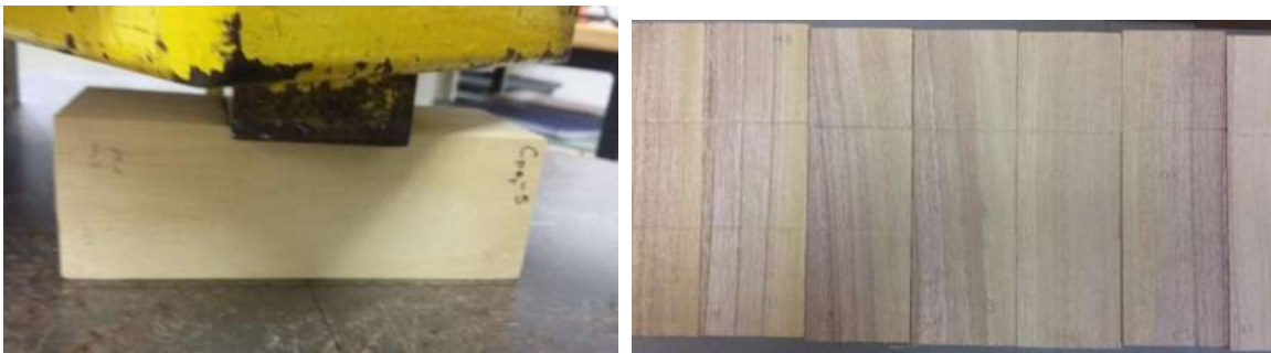
Figura 11. a) Ensayo de compresión perpendicular a la fibra; b) Probetas ensayadas
