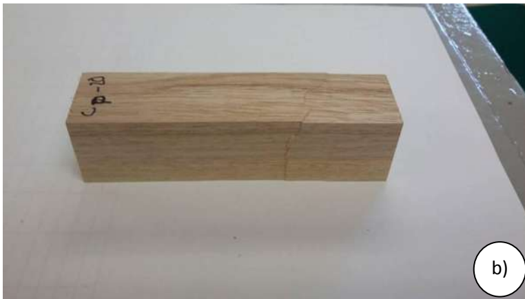
Figura 10. a) Ensayo de compresión paralela a la fibra; b) Probeta ensayada
