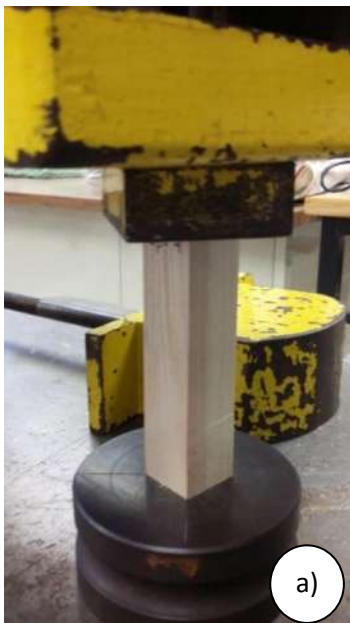
Figura 10. a) Ensayo de compresión paralela a la fibra; b) Probeta ensayada
